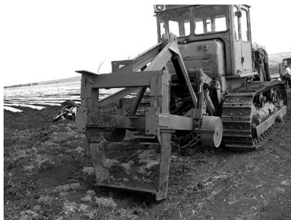
Рис. 2.3.2. Скоба для проведения полосового (ленточного) плантажа без оборота пласта
