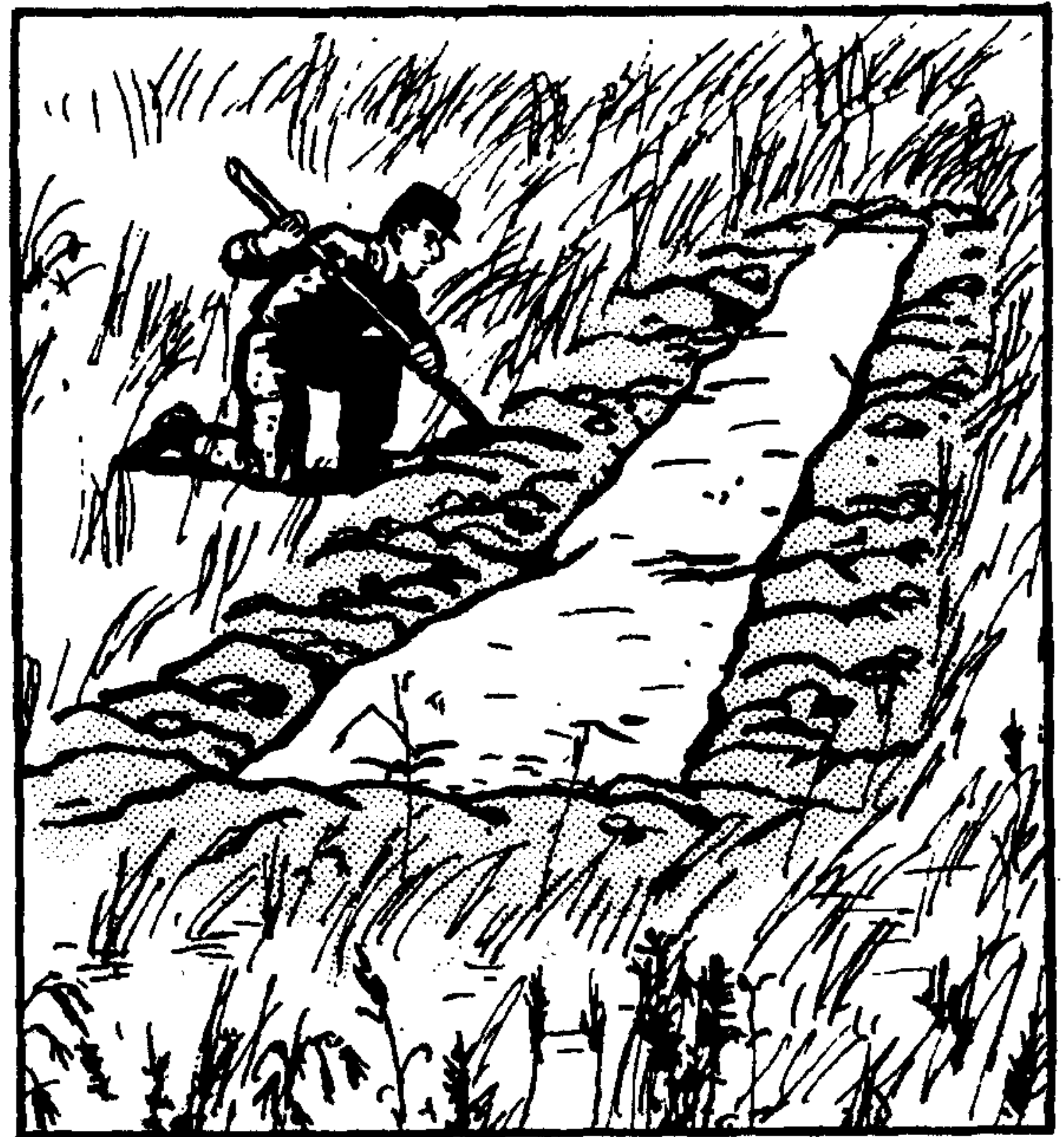
Рис. 292. Оборудование сигнального знака путем снятия верхнего слоя почвы (дерна).
