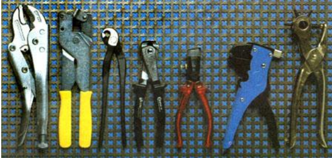
Рис. 2. Комплект специальных клещей (слева направо): зажимные щипцы, клещи для работ с плиткой, дыропробивные клещи для плитки, кусачки, клещи для удаления изоляции и дыропробивные клещи-револьвер.
