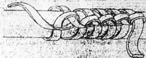
Bild 116 Flechtvorgang mit Lodestienen
