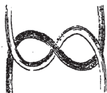
Рис. 119-й. Простой узелъ, которымъ бѣлая и темная нитки рис. 117-го и 118-го связываются надъ краемъ первой тетради (см. текстъ).
