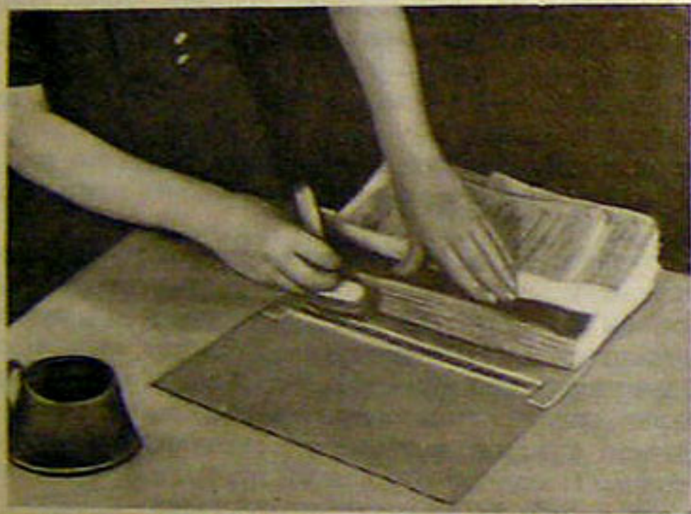
Рис. 81. Вставка блока в переплетную крышку
