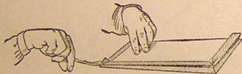
Рис. 96. Обрезка складок-ушей на углах карманов
