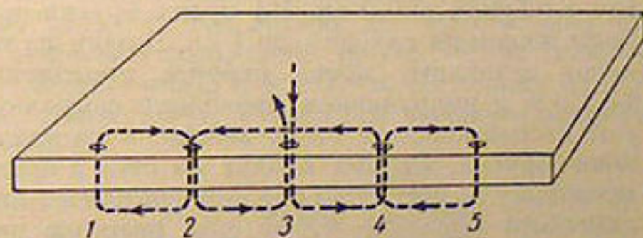
Рис. 77. Ход стежков при сшивке блока «виракол»
