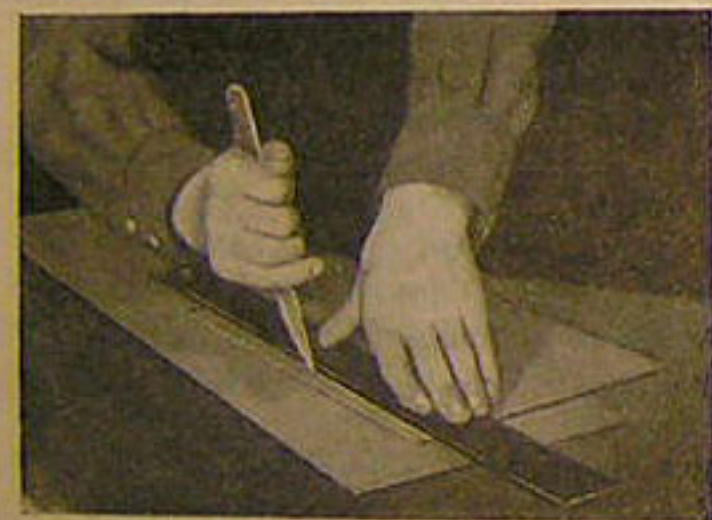
Рис. 25. Разрезка толстого картона ножом
