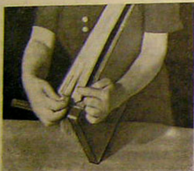
Рис. 83. Выравнивание корешка блока картонными прокладками
