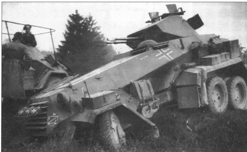
Бронеавтомобиль Sd.Kfz.231(6-Rad). Франция, 1940 год. На жалюзи радиатора укреплены дымовые шашки
