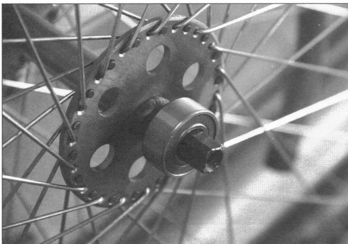
Подшипники колеса зажимаются в перьях вилки
