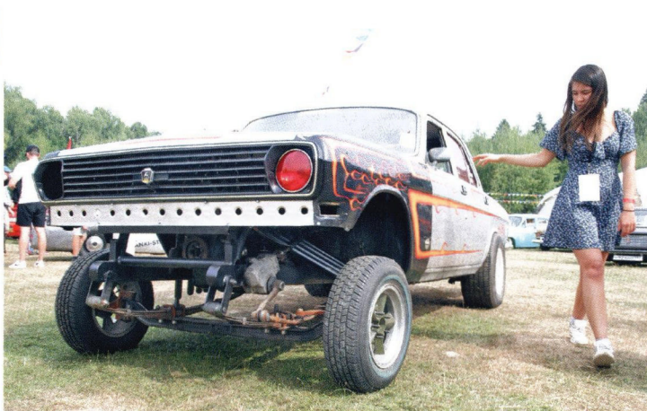
А это ГАЗ-24-10 на самодельном рамном шасси с пневмоподвеской и мотором ГАЗ-66
