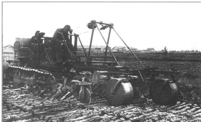
ТГ-2 с машиной для изготовления торфяных кирпичей
