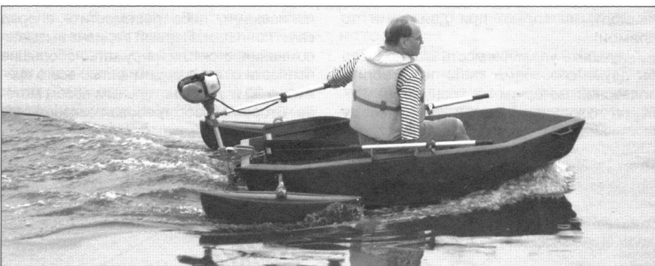
На ходу поплавки выполняют свои функции, не создавая большого сопротивления. Скорость 7 км/ч
