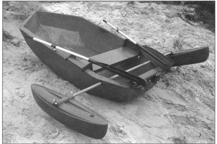
По результатам первых тестов поплавки передвинуты вперед. Ширина лодки с поплавками составляет 2000 мм
