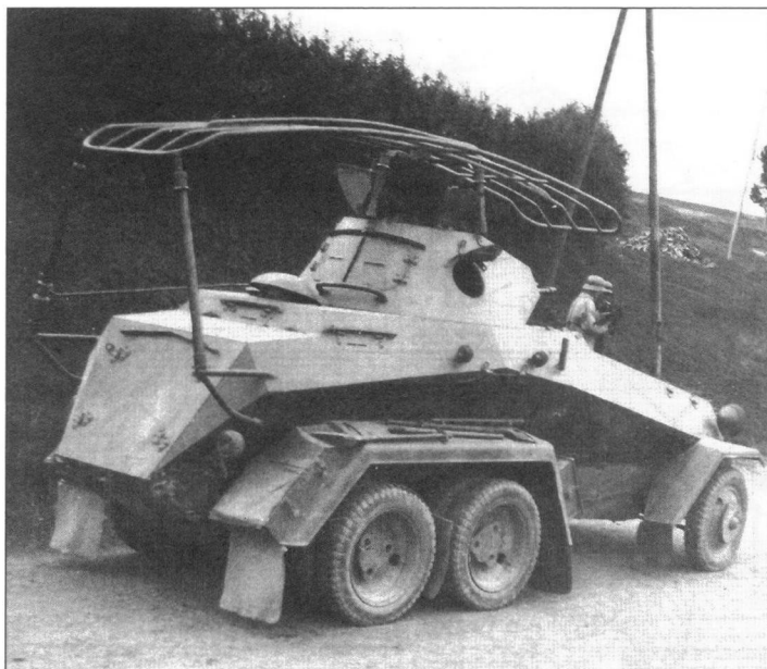
Бронеавтомобиль Sd.Kfz.232(6-Rad). Хорошо видны все узлы крепления антенны
