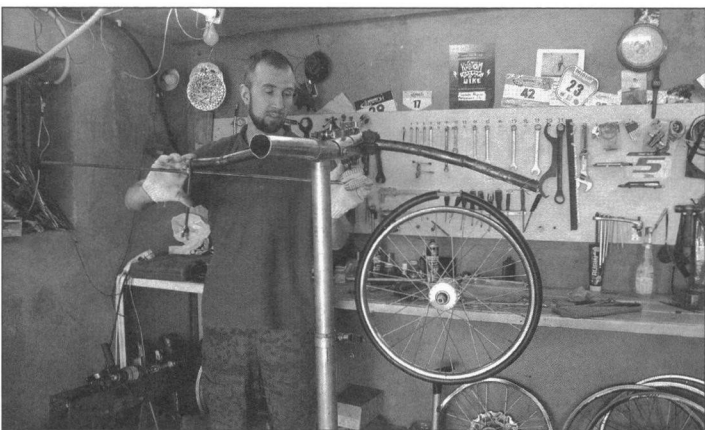
Натягивание проволоки в шине производится при помощи самодельной оснастки
