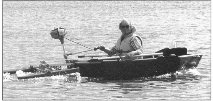
Установленные за кормой поплавки резко улучшили устойчивость лодки во всех трех плоскостях, в том числе и в горизонтальной, так что свернуть с прямого курса стало очень трудно
