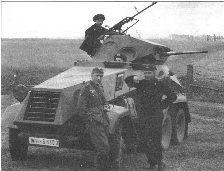
Броневые автомобили на шасси Magirus легко отличить по прямоугольной секции жалюзи радиатора. У броневиков Daimler-Benz и Bussing-NAG она имела форму трапеции. Установка зенитного пулемета появилась в 1935 году
