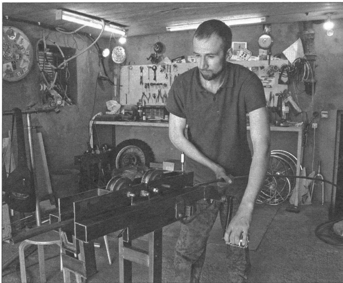
Самодельный вальцовочный станок для формирования обода
