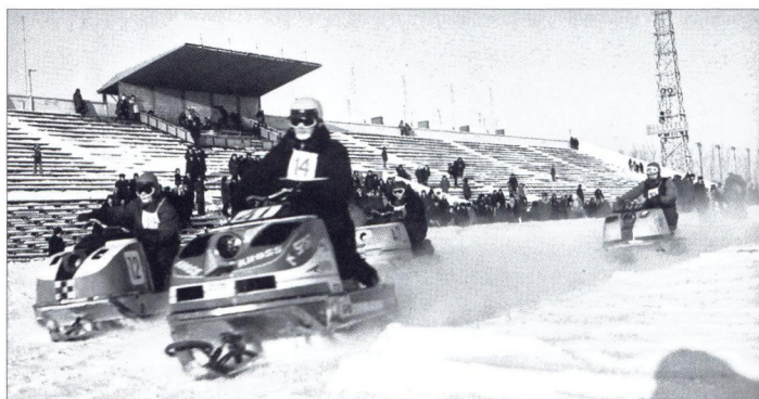
Так выглядел прототип «Бурана». На нем применялся двигатель от мотоцикла «Иж», вариатора не было
