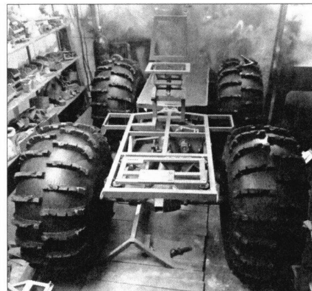
Идет сборка вездехода: полурамы поставлены на колеса, установлены подрамник двигателя и каркас кресла водителя
