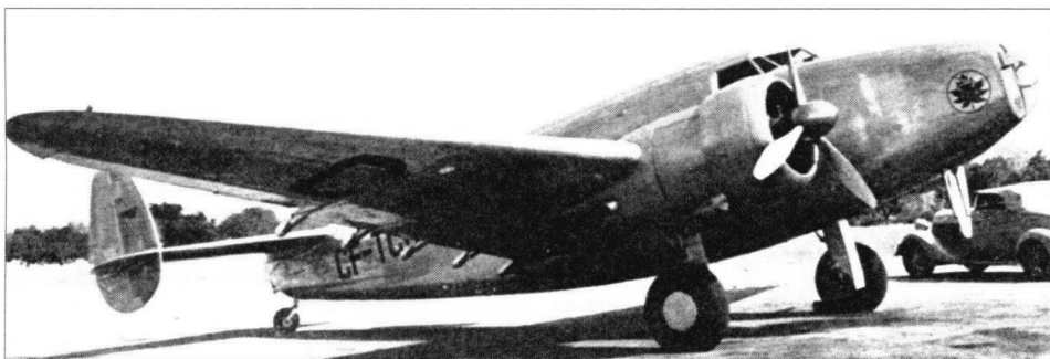
Самолет L-14H компании «Транс Канада». Обратите внимание на интересную доработку – размещение рамки радиоконюса под прозрачным обтекателем в носу фюзеляжа
