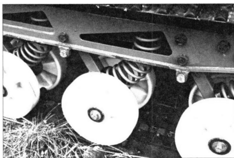
Опорные ролики гусениц имеют пружинную подвеску
