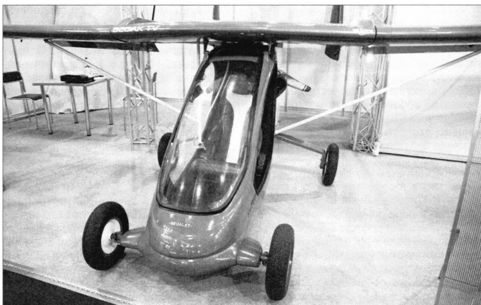
Композитное крыло крепится к кабине на четырех болтах
