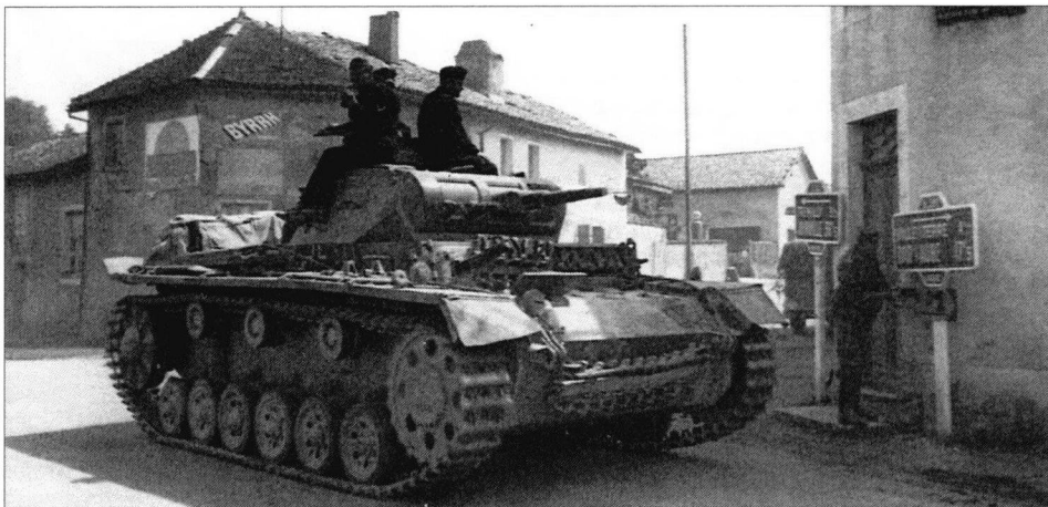
Уже во время Французской кампании 1940 года немцы начали использовать запасные гусеницы для усиления бронезащиты своих танков, в данном случае – Pz.III Ausf.E
