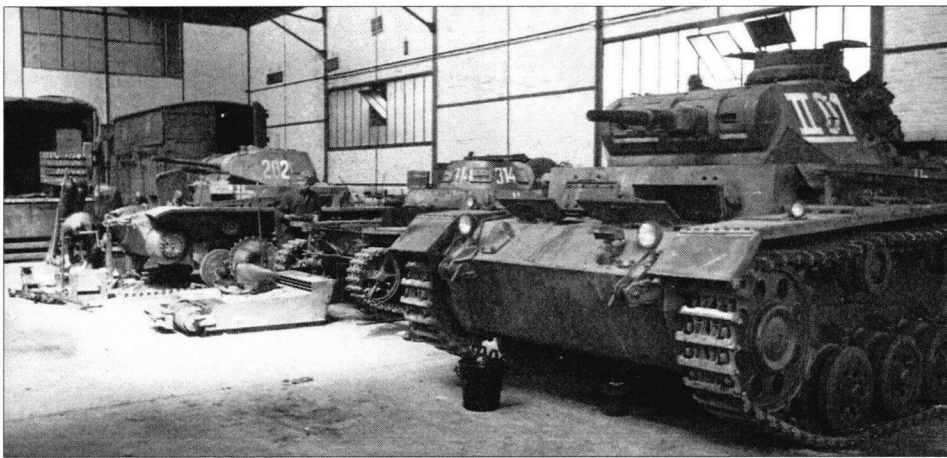
Ремонт танков после Французской кампании. На переднем плане – Pz.III Ausf.E
