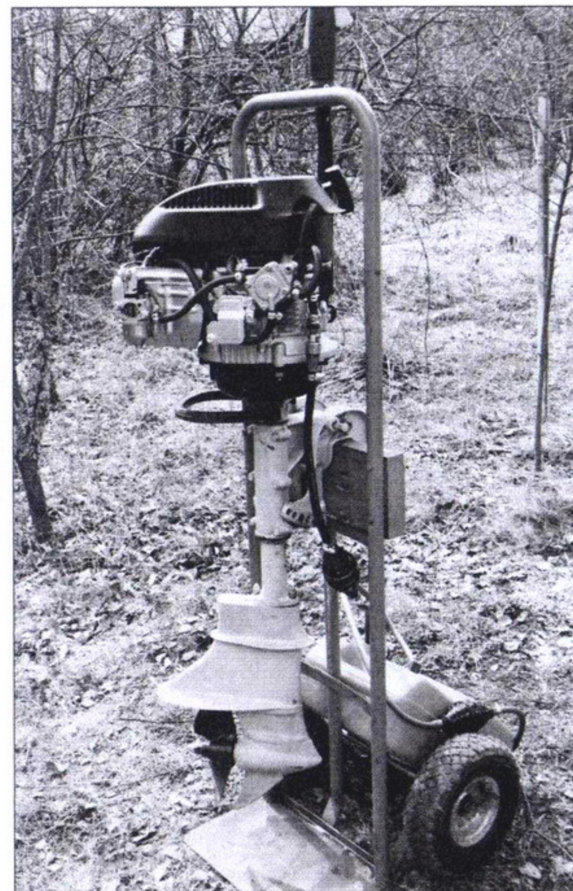
Специально собранный для тримарана гибридный лодочный мотор мощностью 7 л.с.
