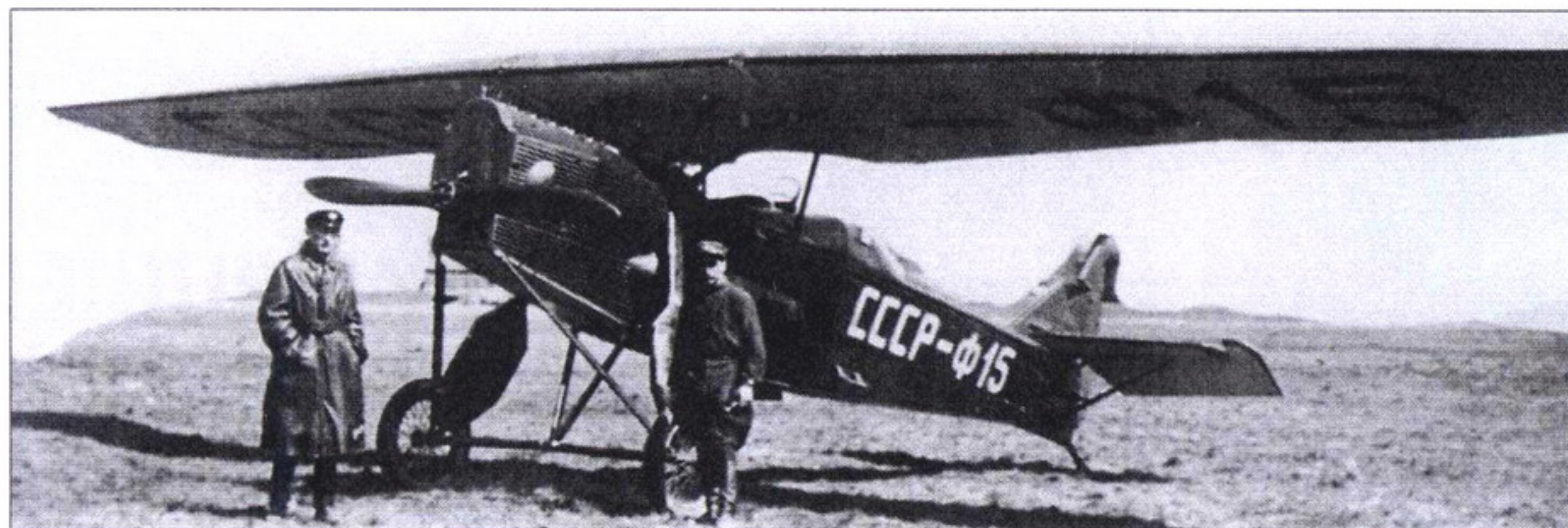
Разоруженный Ю-21, использовавшийся для картографической аэрофотосъемки
