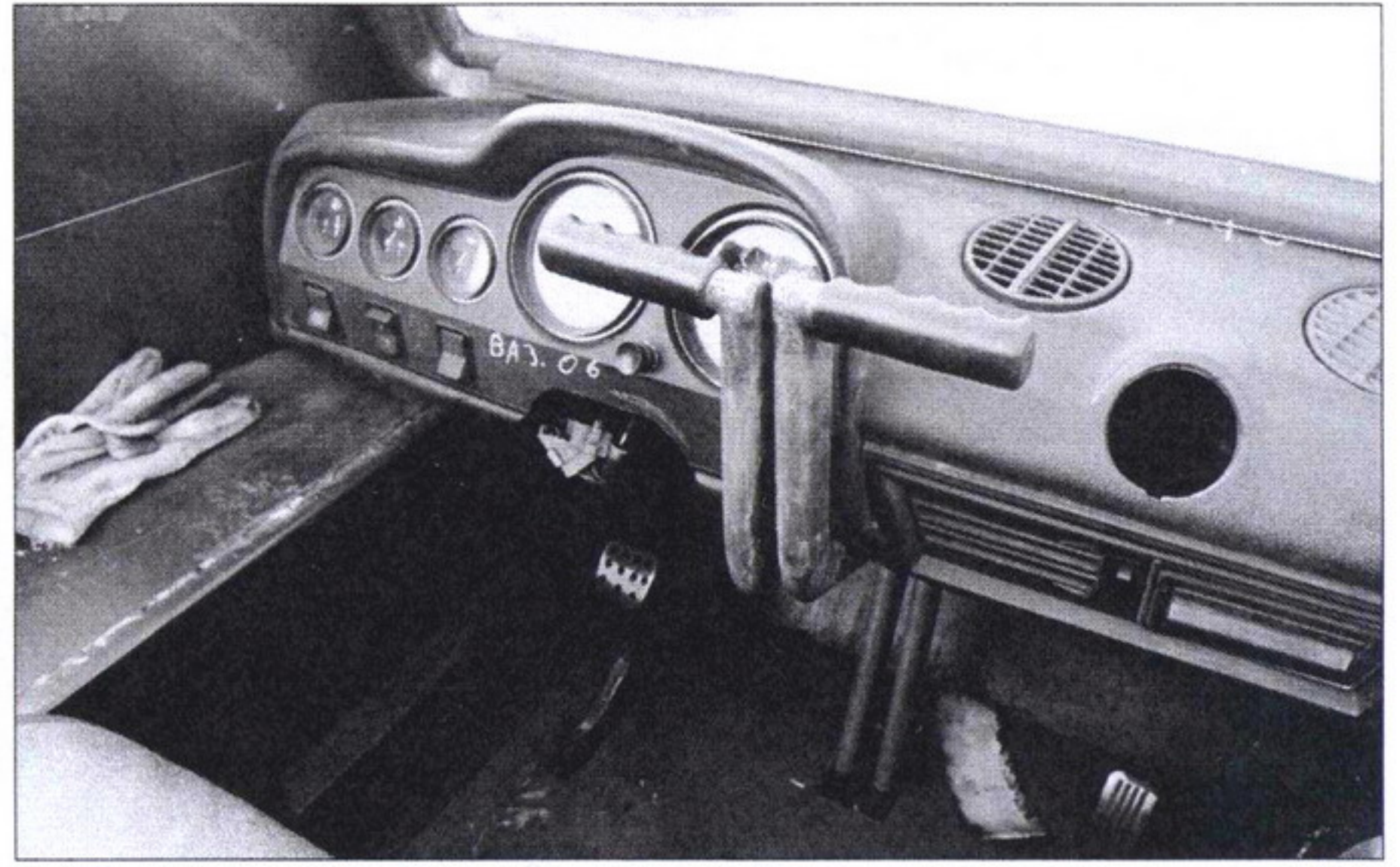
Рычаги управления на гусеничной машине – распространенное решение
