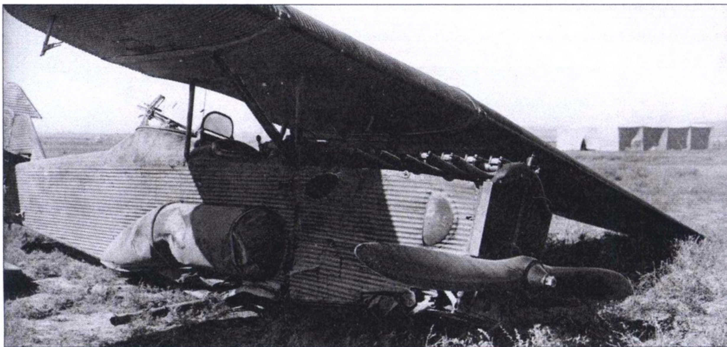
Авария Ю-21 на посадке из-за отказа мотора, 35-й авиаотряд, Троицк, летчик М.Н. Юсуф
