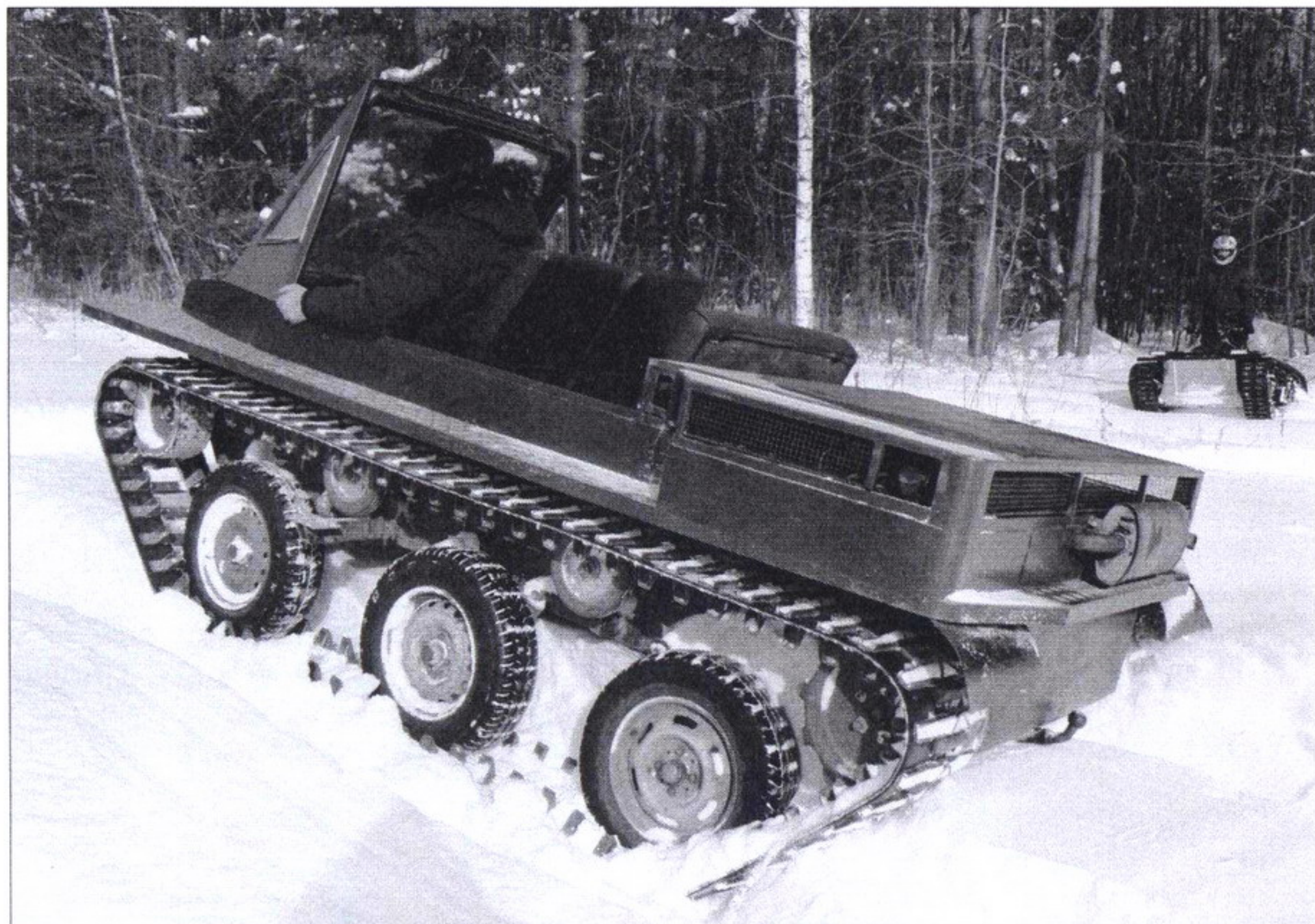
Два передних опорных колеса подрессорены, заднее установлено жестко
