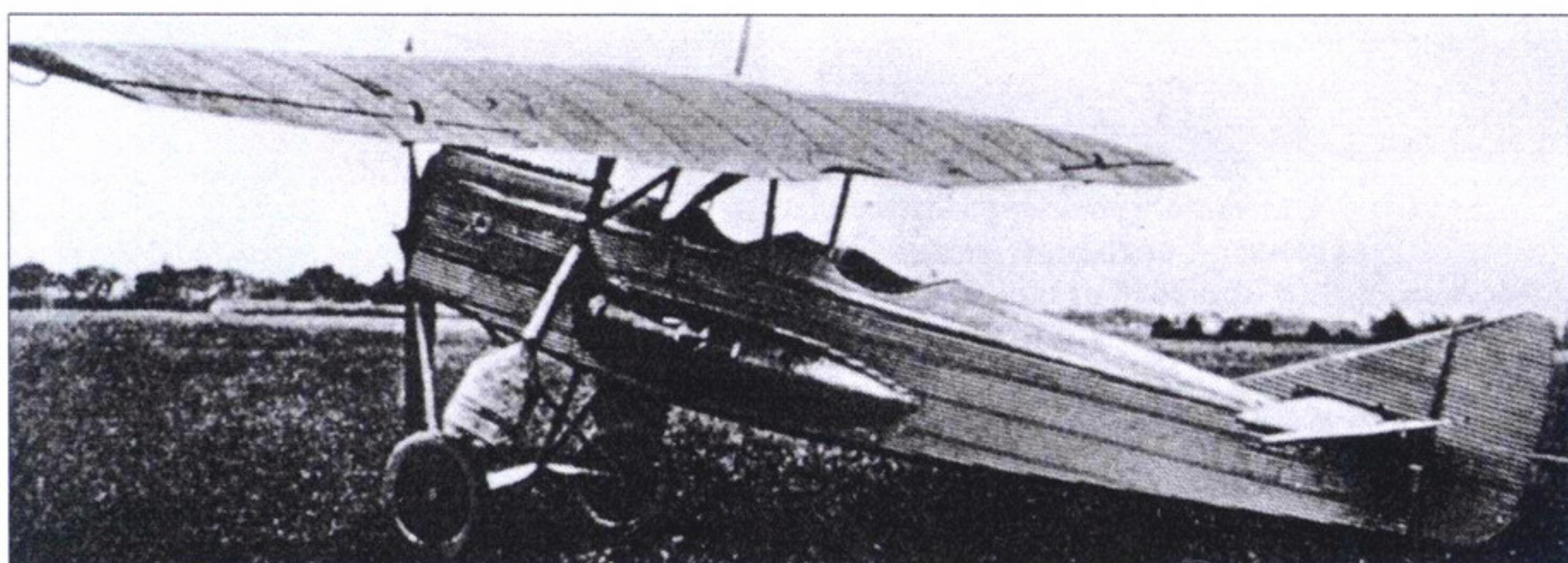
Опытный самолет Юнкерс Т21; вооружение на нем полностью отсутствует
