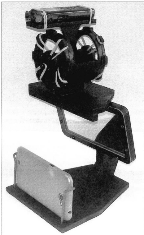
Ассистент готов к работе: объектив смартфона направлен на объект съемки, ее процесс контролируется по изображению в зеркале монитора. Сверху установлен диктофон, необходимый для качественной записи звука
