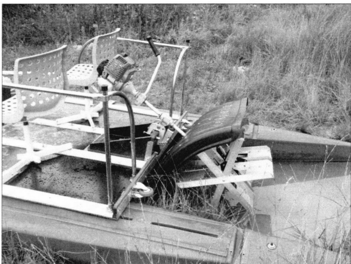
Установлен колесный подвесной мотор «Северяга» с четырехтактным двигателем Lifan 139F мощностью 1,5 л.с.
