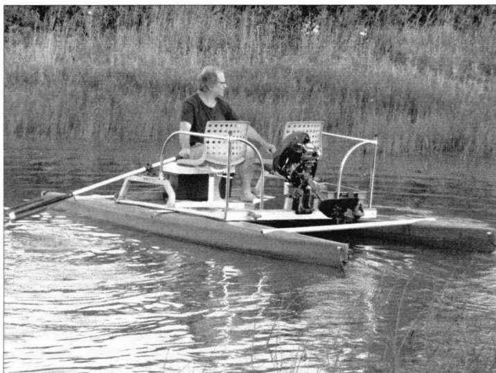
Катамаран с «байдарочными» обводами поплавков очень легок на веслах, причем грести одинаково удобно как вперед, так и назад
