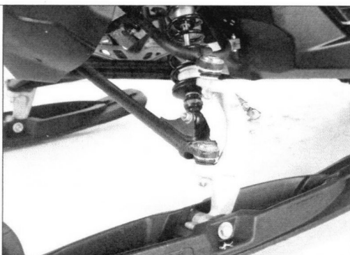
Передняя подвеска выполнена на продольных рычагах
