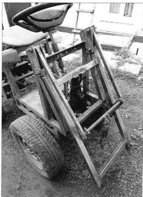
Навесное оборудование с гидравлическим приводом позволило расширить область применения трактора
