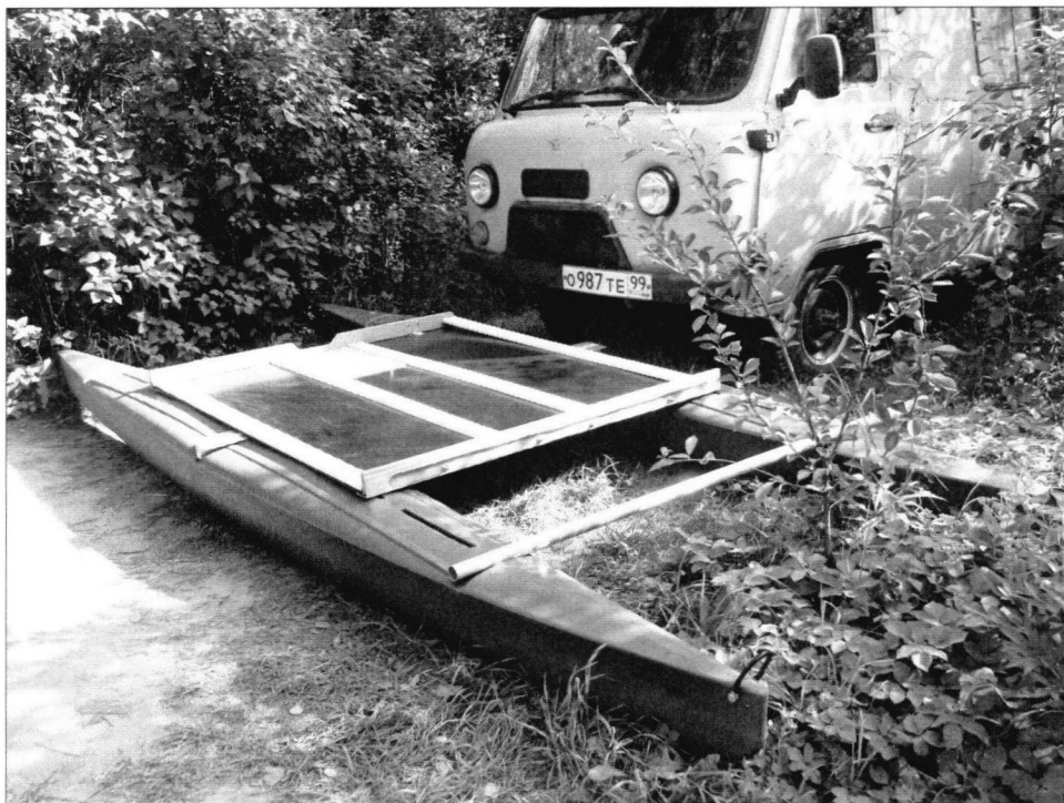
Начало сборки катамарана. Первая «примерка» поплавков и мостика
