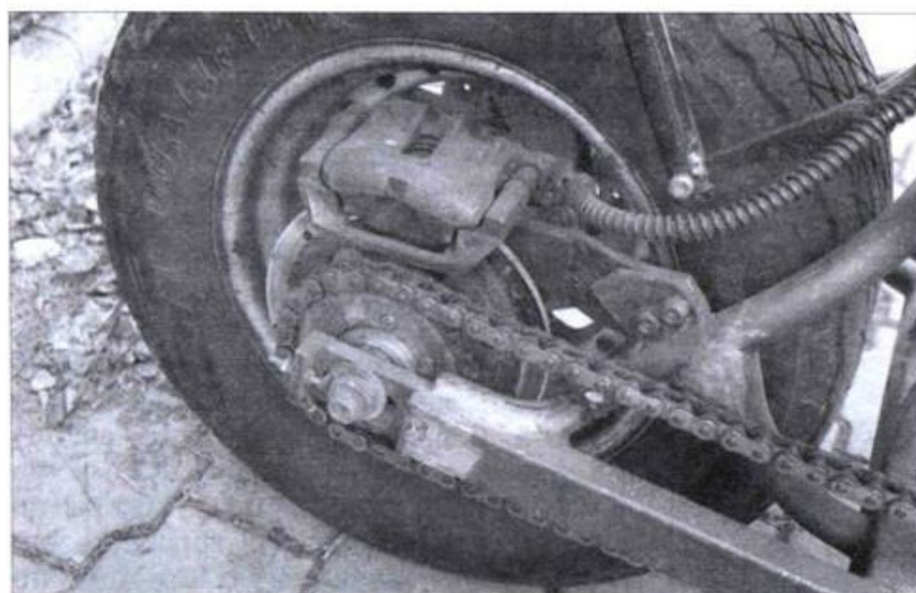
Мотоцикл оборудован дисковыми тормозами, но плавное замедление правильнее производить, включив режим рекуперации электроэнергии
