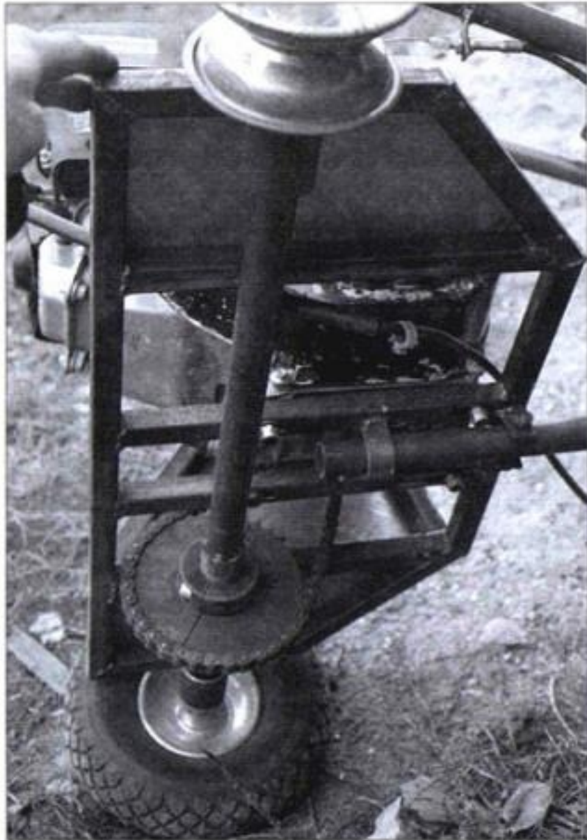
Ось колес вращается в подшипниках скольжения с полипропиленовыми втулками
