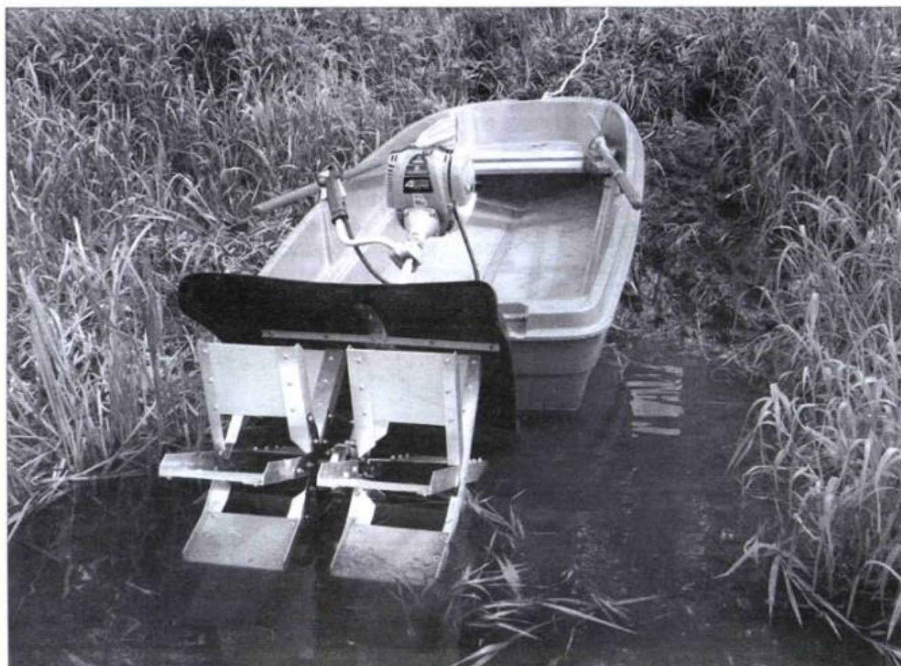
Колесный подвесной мотор установлен на лодку
