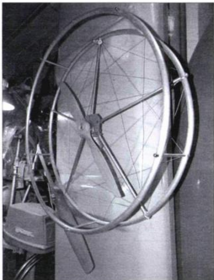
Редуктор аэродвигателя с пропеллером и ограждением. Ниже виден «тот самый» винт противоположного вращения для двигателя от бензопилы «Дружба»
