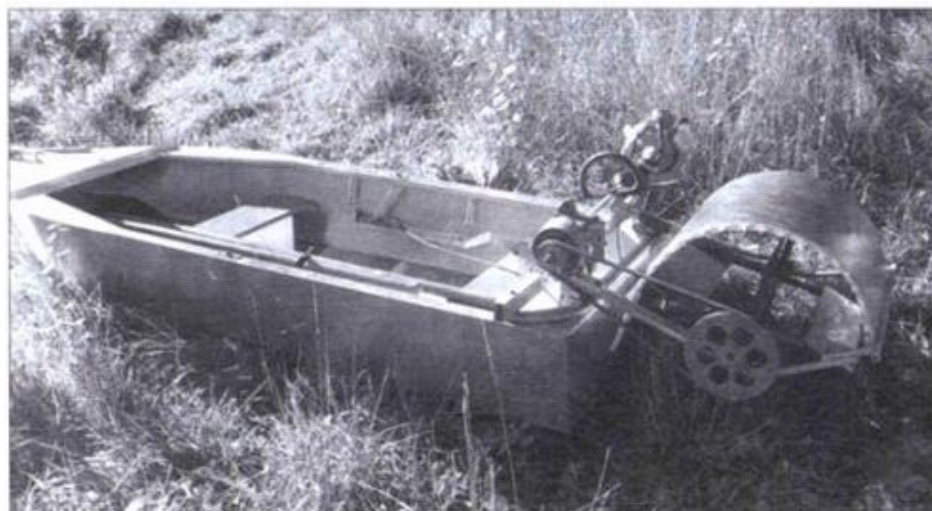
Самодельная конструкция из мотокосы с цепным приводом. Руль находится в носу лодки
