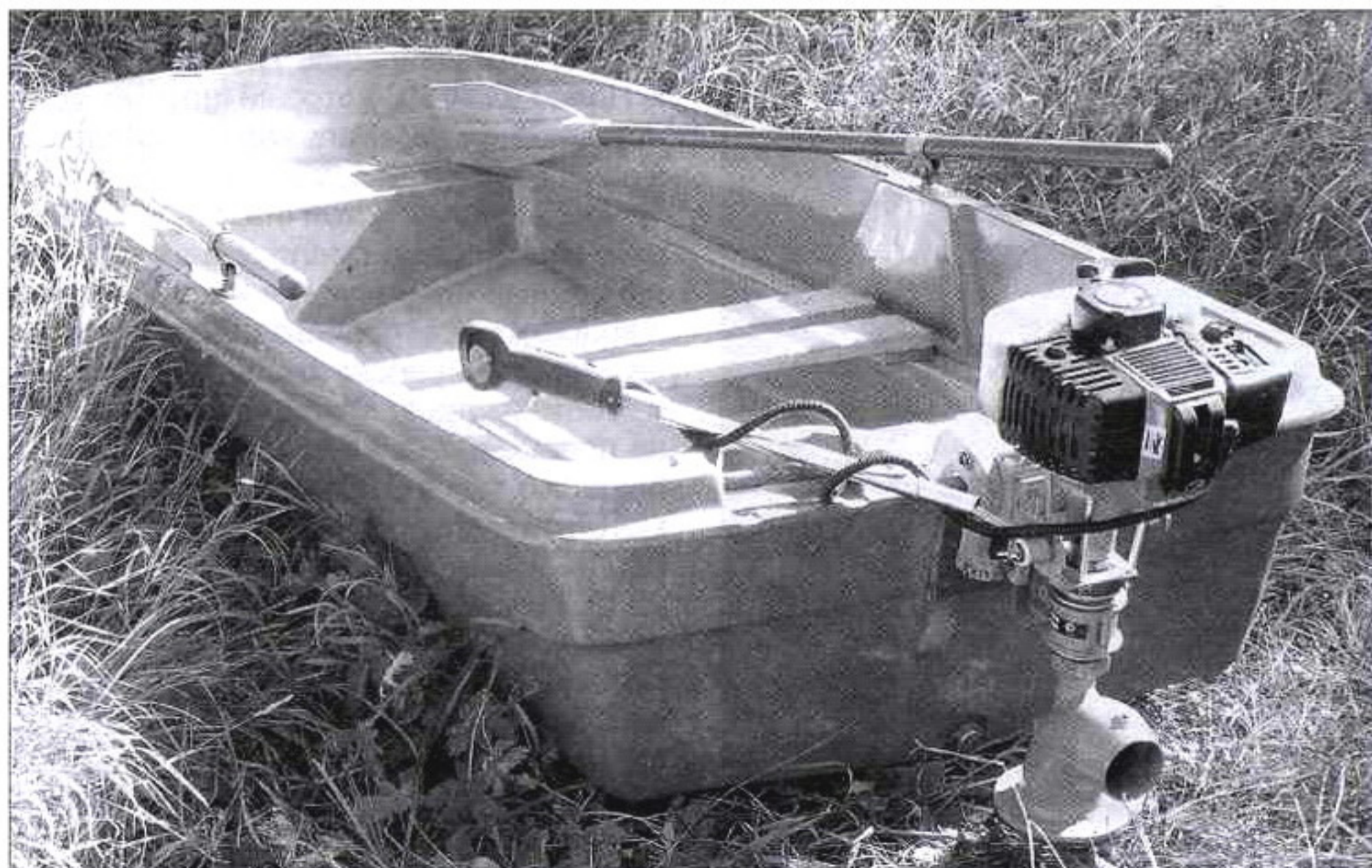
Рабочее положение водомета. Ватерлиния должна проходить по центру сопла
