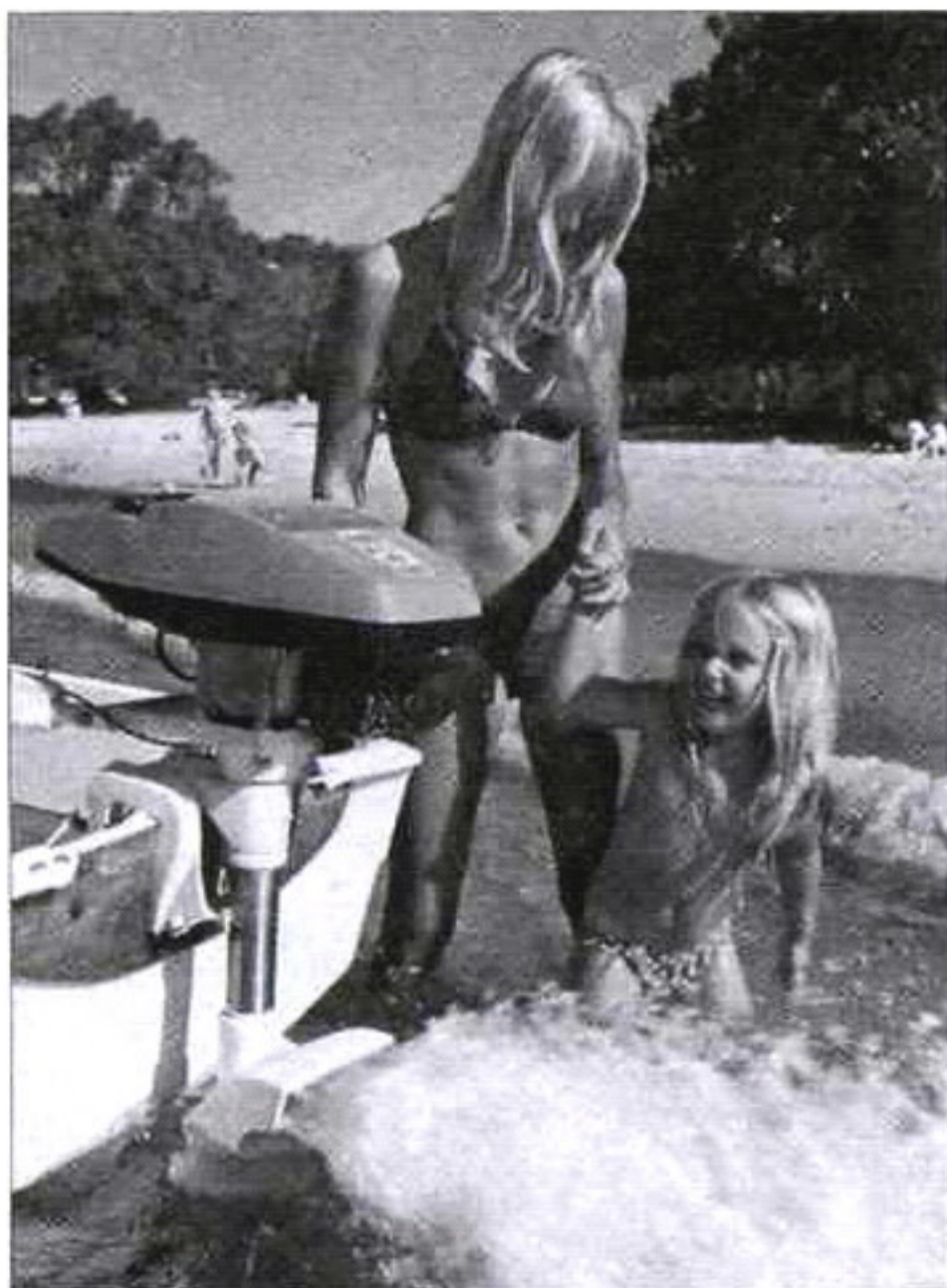
Первый прототип «Микроши», 1971 г. Самодельный лодочный мотор Н.С. Иванова для байдарки с двигателем Д-5 и осевым водометом с рабочим колесом диаметром 83 мм
