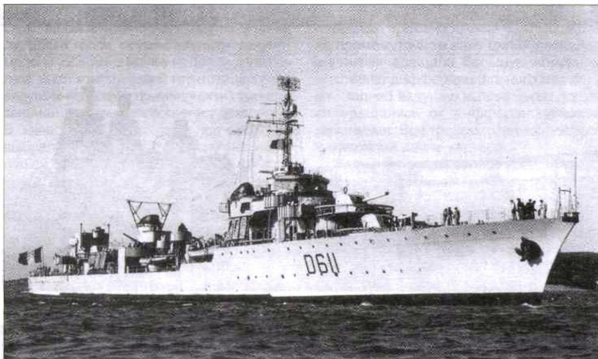
«Ле Террибль» после модернизации, оснащенный радиолокаторами и усиленным зенитным вооружением
