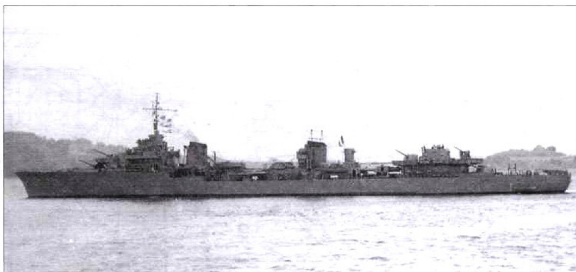
«Ле Триумфан» в период службы в составе ВМС «Свободной Франции». Хорошо видна 102-мм зенитная пушка, установленная на месте орудия главного калибра № 4
