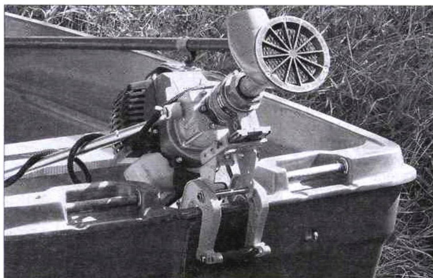
«Микроша» в откинутом положении для чистки входной решетки. В отличие от заводского варианта здесь установлена дополнительная решетка
