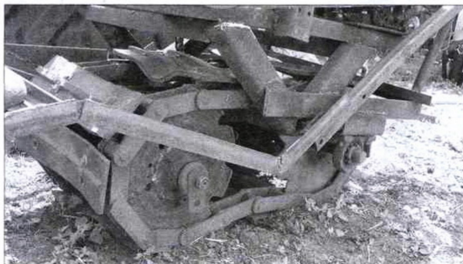
Гусеничная тележка с качающимся узлом и резиновыми траками
