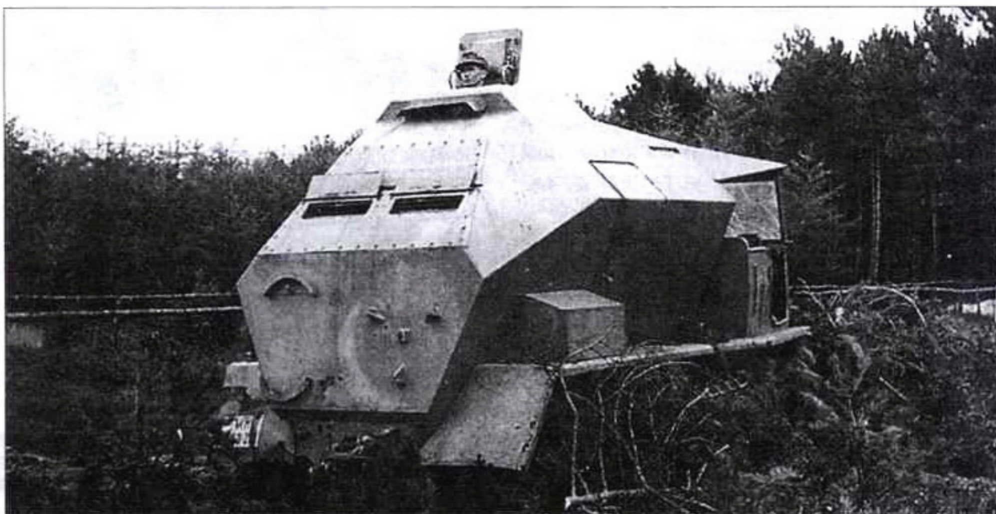
Бронированный пункт управления батареей А-4 защищал командиров в случае взрыва ракеты на старте
