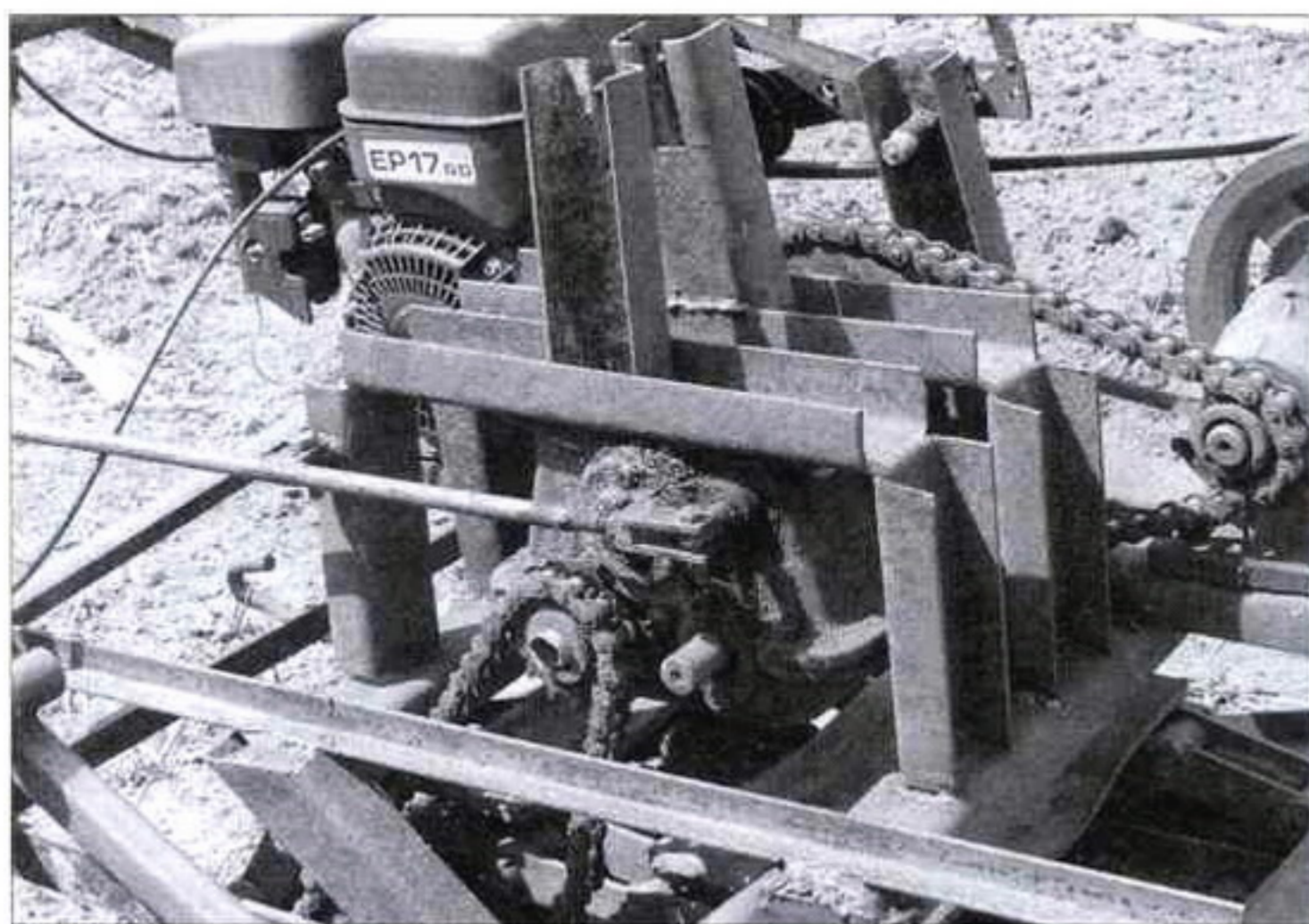
Реверсивный редуктор с цепной передачей на ведущую шестерню гусеничной тележки и рычаг включения заднего хода
