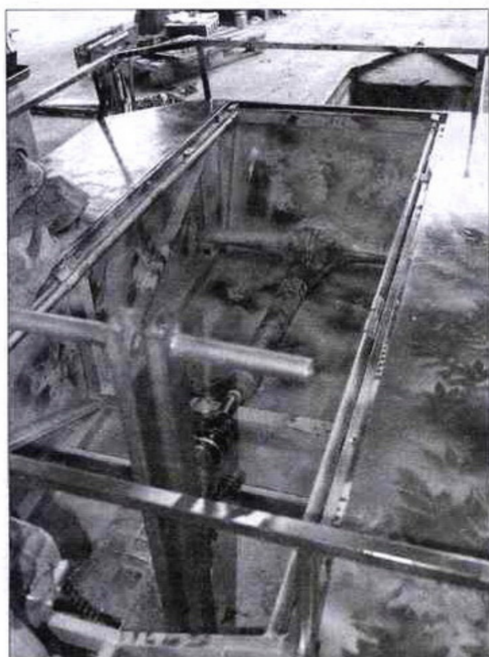
Карданный вал от «Нивы» идет от КПП к ведущему мосту автомобилей ВАЗ
