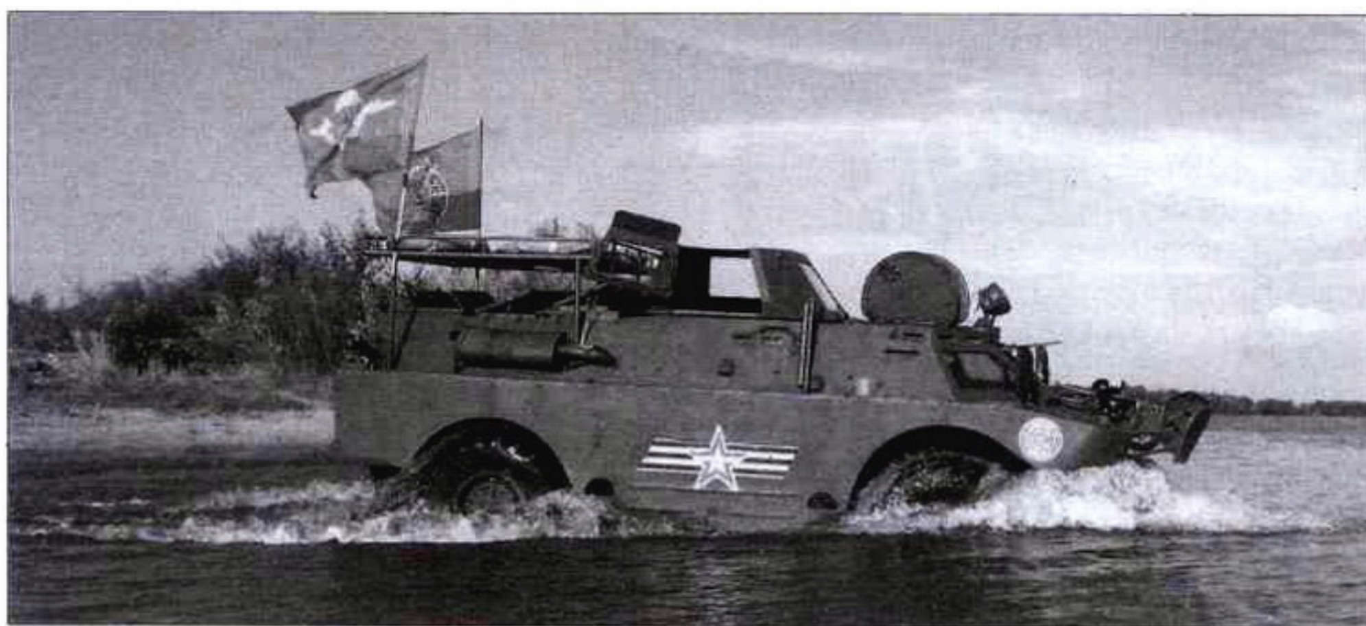
Кингстоны задраены, водоотбойный щит поднят, привод водомета включен – можно смело скатываться в воду!
