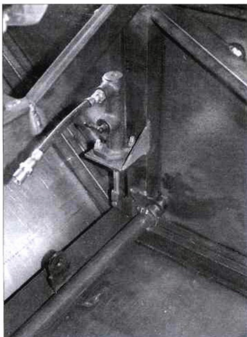
Главные тормозные цилиндры системы управления расположены по бортам
