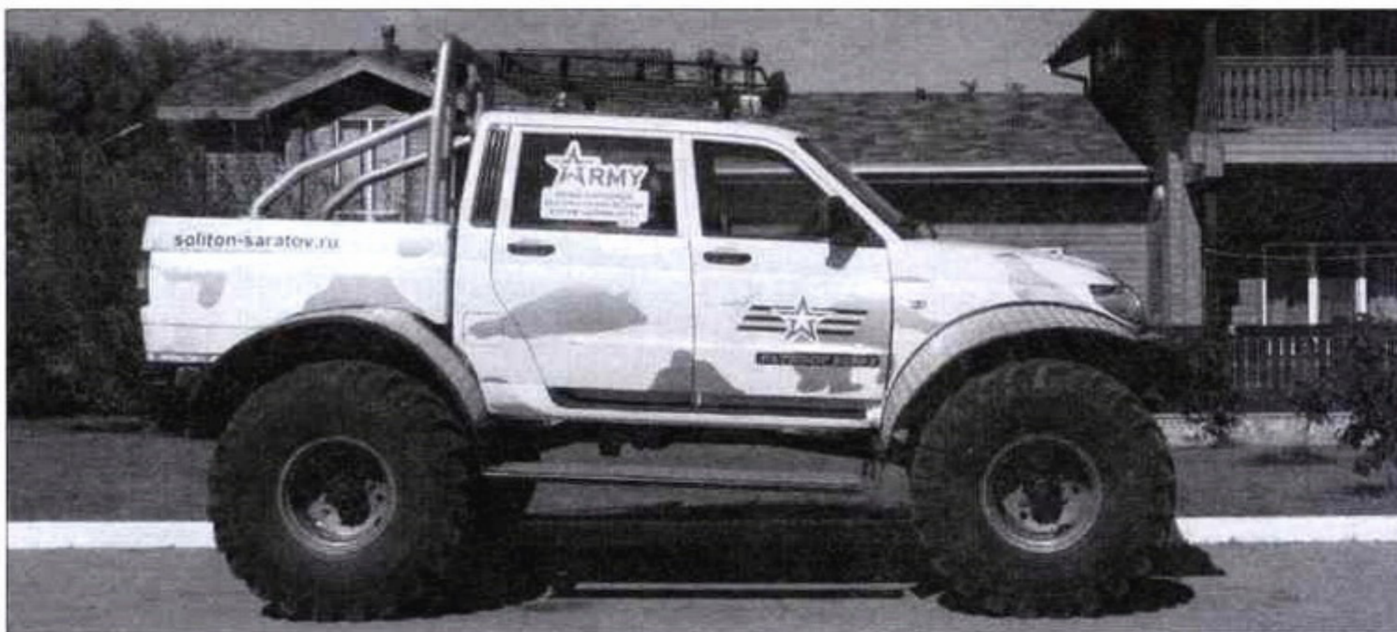
Колеса диаметром 48" (против 29,5" у штатного УАЗа) способны кардинально изменить проходимость автомобиля
