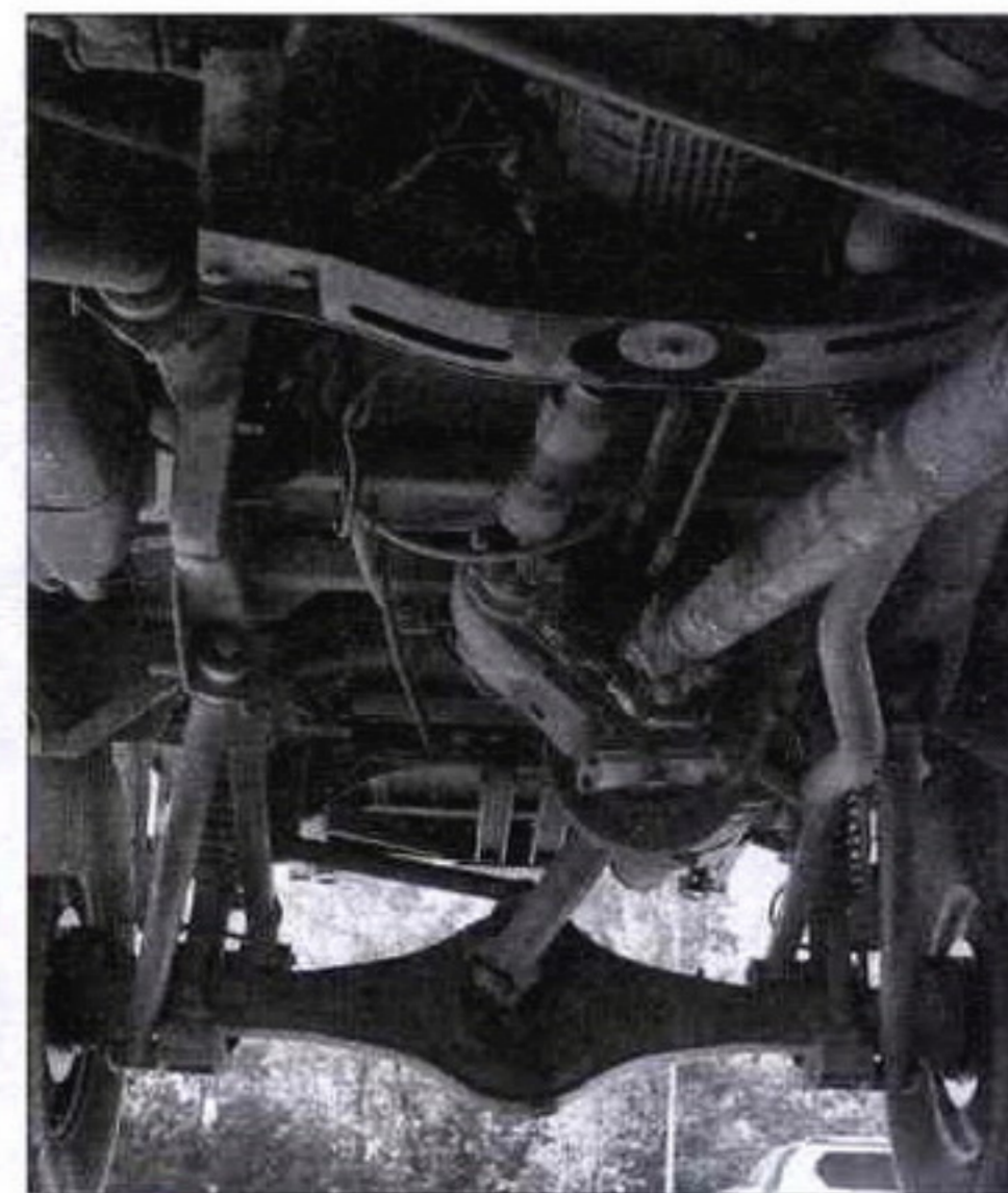
Раздатка также взята от «газовского» грузовика, но она переделана, чтобы фланцы переднего и заднего карданных валов лежали на одной линии
