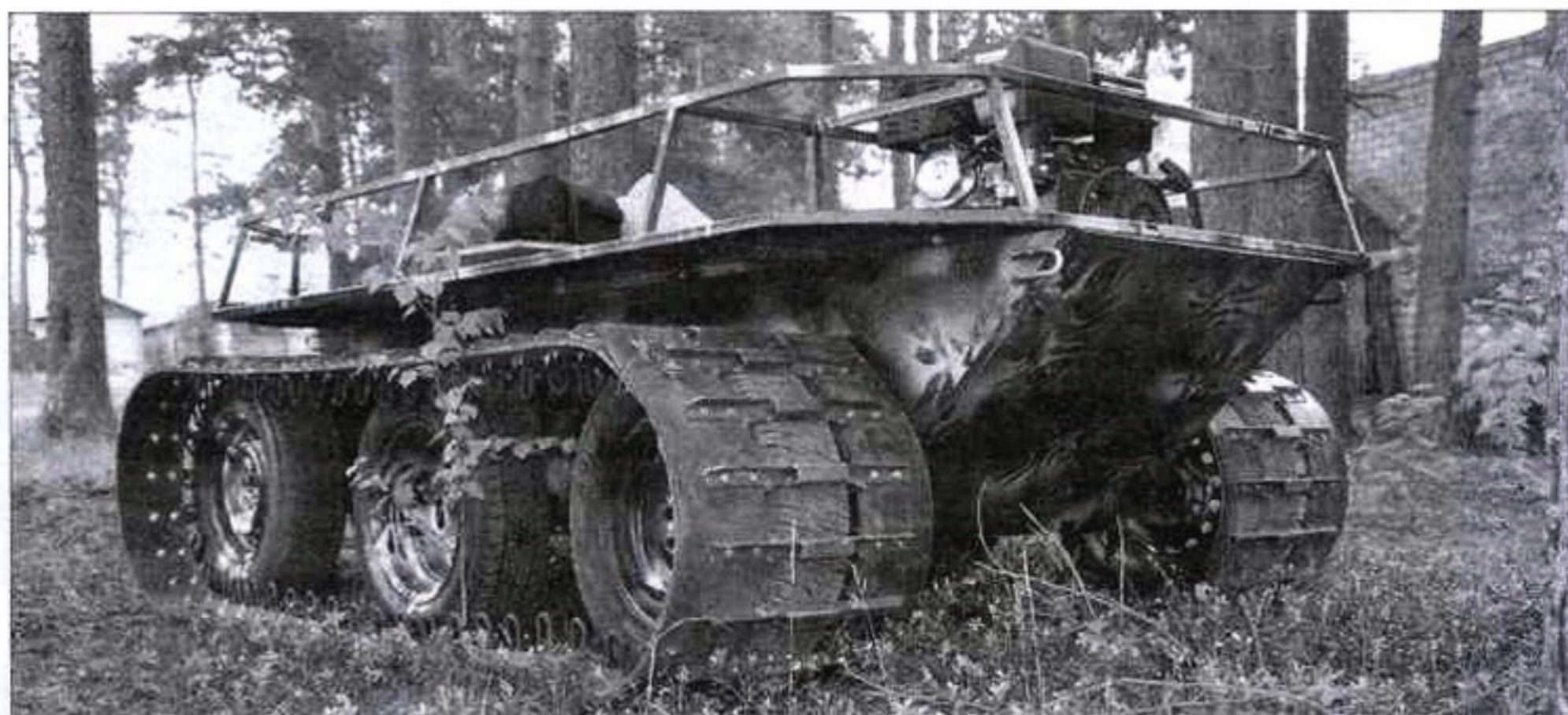
Задние ведущие колеса установлены так же, как на автомобиле, остальные – выпуклой частью диска внутрь. Это позволяет уменьшить консоли их осей
