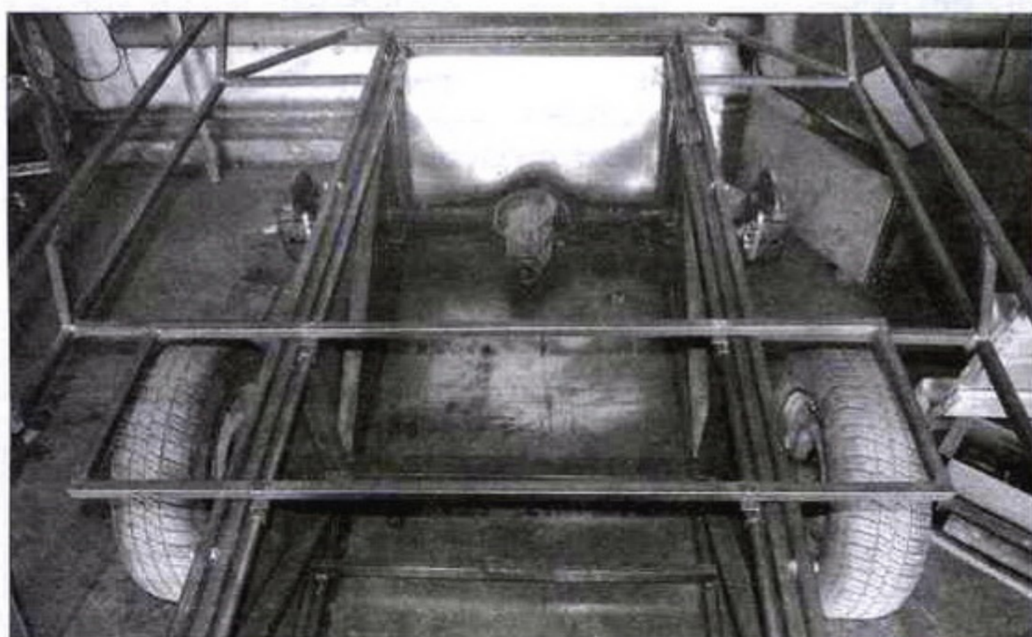
Вездеход оборудован сиденьями, которые, скользя по специальным трубчатым полозьям на бортах, трансформируются в ложе длиной 1900 мм. На фото виден каркас переднего сиденья
