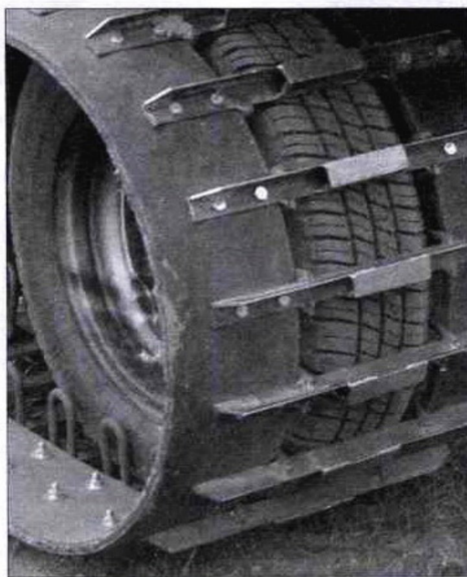
Каждая гусеница изготовлена из двух полос, вырезанных из транспортной ленты ТК-200, которые скреплены полусотней уголков
