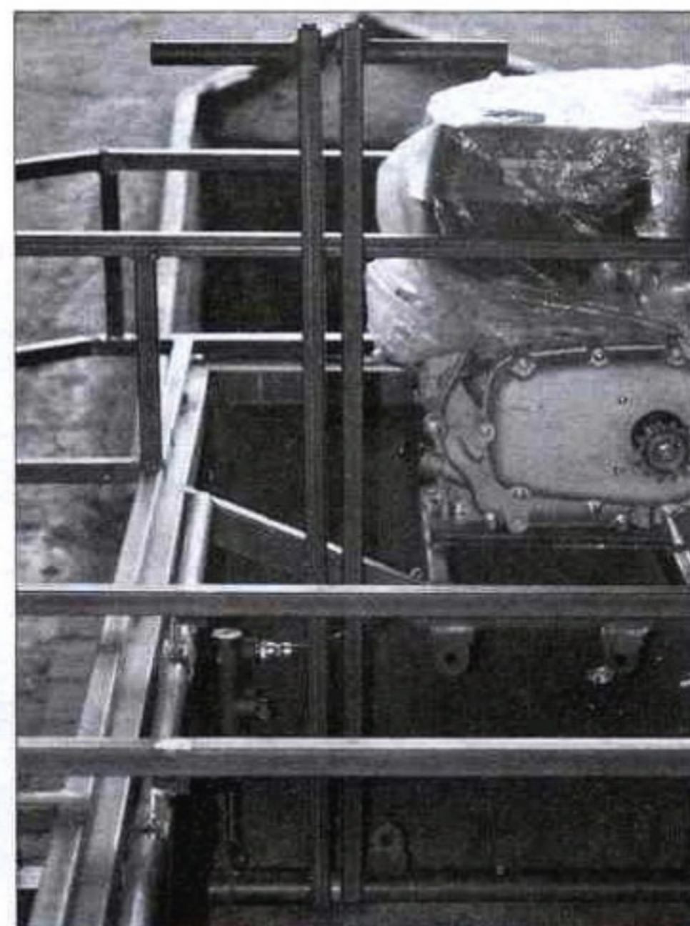
К рычагам управления приварены трубчатые оси: правая длинная, левая короткая
