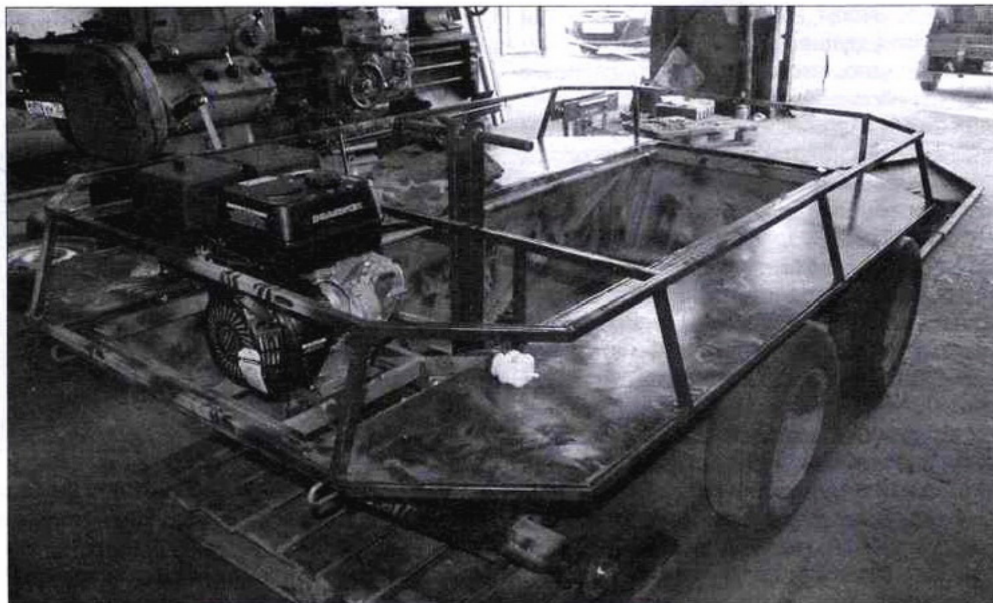
В передней части вездехода располагается двигатель Carver мощностью 15 л.с. воздушного охлаждения
