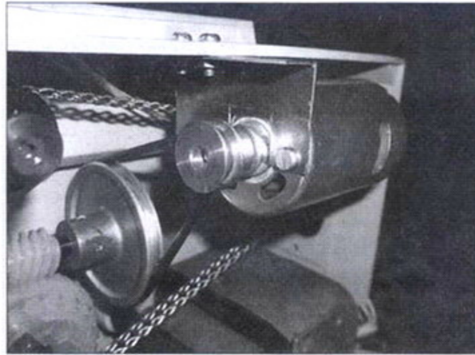
Вариант замены штатного мотора двигателем постоянного тока с электронным управлением
