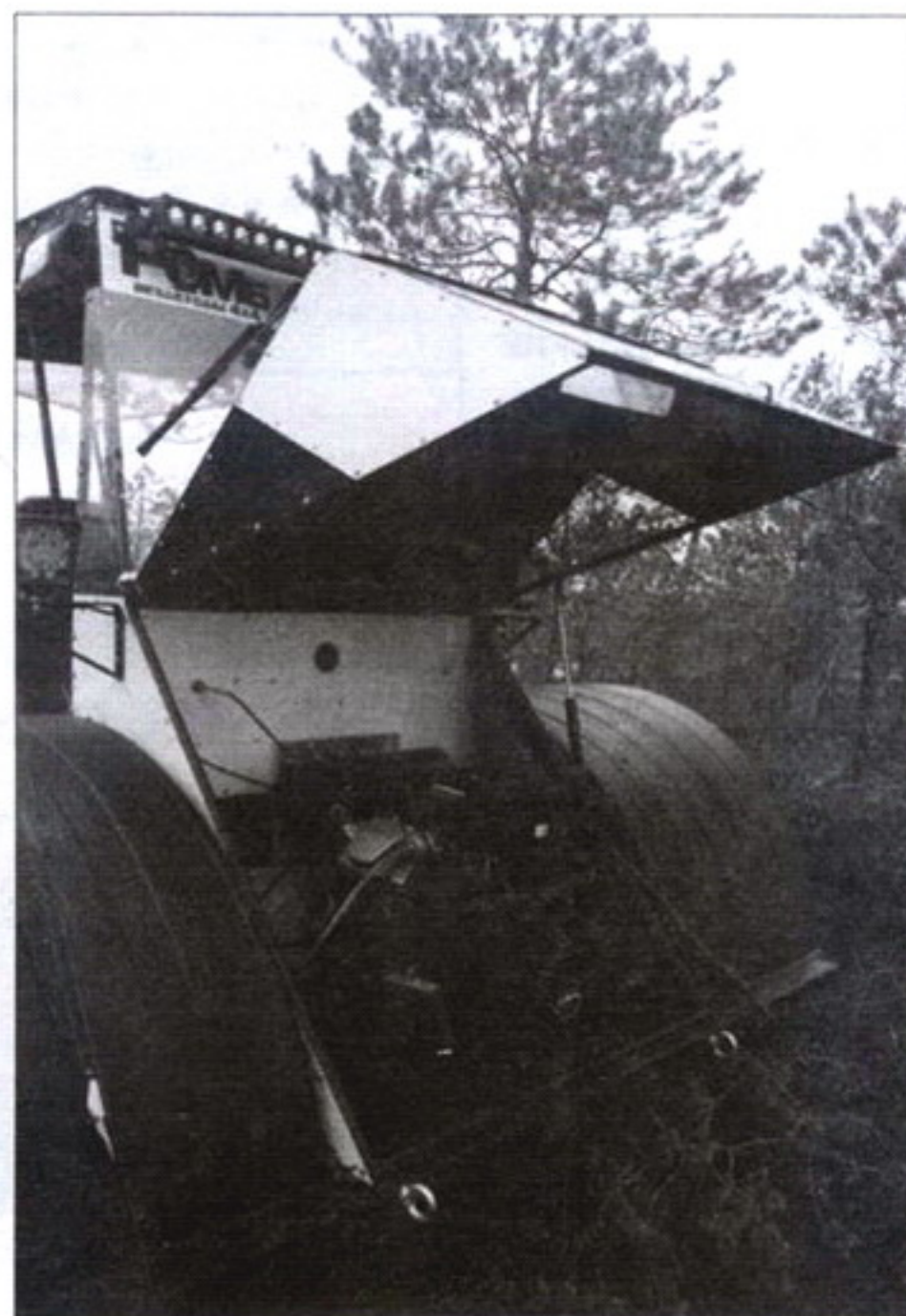
Откинув капот, получаем доступ к двигателю Lifan 2V78F и вариатору «Сафари»
