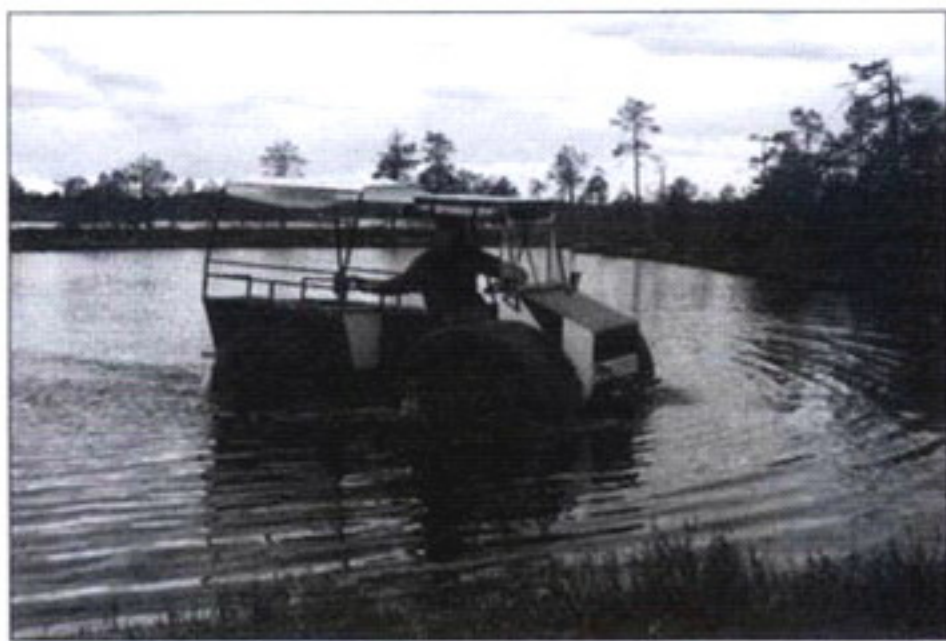
На воде «Ромб» уверенно держится за счет огромного водоизмещения своих колес
