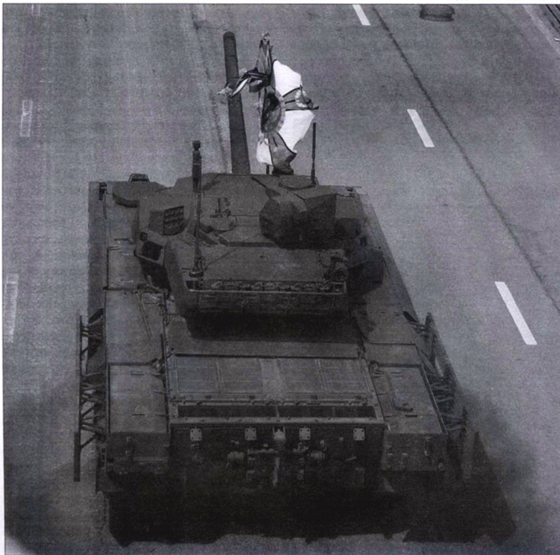
Дополнительные топливные баки защищены открытоячейным наполнителем, прикрыты броней и противоккумулятивными экранами
