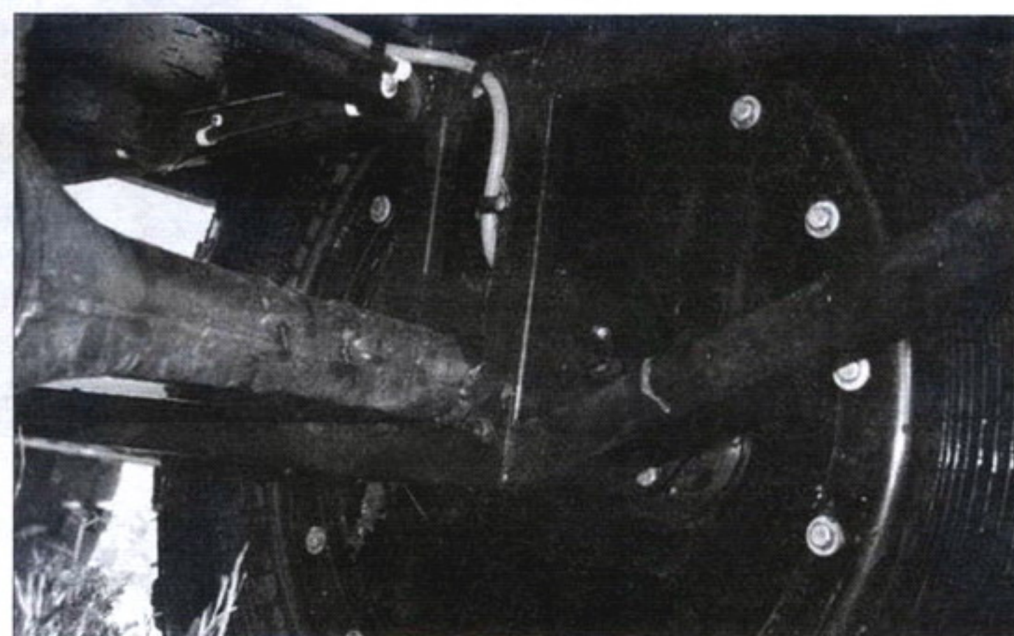
Подвески «Ромб», как и большинство «переломок», не имеет, крепление моста к раме незамысловато и понятно из фотографии
