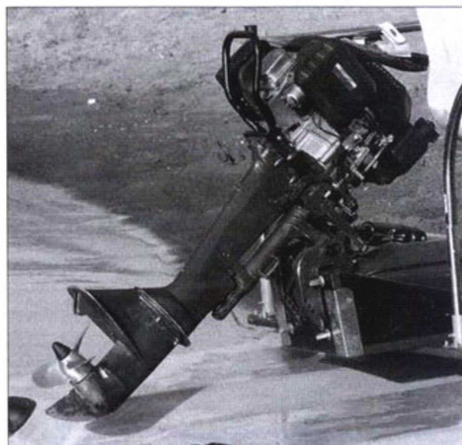
Гибрид «Ветерка» на транце катамарана
