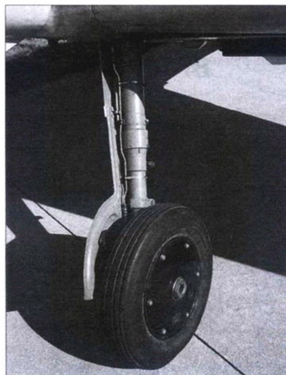
Основная опора шасси Bf 109G-4 с уменьшенным углом развала колеса
