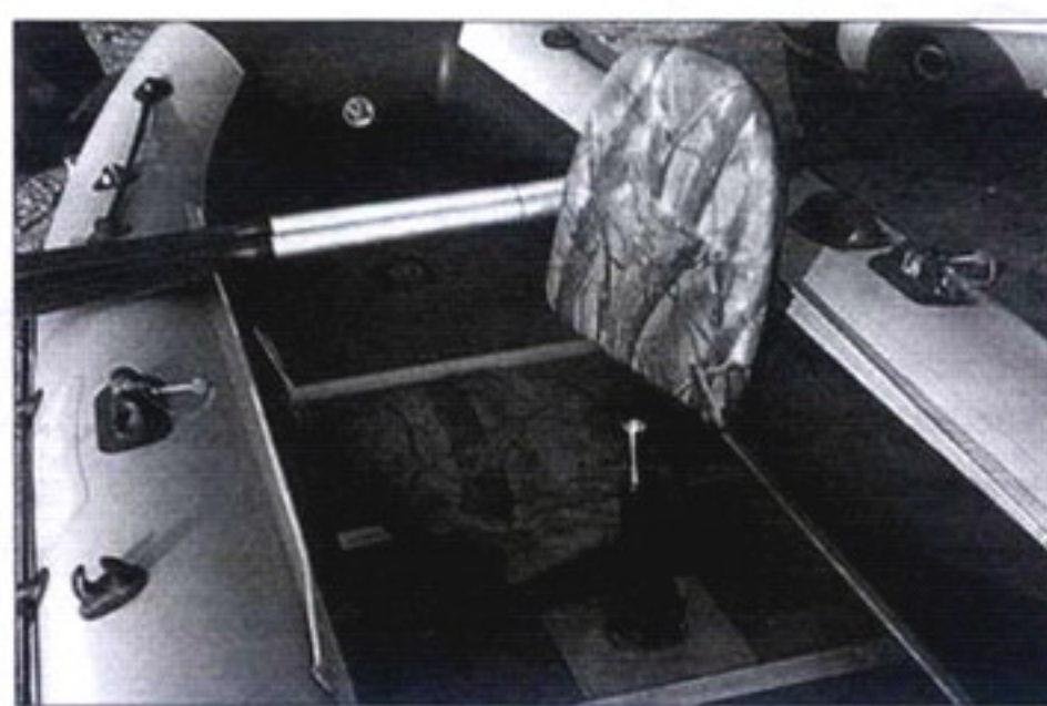
Втулка с амортизатором, закрепленная в новой опоре
