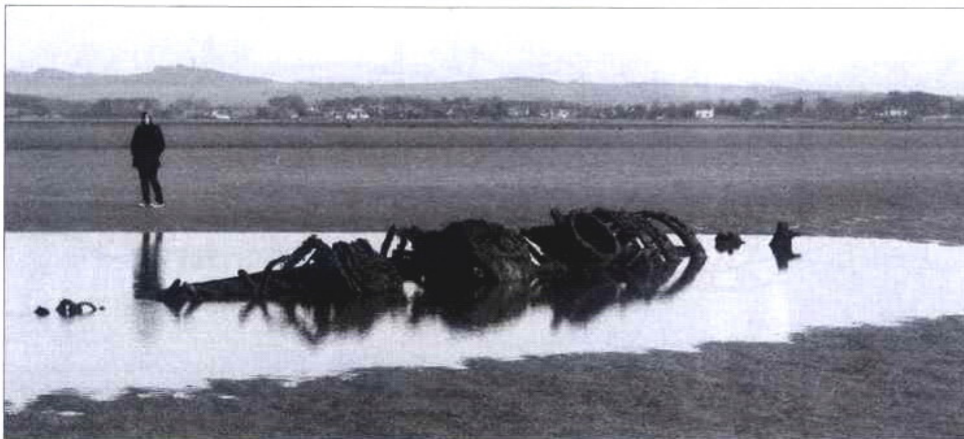
Останки одной из двух мини-субмарин типа «ХТ» на пляже в заливе Аберлэди в Шотландии по состоянию на 2008 год. Нос слева, корма справа. Можно видеть остатки отдельных отсеков: «сухого-мокрого» с «мокрым» люком для водолаза, рубку и второй люк. В 1946 году две лодки этого типа были закреплены бетонным «якорем» и использовались в качестве мишеней для авиации
