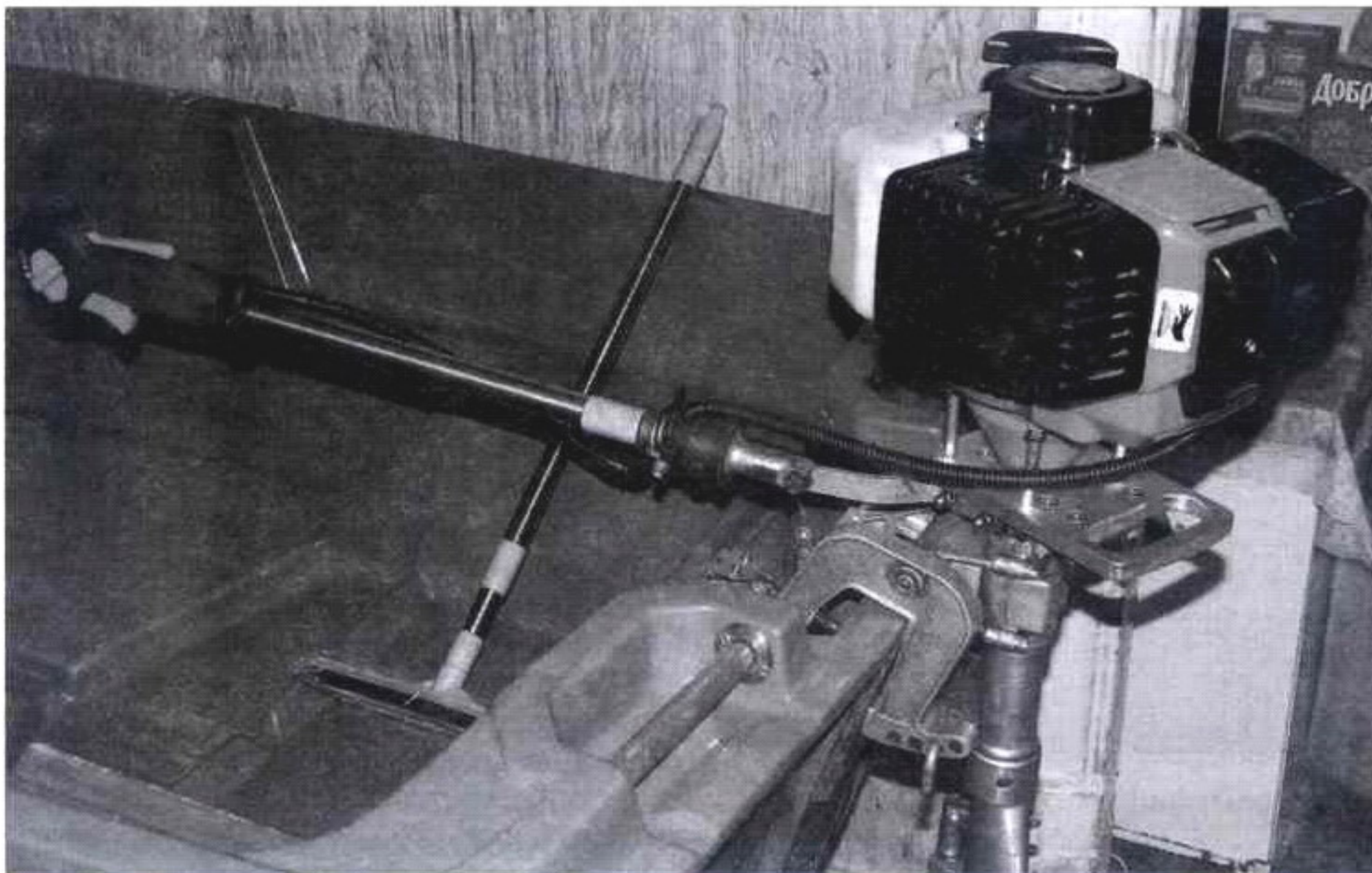
Румпель – раздвижной, сделанный из телескопической щетки для мытья окон. Клавиша газа и выключатель зажигания находятся на ручке от бензокосы
