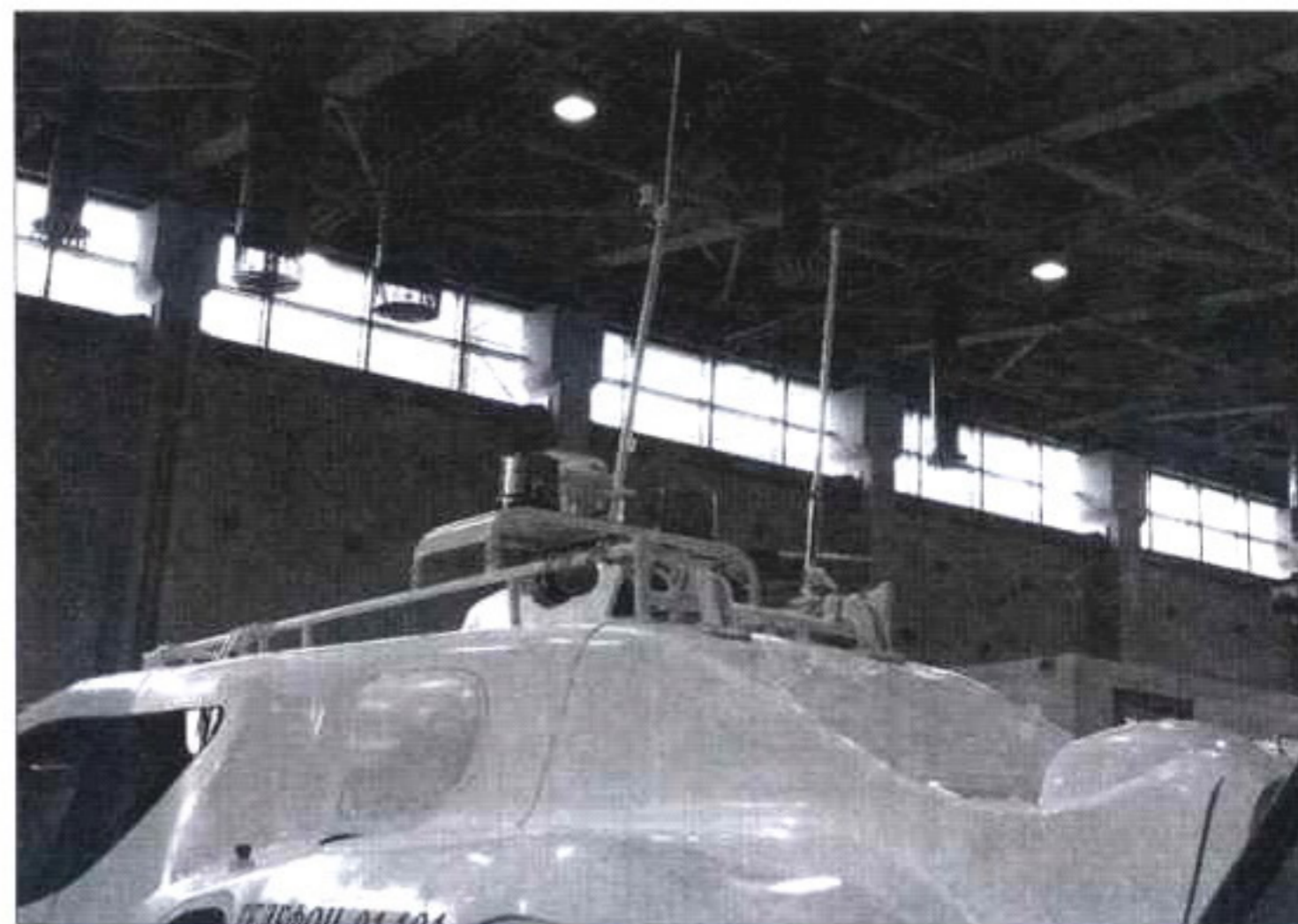
Антенна связной радиостанции и сигнальные огни СВП XG-8, демонстрировавшемся на выставке «Интерполитех-2017»
