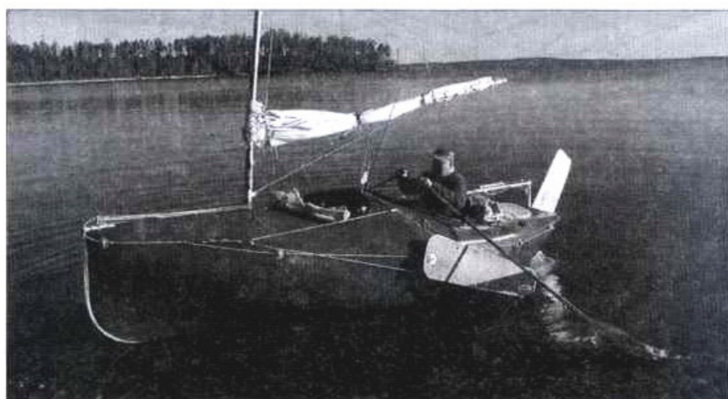
При отходах от берега или к подходах к нему можно воспользоваться веслами. Места установки уключин позволяют грести как сидя по курсу, так и спиной вперед. А если снять парусное вооружение (на это требуется 10 минут), лодка превращается в гребную с неплохими ходовыми характеристиками
