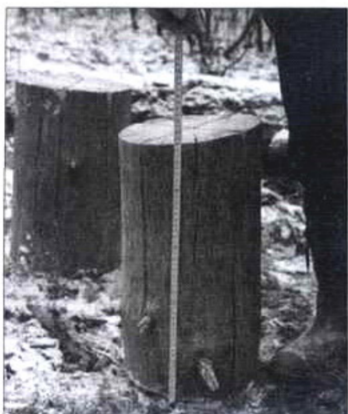
Высота заготовки должна быть равна примерно двум ее диаметрам. Но более 600 мм делать ее не имеет смысла – «свечка» разрушится
