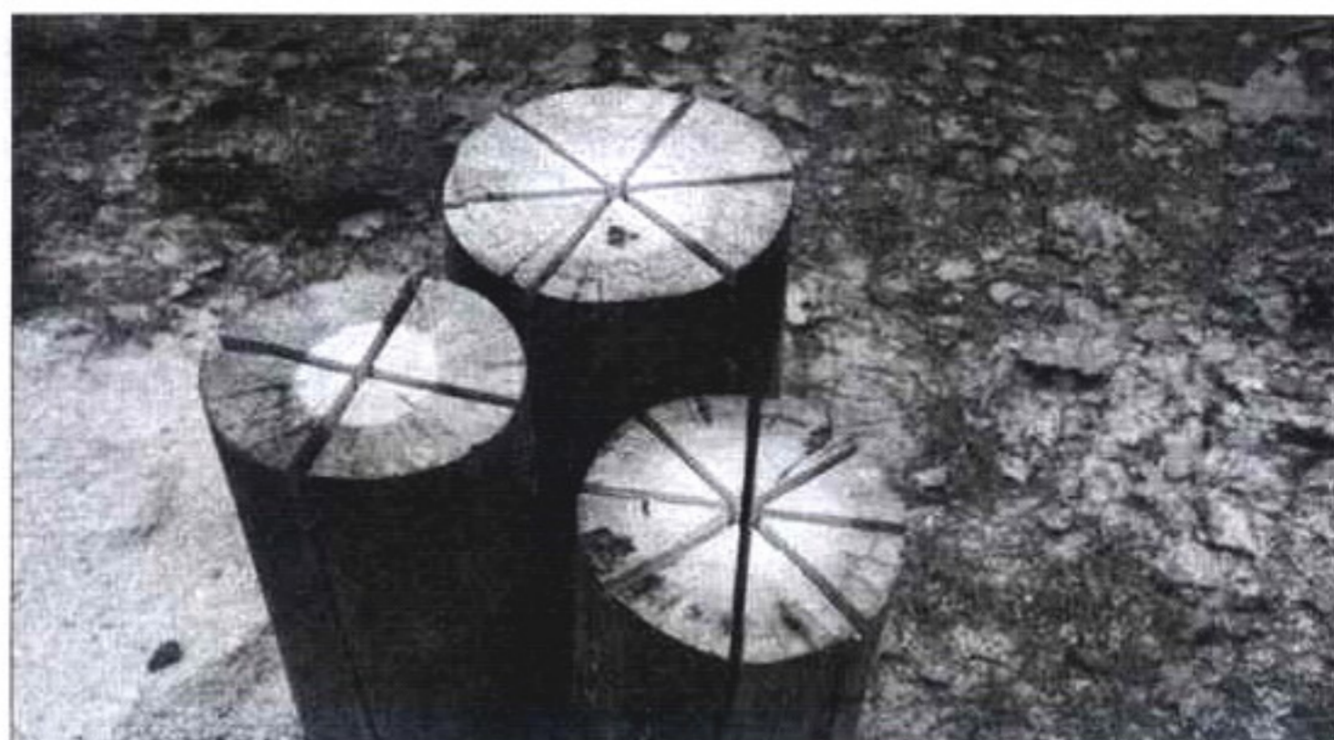
Наши подопытные образцы, распиленные на четыре, шесть и восемь частей
