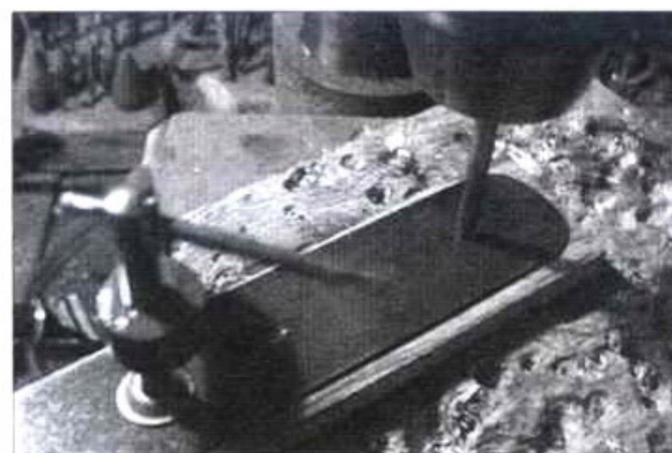
Для обеспечения соосности отверстия во второй накладке сверлим по шаблону
