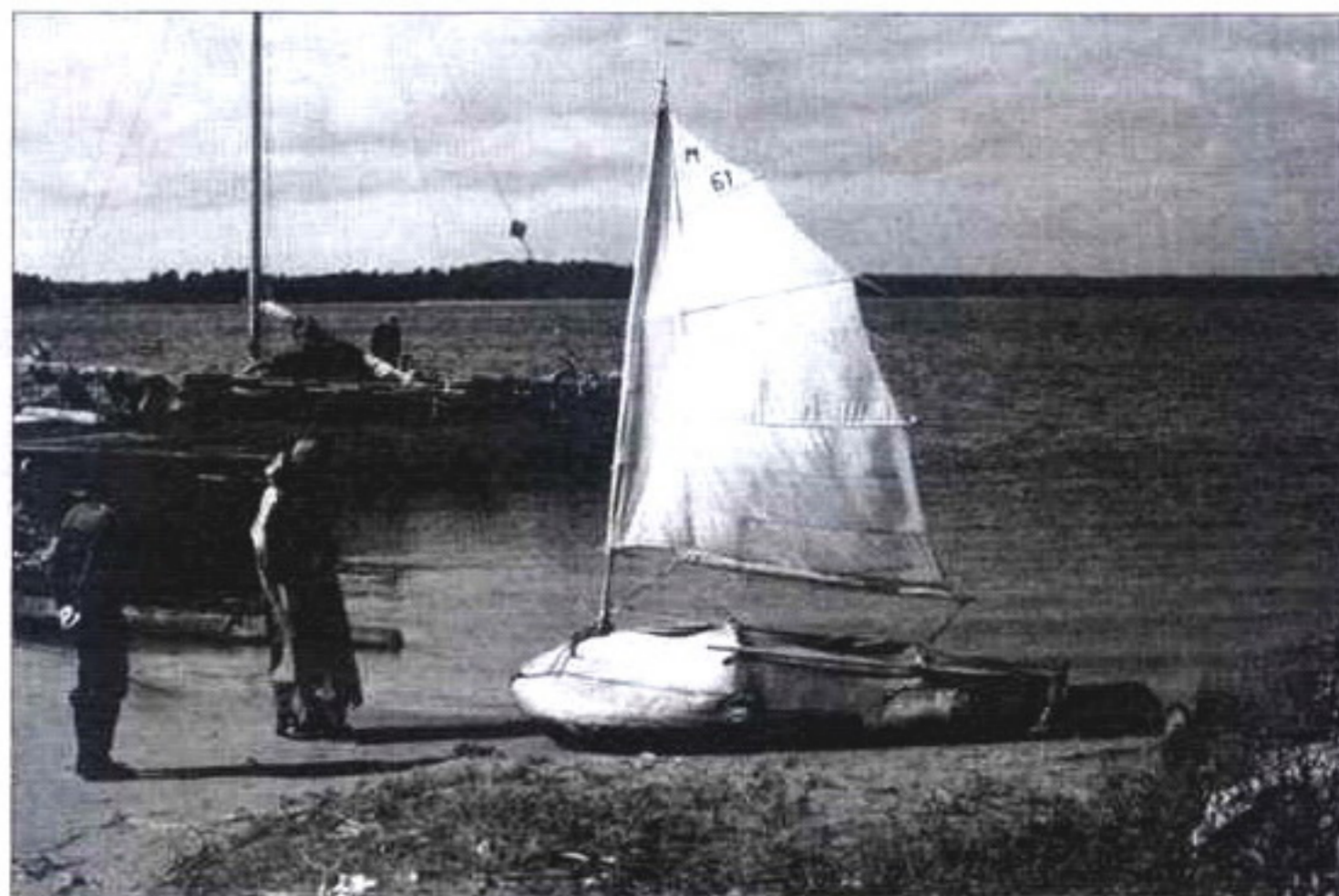
Один из первых эскизных набросков «Авоськи-2»: в основе надувная лодка «Волна», а сверху каркас, собранный из лыжных палок
