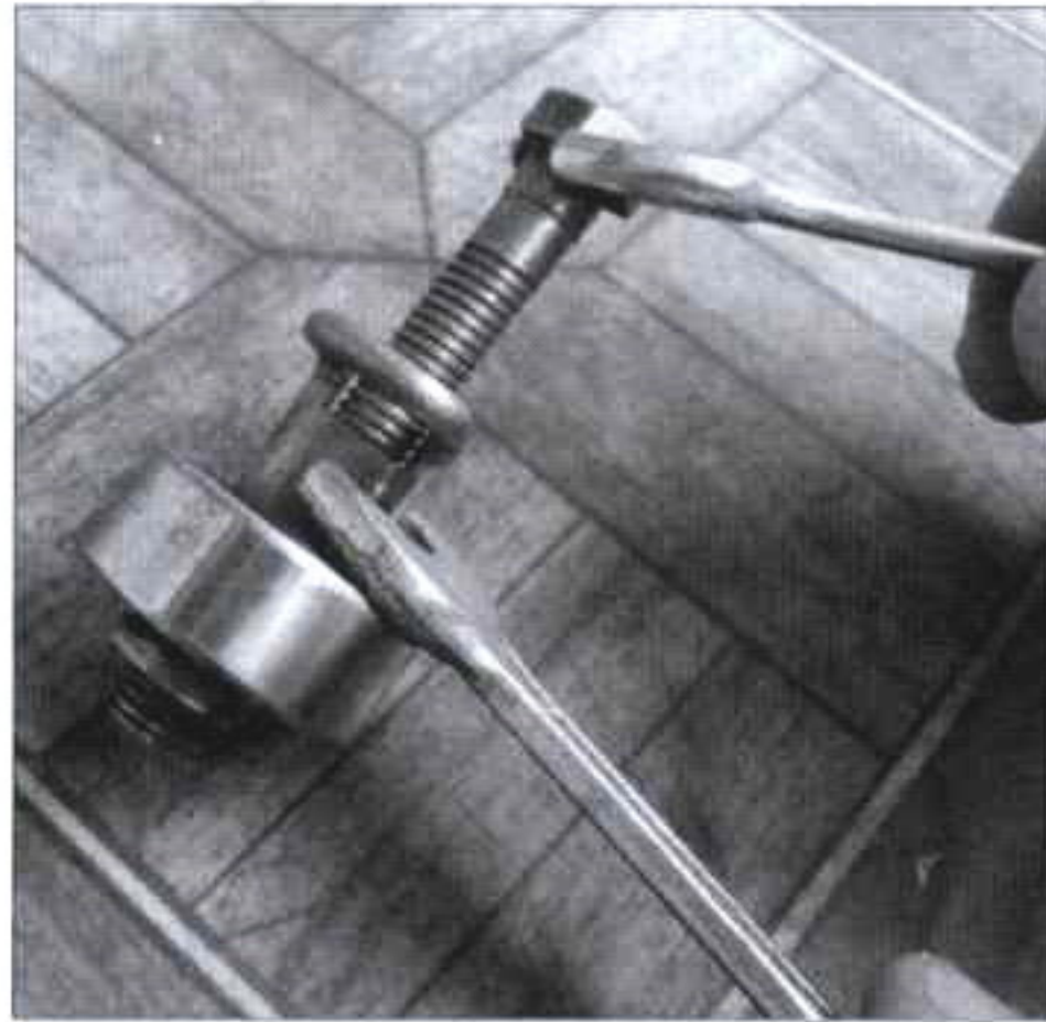
Работа с экстрактором по извлечению подшипника с помощью рожковых ключей
