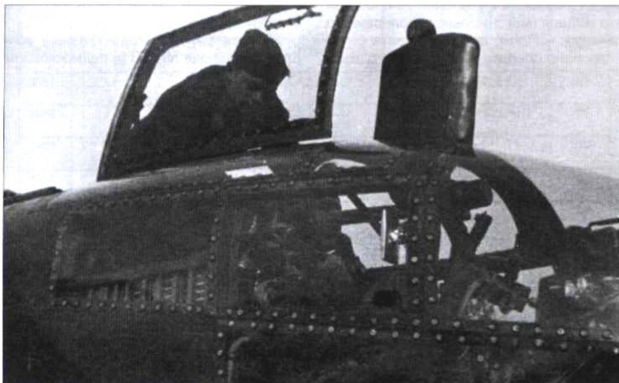
Фрагмент носовой части фюзеляжа Ar234B-2 с открытой крышкой фонаря кабины пилота и перископом RF2C стрелкового прицела
