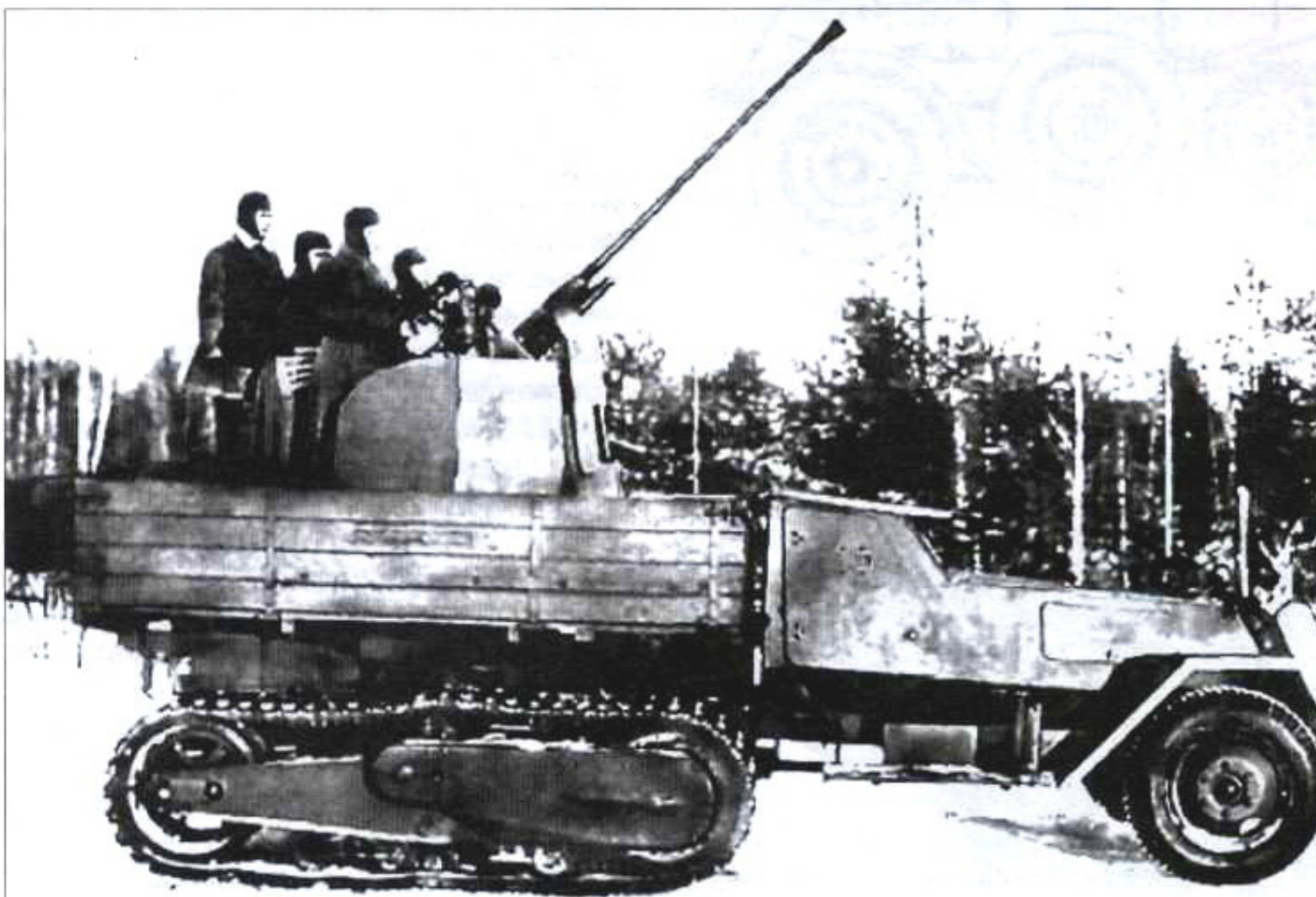
Зенитная САУ ЗИС-43 с 37-мм пушкой. Шасси – вездеход ЗИС-42, масса – 8,75 т, мощность двигателя – 90 л.с.
