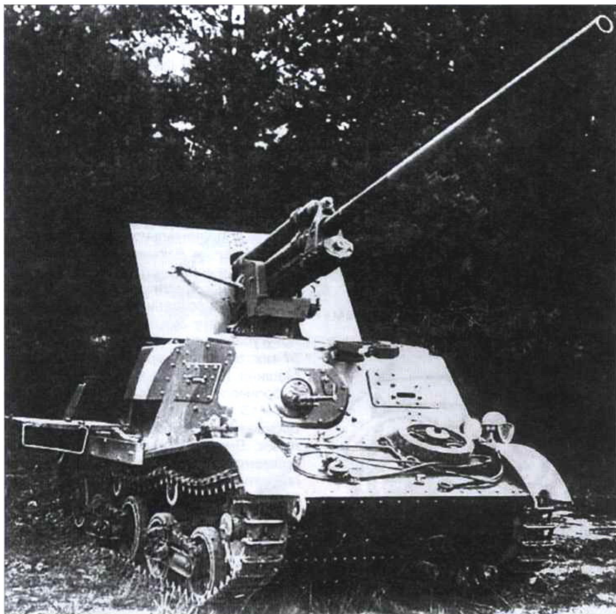
Гусеничная самоходная противотанковая установка ЗИС-30 на шасси тягача Т20 «Комсомолец» с 57-мм пушкой ЗИС-2. 1941 г.
