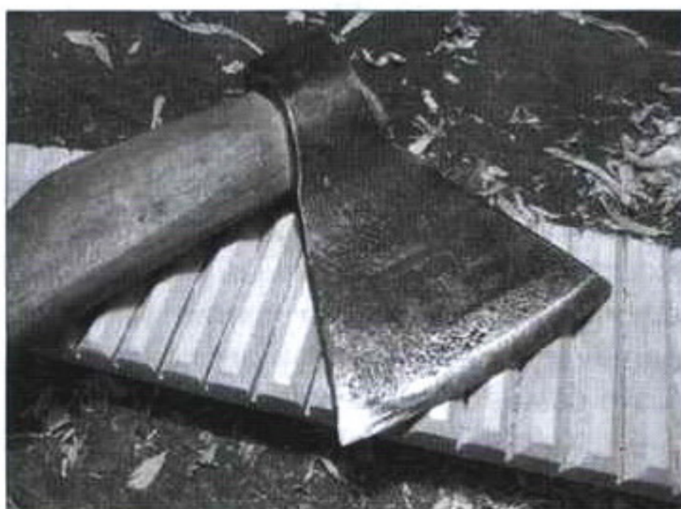
Новый рубель и инструмент для его изготовления (плотницкий топор)
