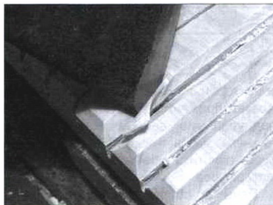
Процесс изготовления зуба рубеля при помощи топора
