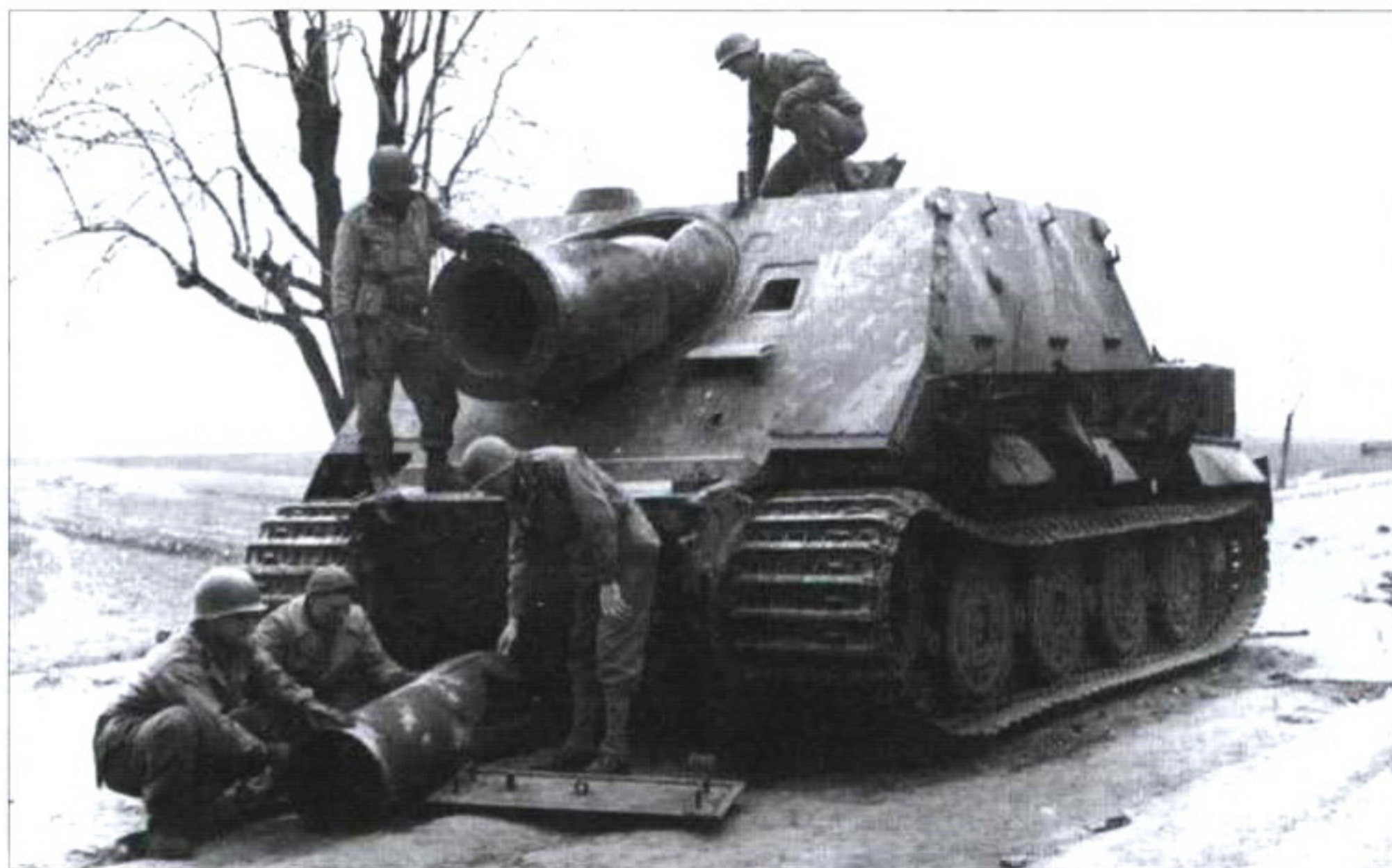
«Штурмтигр», подорванный своим экипажем при отступлении. Перед установкой вырванный взрывом изнутри ствол бомбомета. 1944 г., район Миндана, Германия
