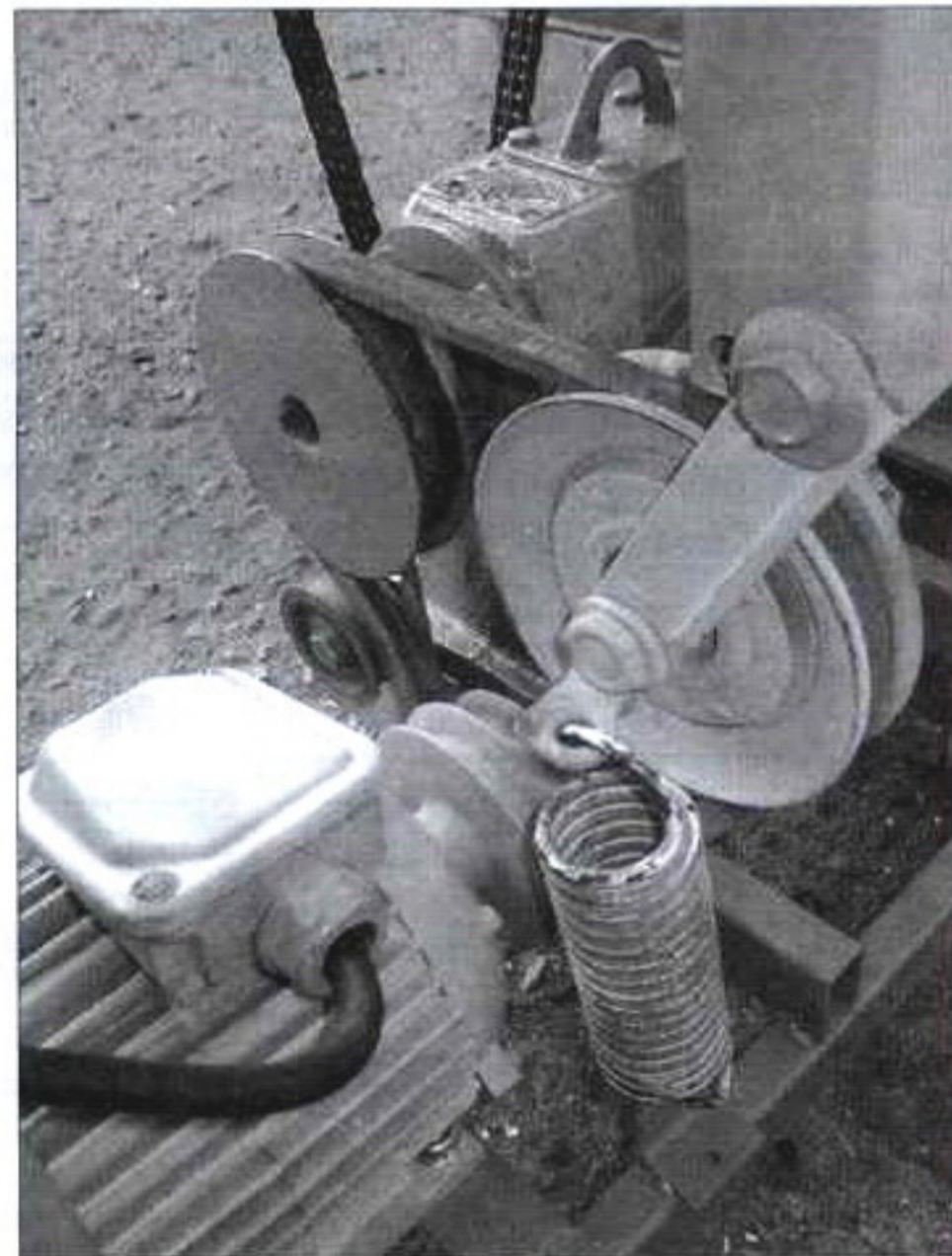
Приводной электродвигатель с клиноременной передачей
