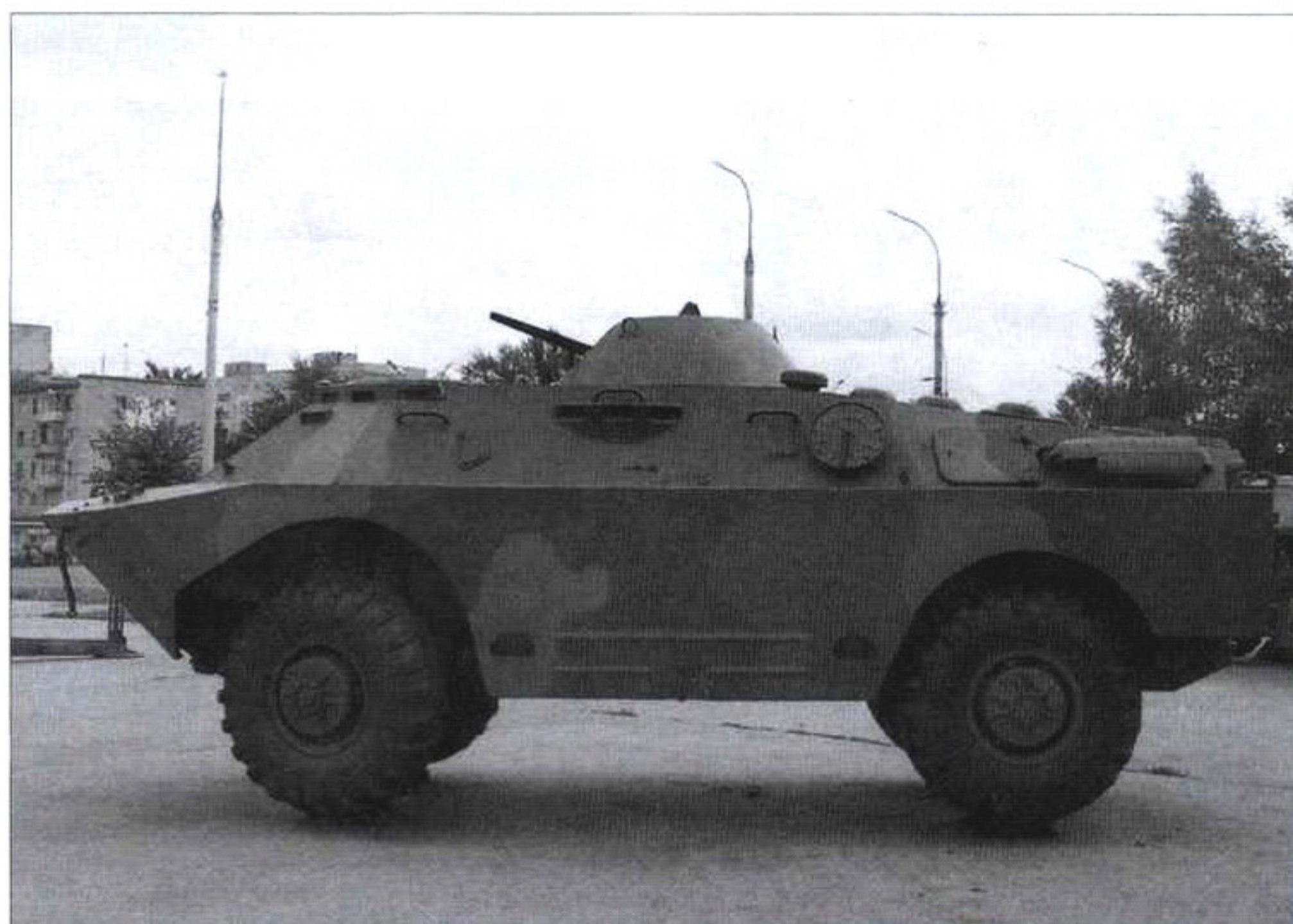
БРДМ-2 без вооружения и дополнительных колес, г. Тамбов
