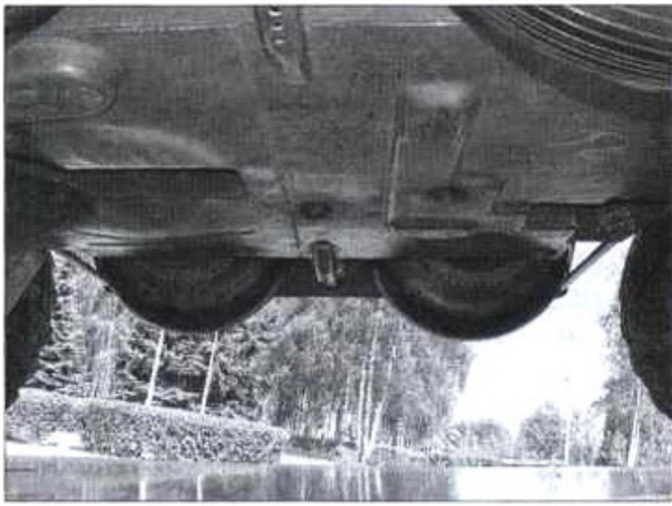
Дополнительные колеса с шестернями для цепной передачи
