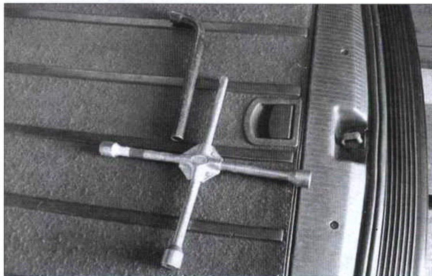
Универсальный «баллонный» крестообразный ключ, рядом лежит «усилитель»
