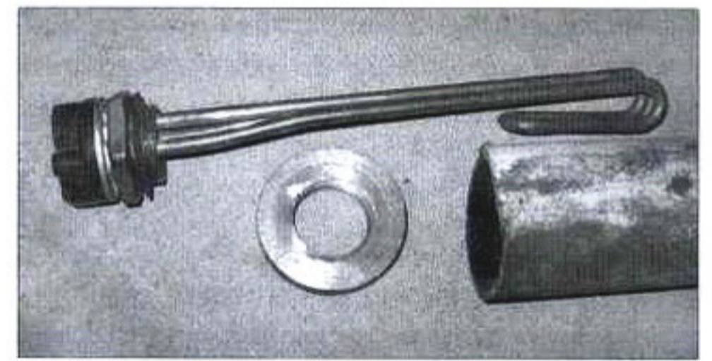
Детали однофазного котла: 1 – корпус; 2 – втулка; 3 – ТЭН
