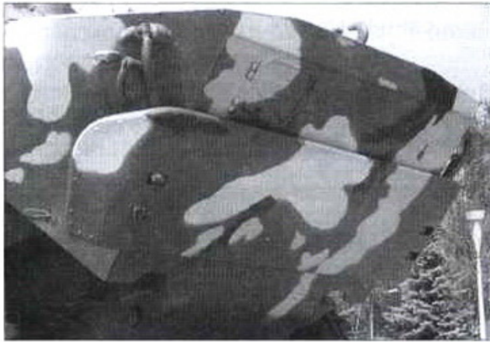
Передний щиток-отбойник воды в убранном положении
