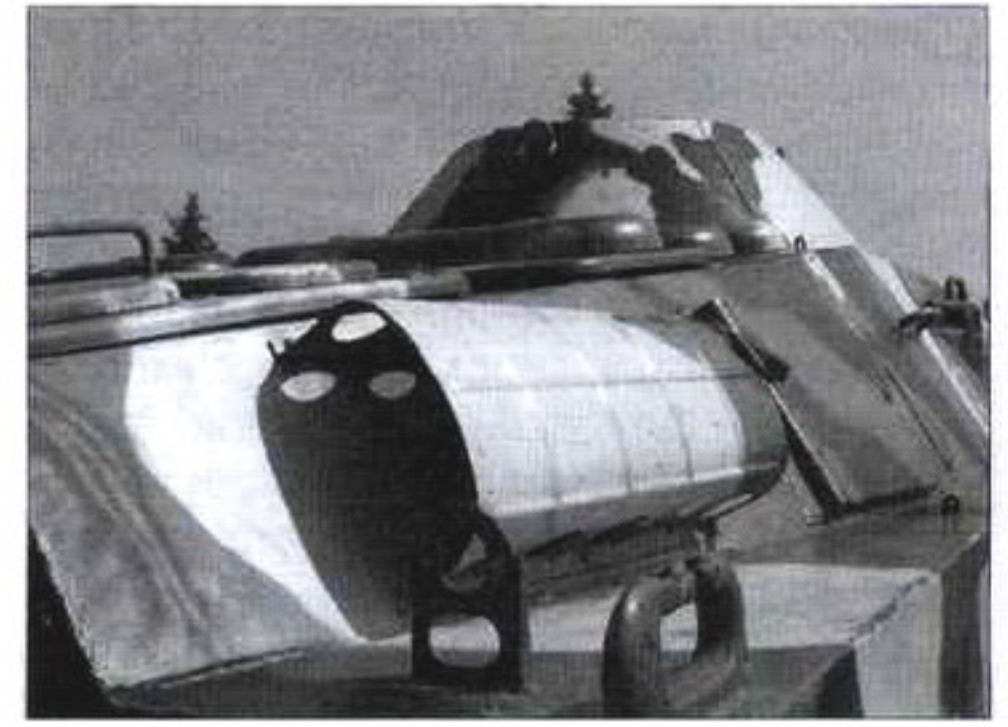
Экран глушителя двигателя
