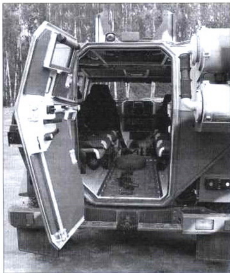
Корма автомобиля с открытой выходной дверью десантного отсека. На заднюю стенку вынесена фильтро-вентиляционная установка ФВУ-100А
