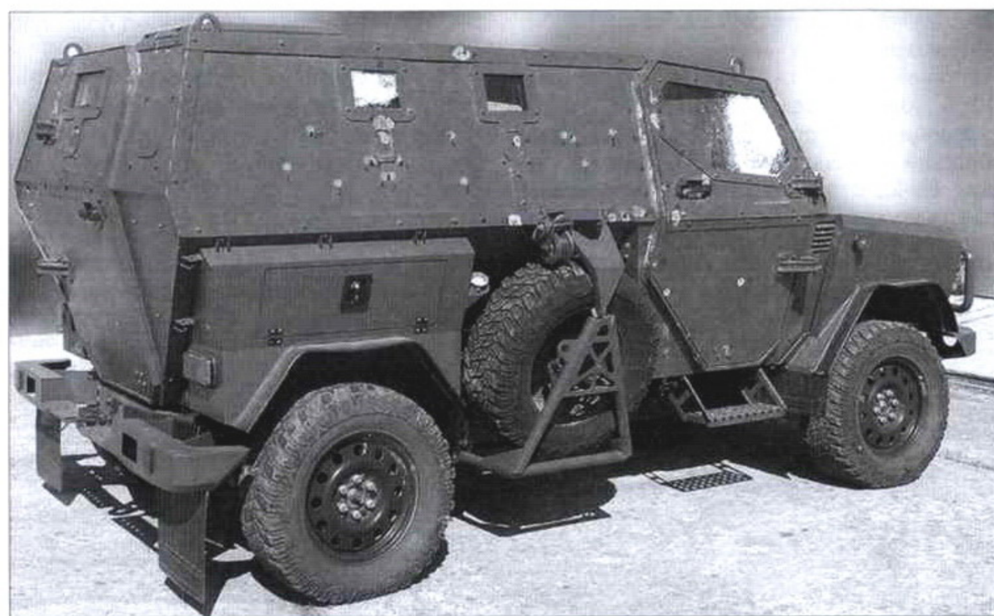
Броневая защита ЛША-Б соответствует 5-му классу отечественного ГОСТа Р-50963-96. На фото: автомобиль после обстрела из стрелкового оружия
