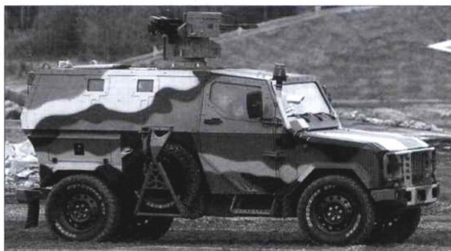
Броневик ЛША-Б. Масса – 3500 кг, скорость – до 130 км/ч. Вооружение – пулеметы типа 12,7-мм «Корд» или 7,62-мм ПКМ, 30-мм автоматический гранатомет АГ-17
