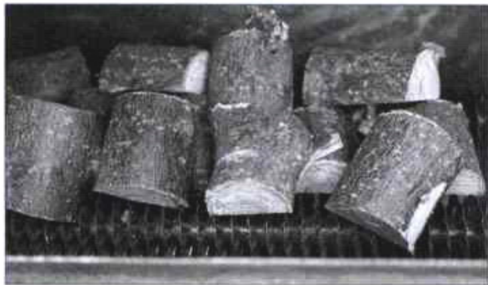
Укладка сырых чурок плодовых деревьев в электронагреватель на оребрение ТЭНов
