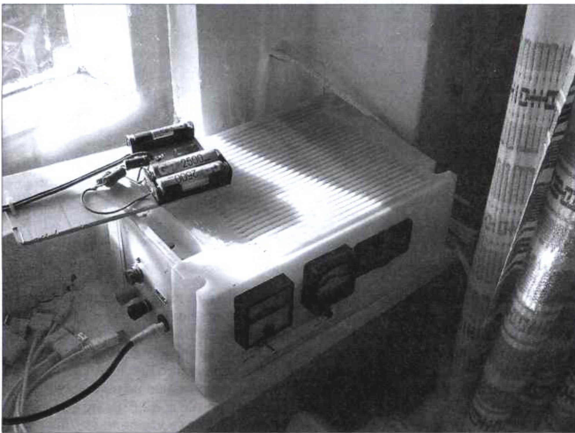
Фото 4. Зарядка «пальчиковых» аккумуляторов от солнечной электростанции
