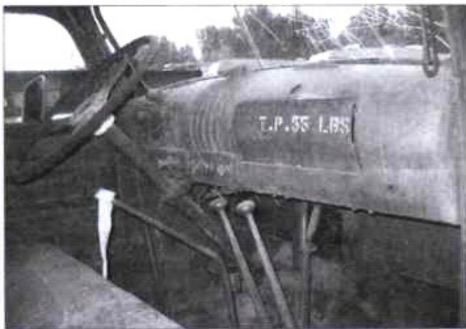
Приборная панель и органы управления автомобиля GMC CCKW SWB
