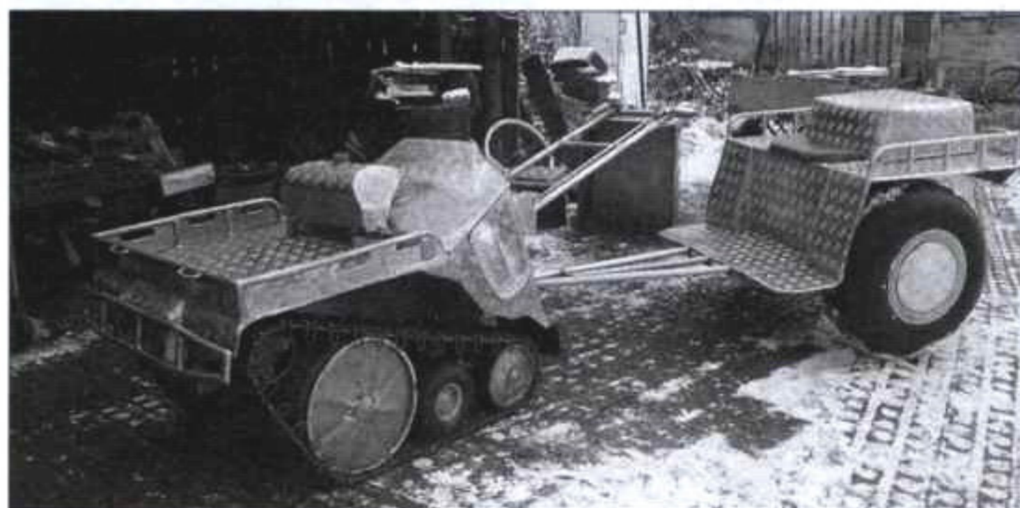
Гусеничный тягач-«собака» с колесным одноосным прицепом с сиденьем-козлами
