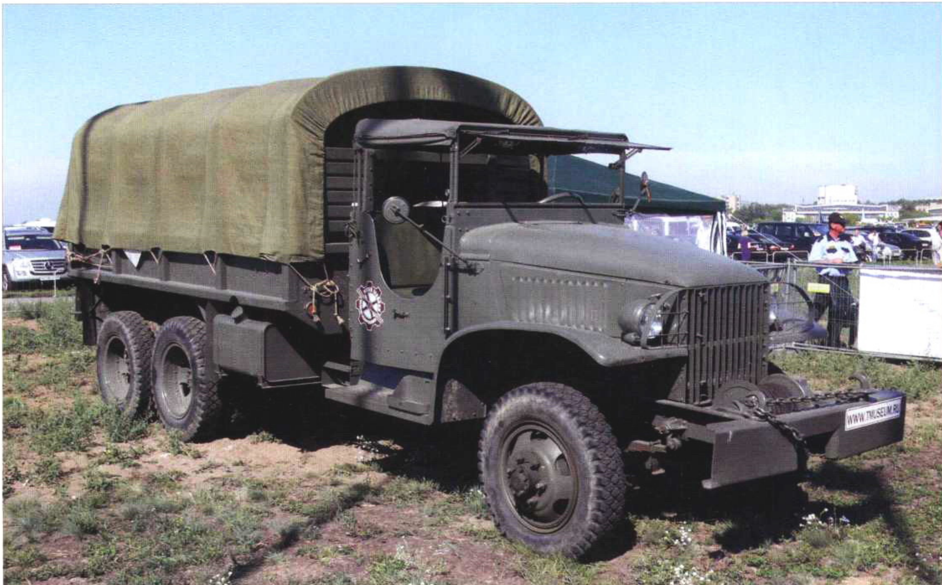
GMC CCKW 353 с лебедкой и брезентовым тентом над кабиной (вверху) и цельнометаллической кабиной (внизу)
