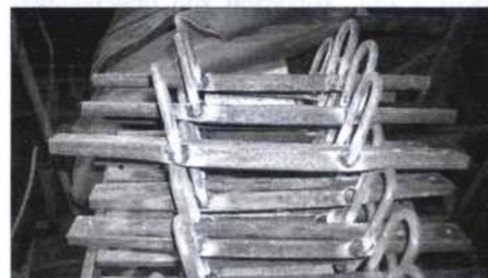
Траки гусеницы с приваренными боковыми ограничителями (дужками)
