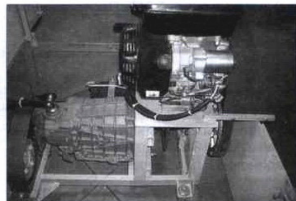
Силовой блок вездехода: на мотоподрамнике – двигатель; под ним – трансмиссионный тормоз; справа – вариатор; слева – коробка перемены передач и цепная передача
