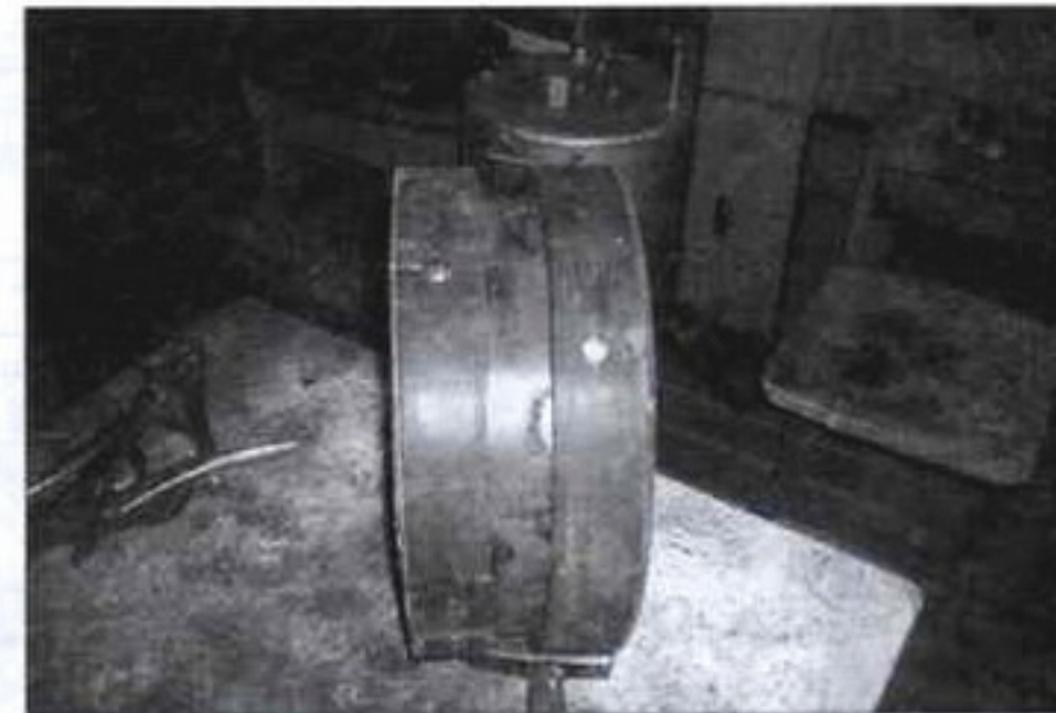
Натяжной каток с бандажом из двух полос транспортерной ленты
