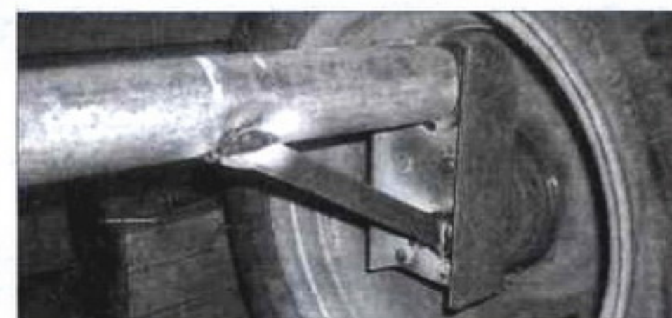
Опорный каток (каток через кронштейны жестко прикреплен к балке)
