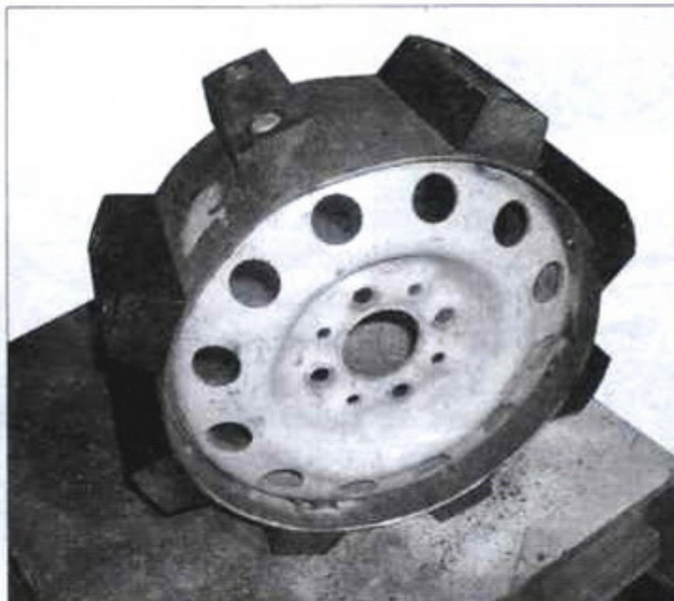
Приводное переднее зубчатое колесо гусеницы с зубьями из ПНД
