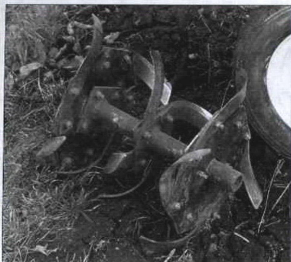
Почвообрабатывающие фрезы для мотоблока. Крайние ножи на каждом блоке установлены на дополнительные поставки-фланцы
