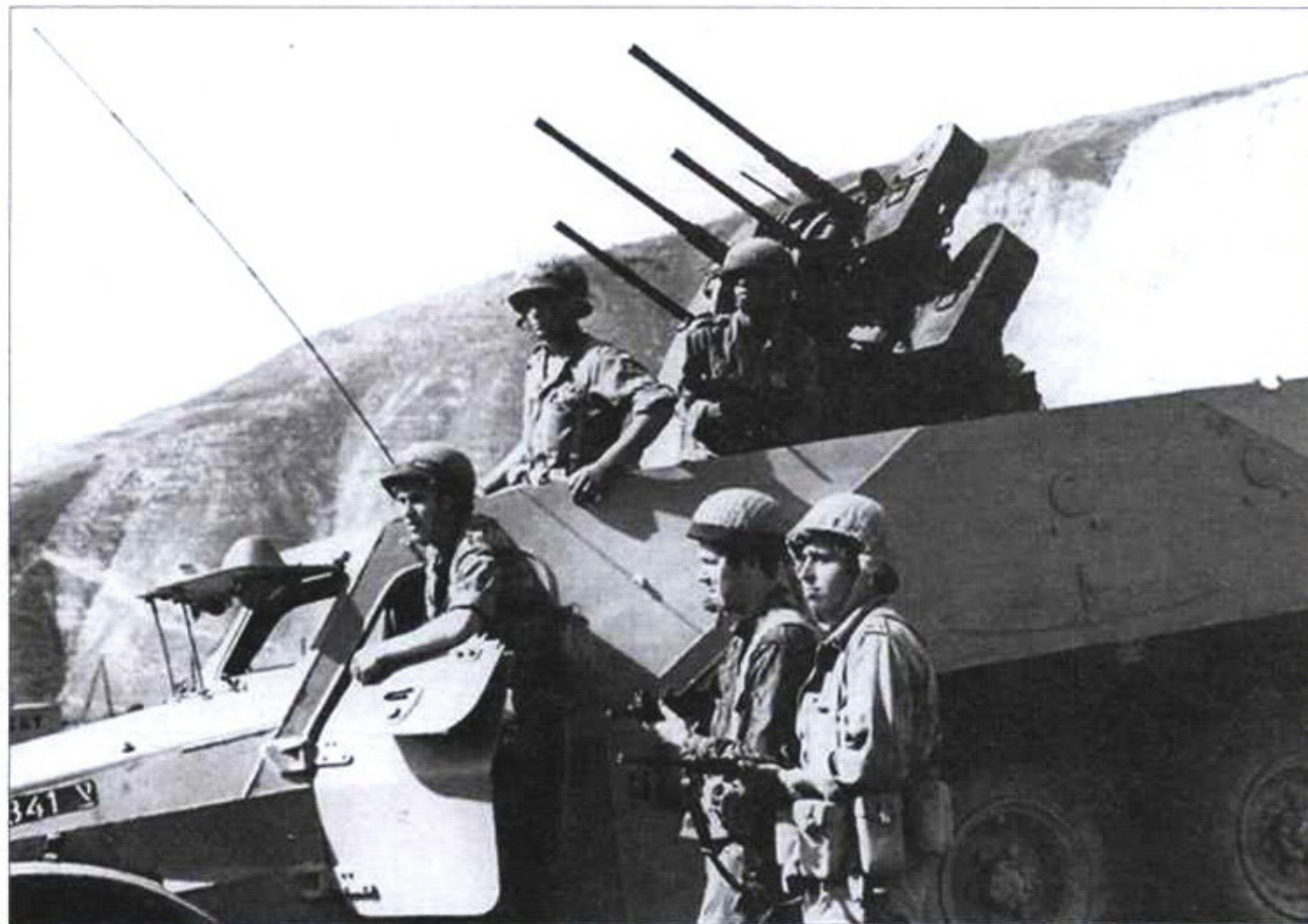
Счетверенная зенитная пулеметная установка М55 с 12,7-мм пулеметами «Браунинг» М2НВ, смонтированная на БТР-152. Армия Израиля
