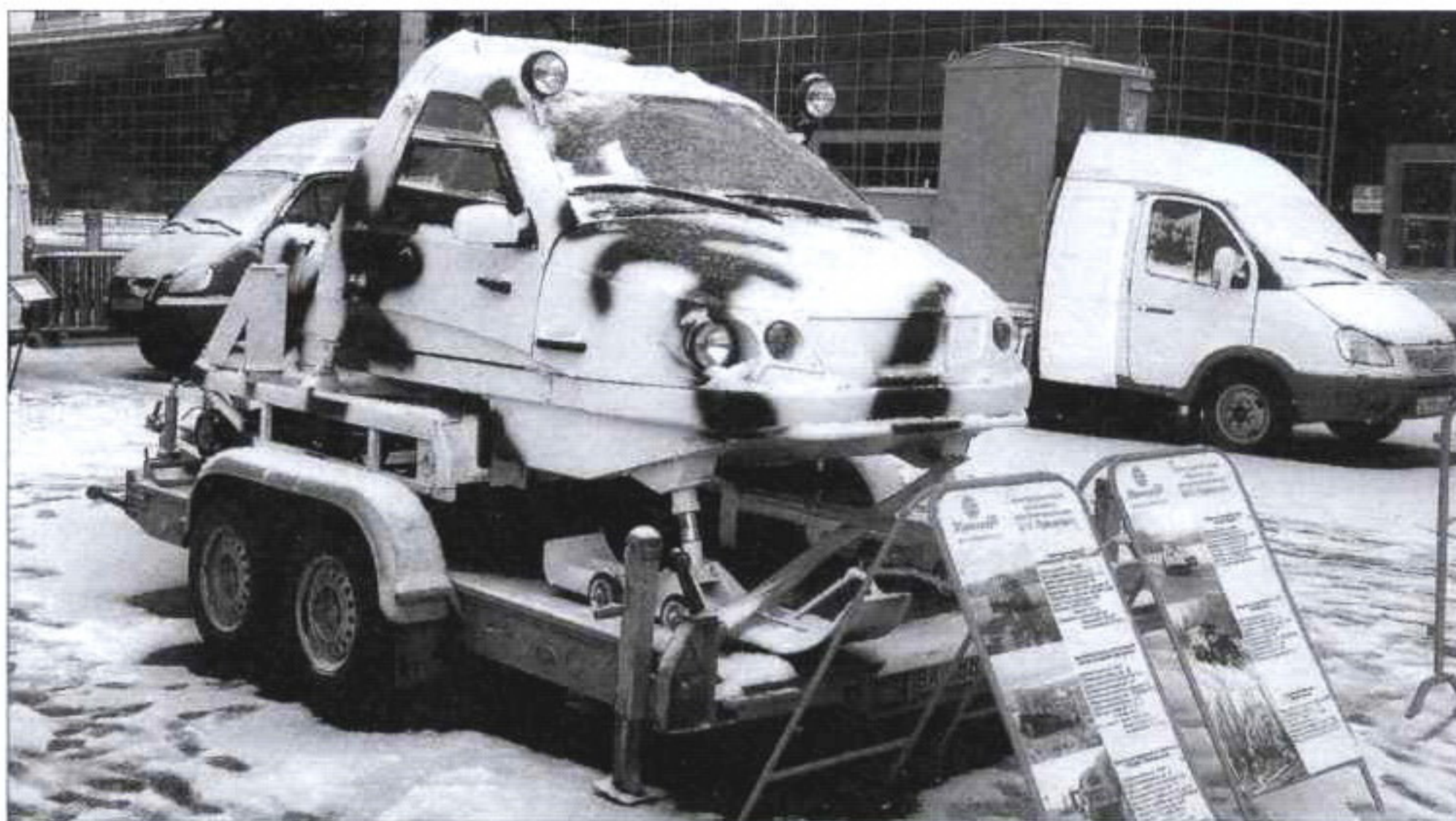
«Беркут-2» может транспортироваться на легких прицепах или в кузовах автомобилей типа «Газель». Специализированная выставка «Электрические сети России». Москва, 2012 г.
