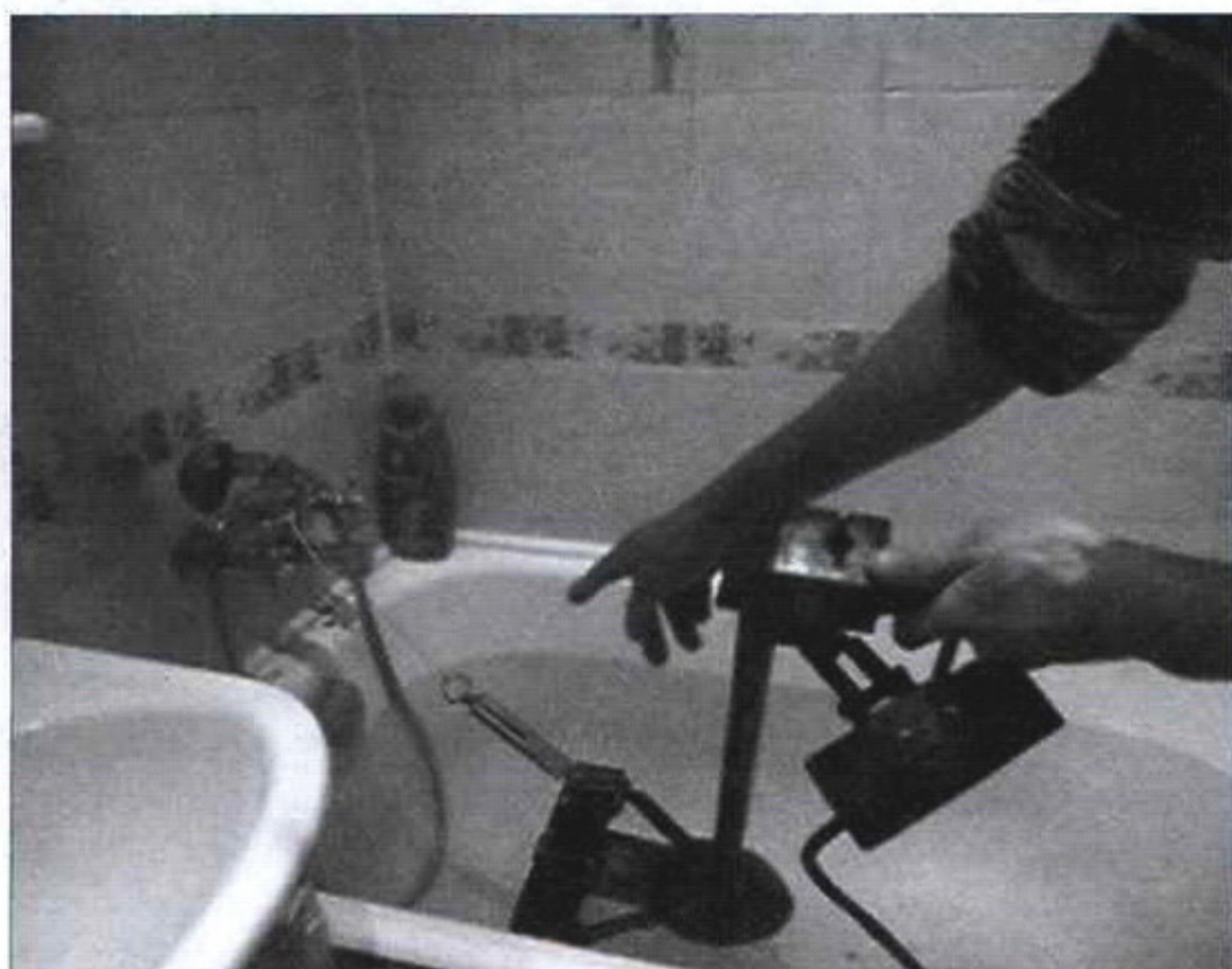
Установка подвешенного мотора в ванну с водой для проведения испытания на тяговое усилие
