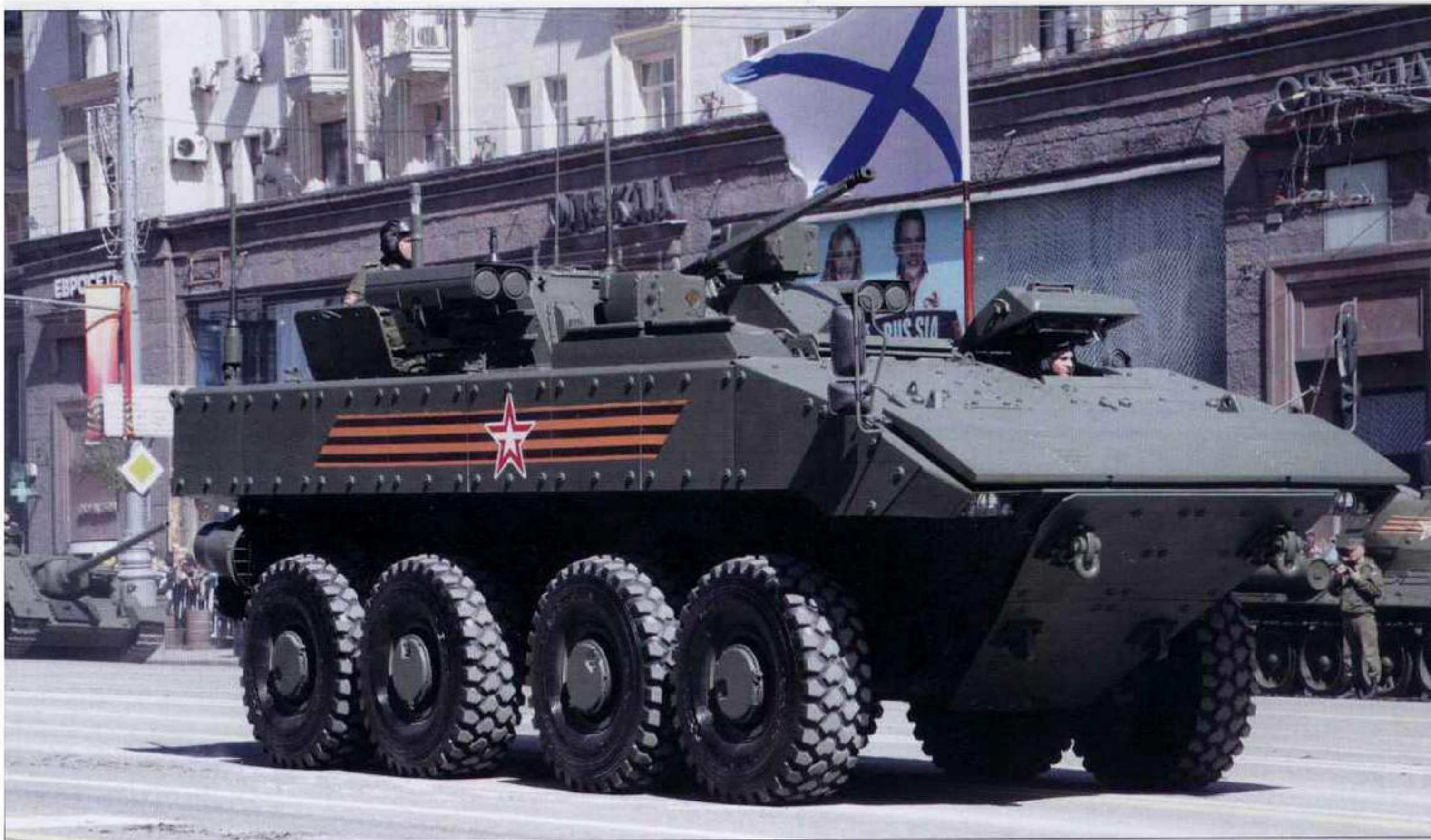
«Бумеранг» на Тверской улице перед генеральной репетицией парада. Москва, 7 мая 2015 года. Хорошо видны прицелы наводчика и командира, а также правое пусковое устройство ПТУР «Корнет»
