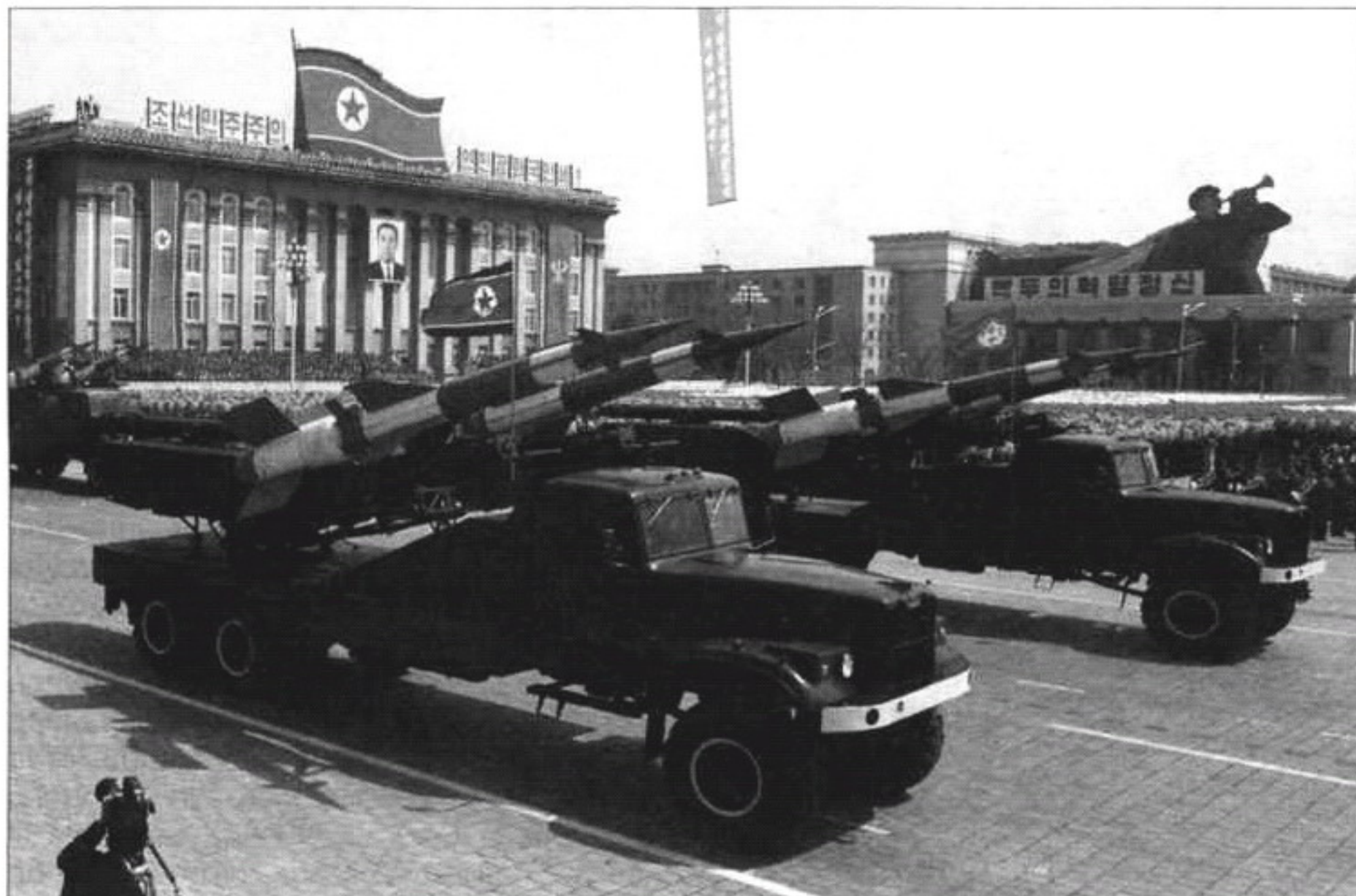
Северокорейская транспортно-пусковая установка зенитно-ракетной системы С-125 на шасси КрАЗ-256
