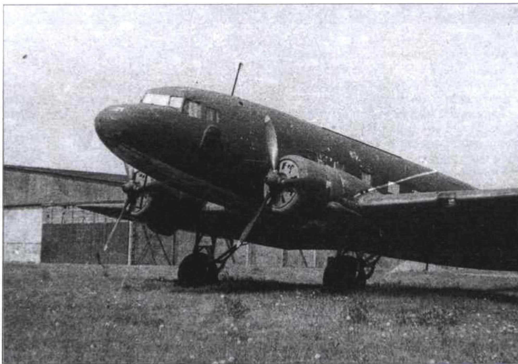
Серийный Ли-2НБ с открывающейся створкой запасной двери
