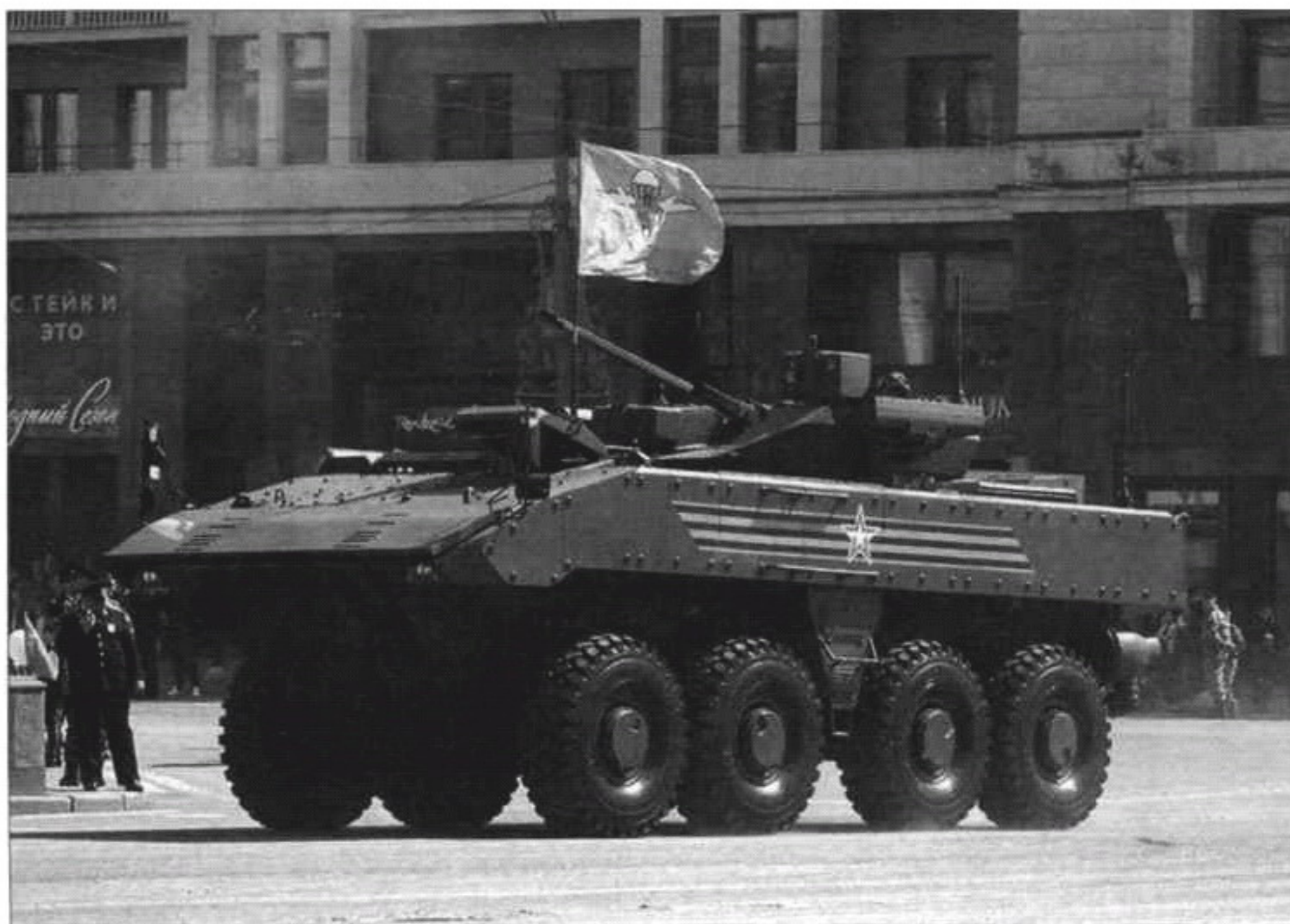
«Бумеранг» после репетиции. Хорошо видны дверь и откидная аппарель в кормовом листе корпуса
