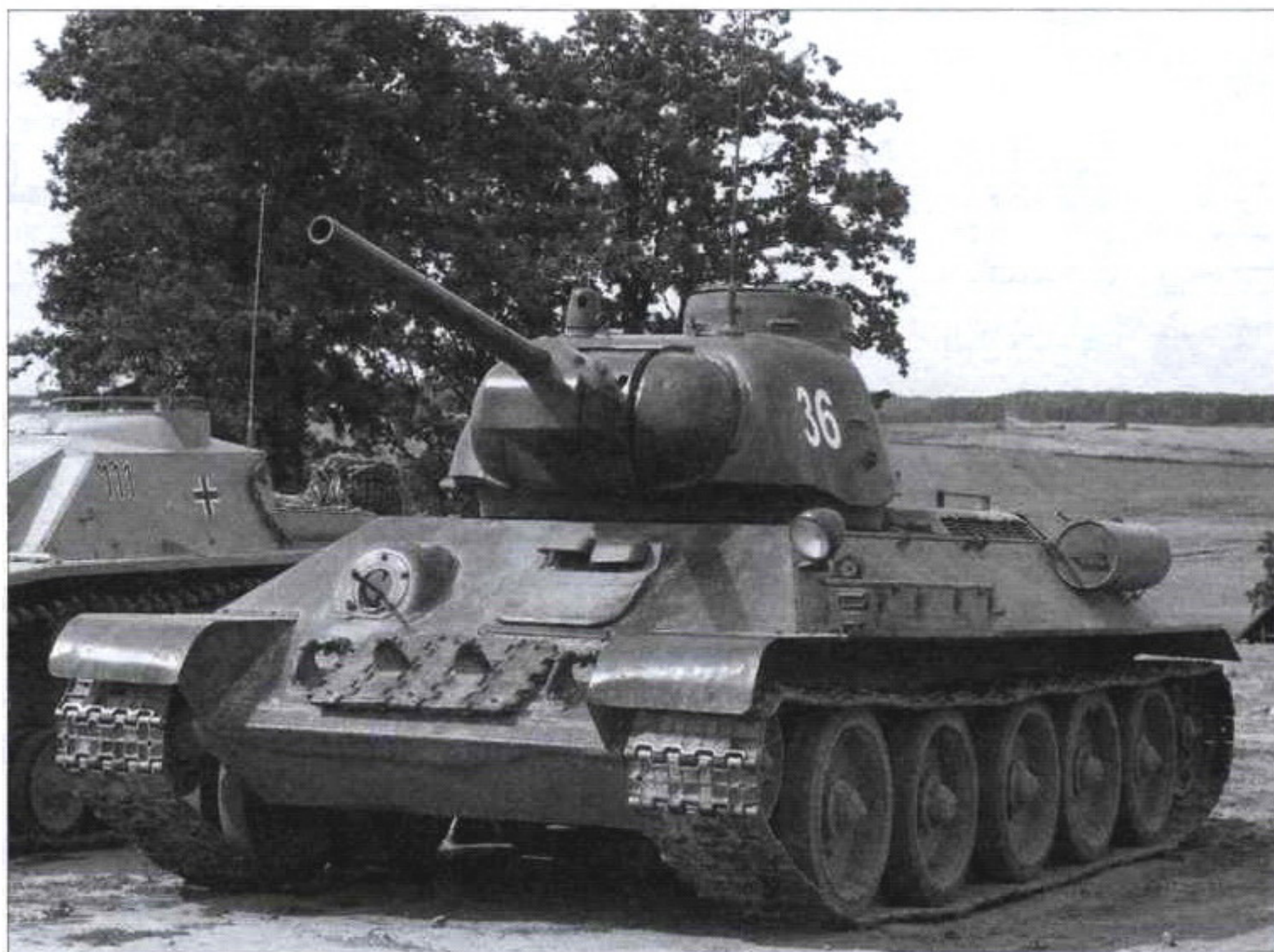
Танк Т-34-76 со штампованной башней, выпущенный Уральским заводом тяжелого машиностроения в 1943 году
