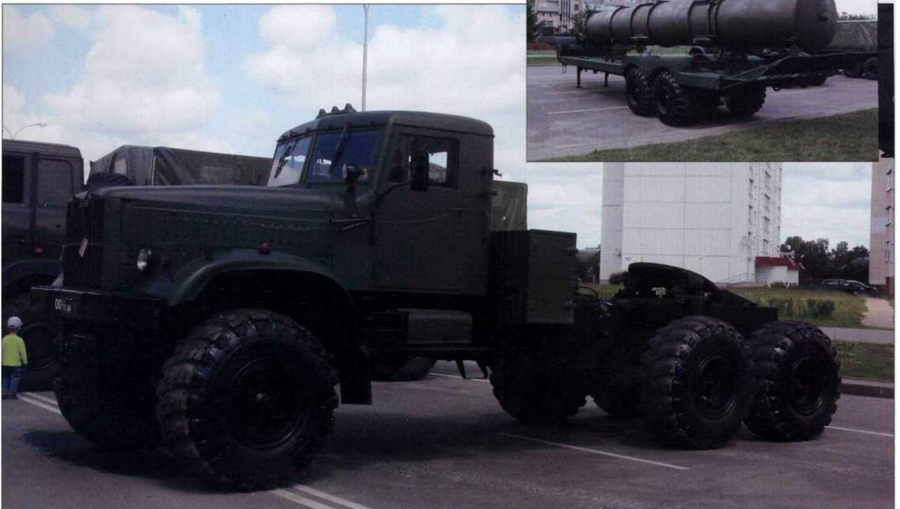
Машина 9Т82 для транспортировки зенитных ракет на базе седельного тягача КрАЗ-260В
