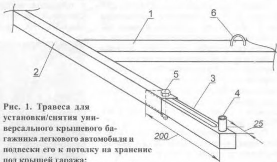
Универсальный багажник со штатными перекладинами на рейлингах автомобиля; траверса заведена для его снятия на хранение
