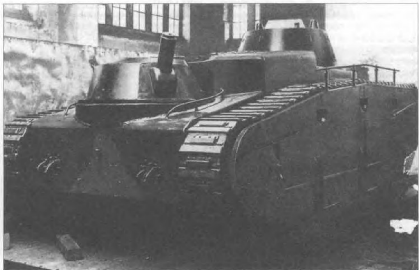
Корма гросстрактора «Даймлер». В кормовой башне в броневом кожухе установлен 7,92-мм пулемет MG
