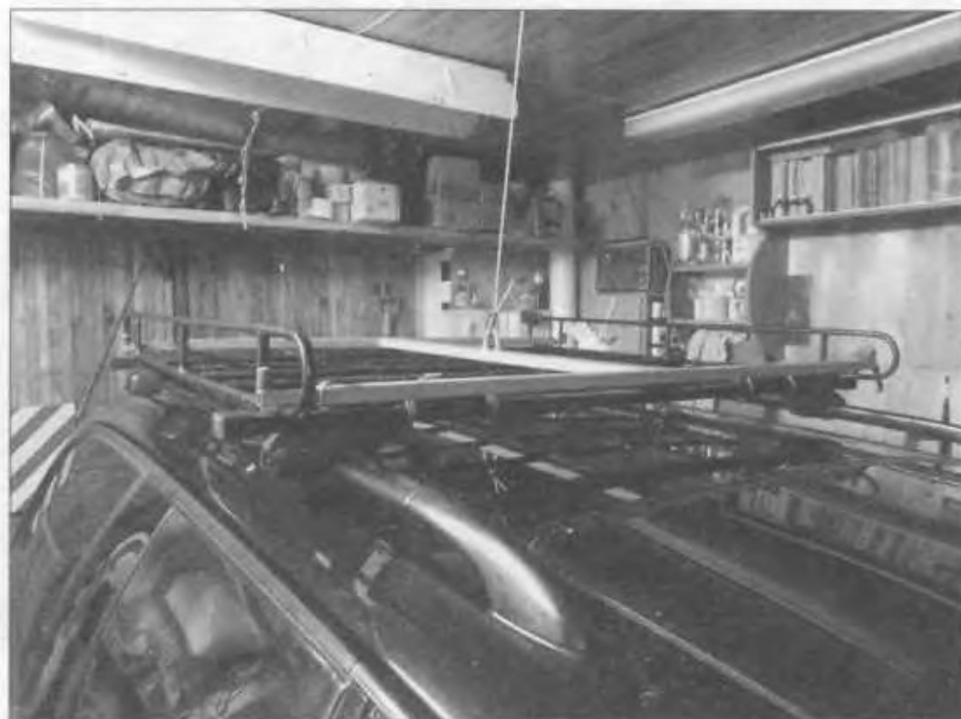
Универсальный багажник со штатными перекладинами на рейлингах автомобиля; траверса заведена для его снятия на хранение
