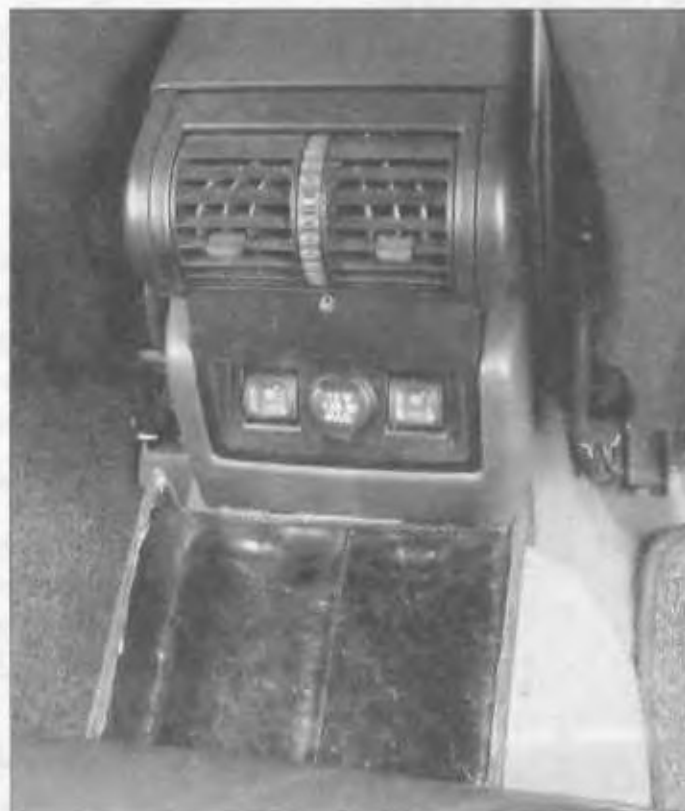
Приспособление, установленное на тоннель и выполняющее функцию полочки для полезных вещей
