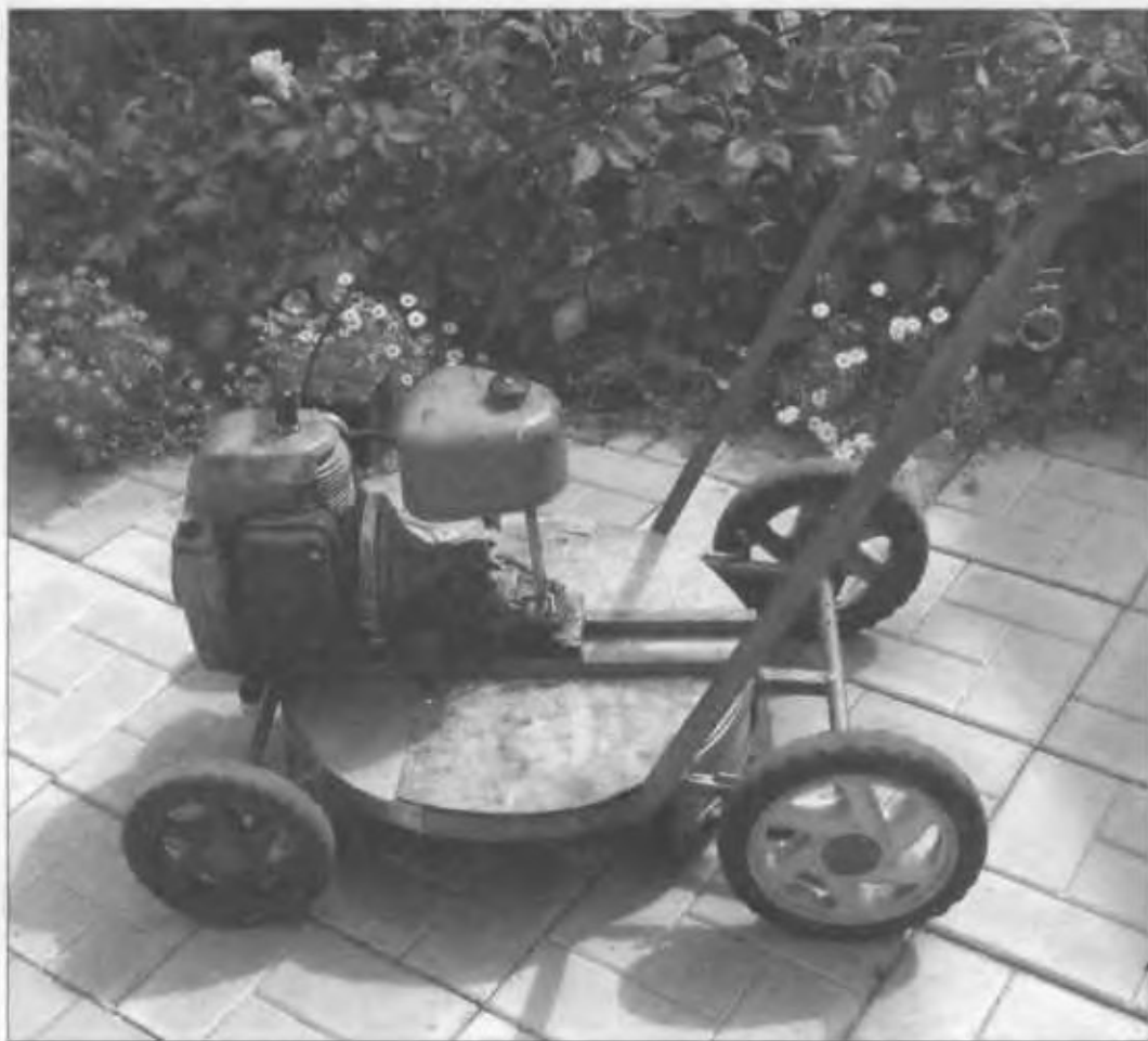
Вариант оборудования газонокосилки для скашивания в левую сторону
