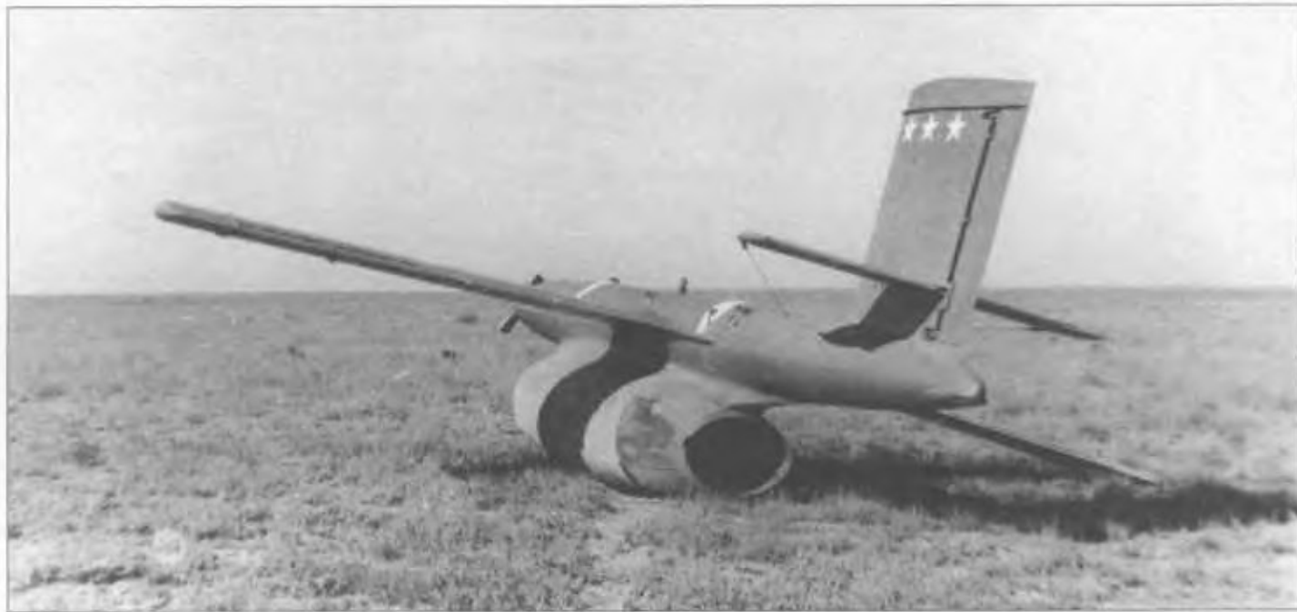
После посадки Ла-17 для повторного его использования приходилось заменять силовую установку
