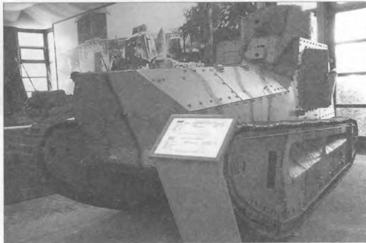
Легкий танк LK-II. Вооружение – 37-мм пушка, масса – 8,5 т, экипаж – 3 человека. Танковый музей в Мюнстере, Германия
