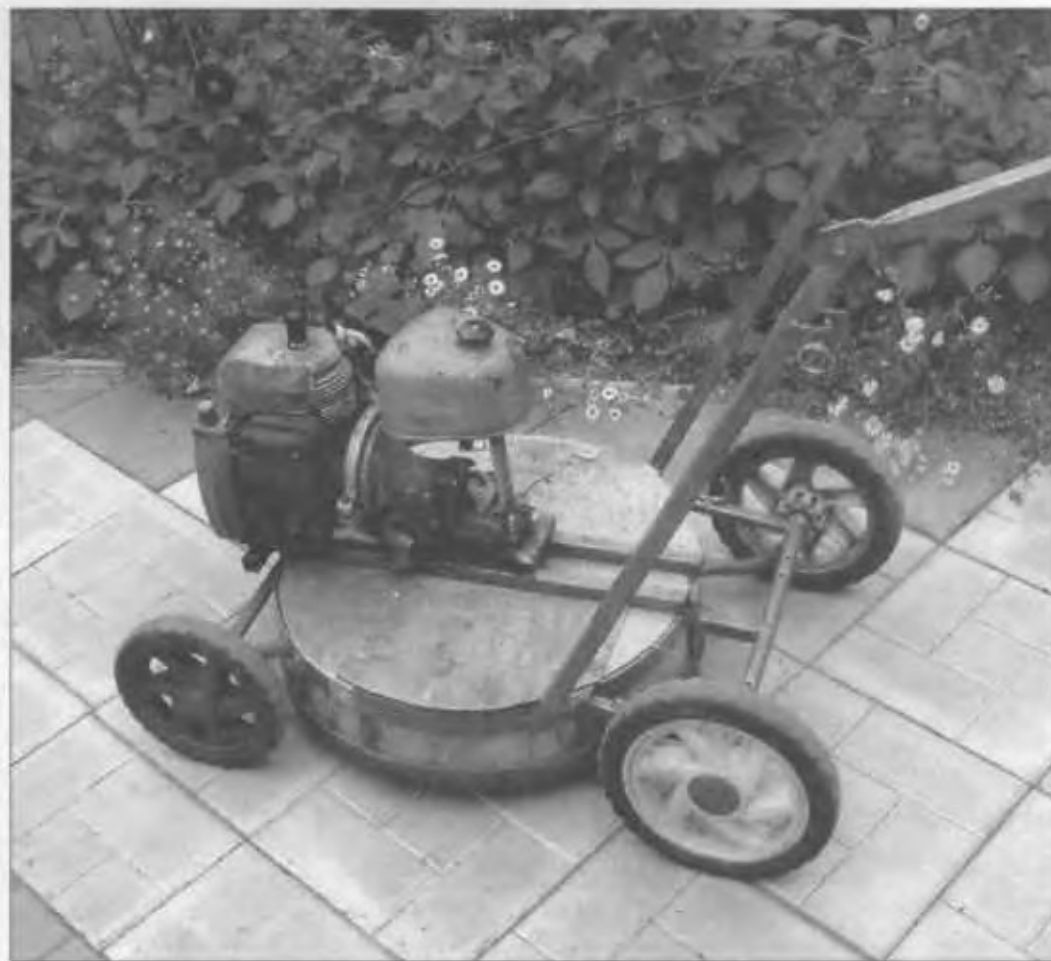
Оборудование газонокосилки в закрытом варианте, для мульчирования зеленой массы
