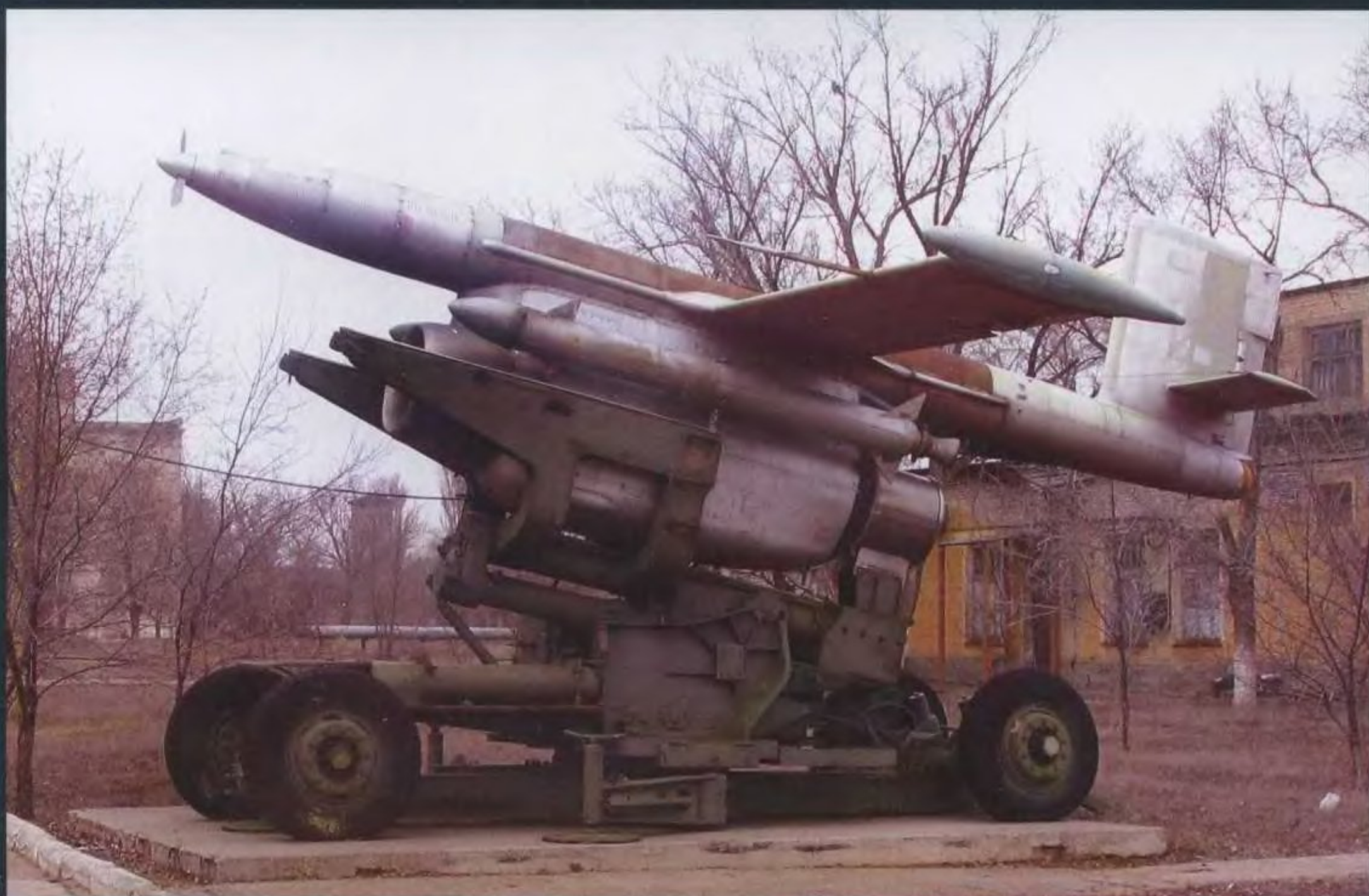
Дистанционно-пилотируемый разведчик Ла-17Р на транспортно-пусковой установке
