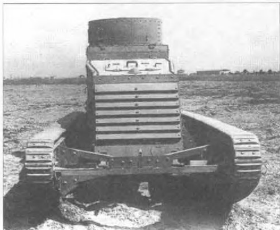
Опытный легкий танк LK-I с плоским радиатором и вертикально поставленными бортами корпуса. 1917 – 1918 гг.
