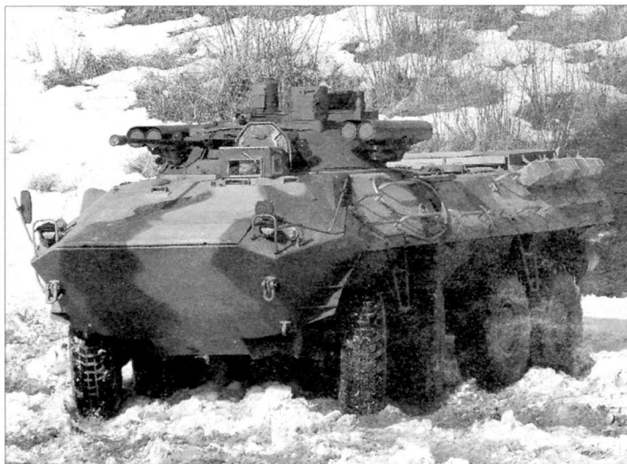
Спаренные ракетные пусковые установки размещены по бортам башни бронетранспортёра. Крышка люка механика-водителя поднята. На люк установлен защитный колпак (применяется при движении на марше и вне боевой обстановки)
