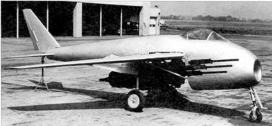
P.1101 в США. На самолёте смонтирован американский двигатель Аллисон J-35. На борту приклеены фанерные макеты 12,7 мм пулемётов. Зализ крыла отсутствует. Виден противоплаттерный груз на руле направления
