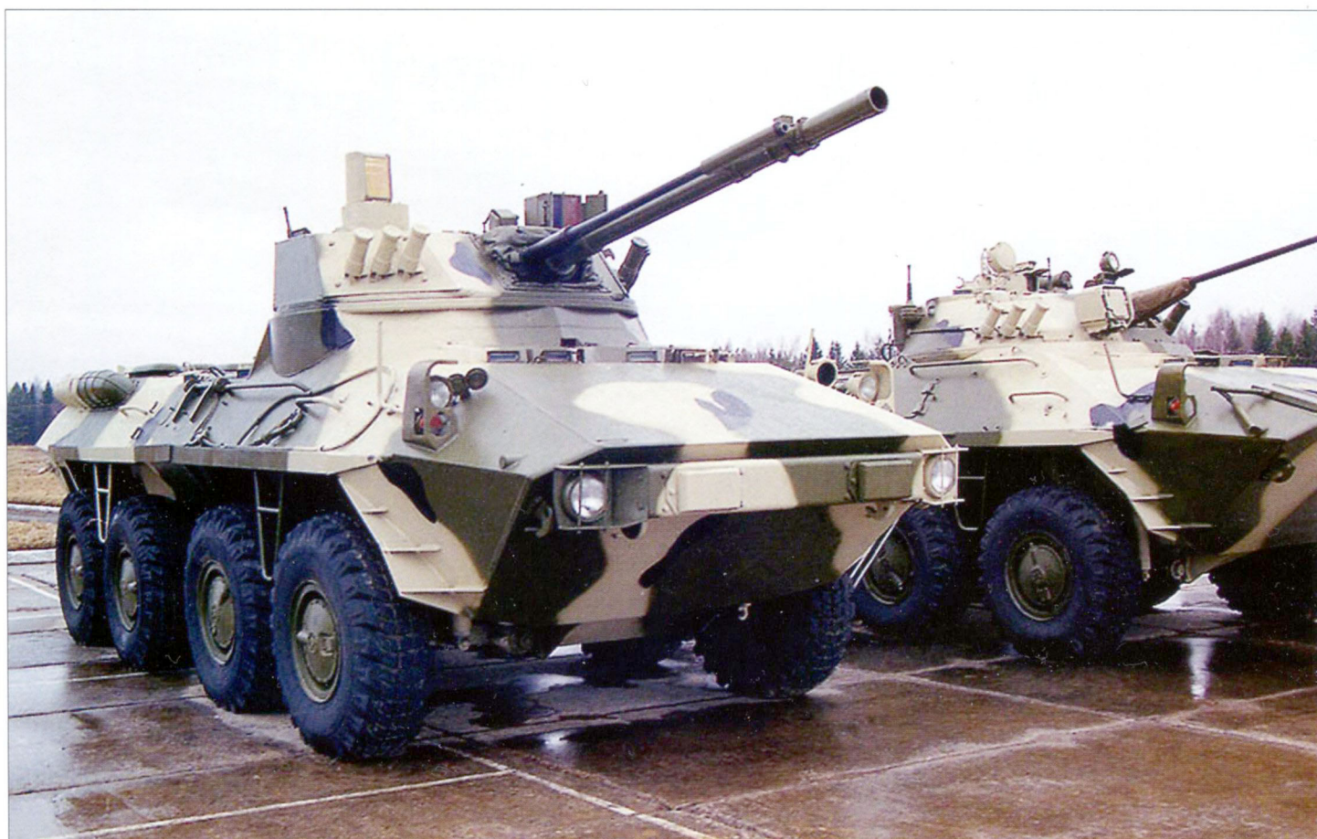
На переднем плане БТР-90М с боевым модулем «Бахча-У». За ним стоит БТР-90 с 30-мм пушкой 2А42
