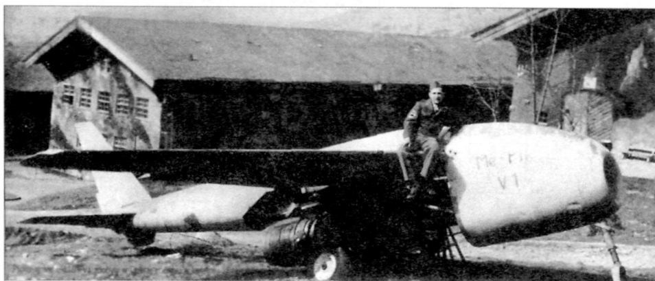
Прототип истребителя Me 3.1101 V1, добытый американцами в качестве трофея в Обераммергау в апреле 1945 г. Виден макет двигателя. Нижние панели фюзеляжа и створки основной стойки шасси сняты. Отсутствует фонарь кабины
