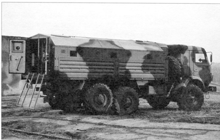
На военном КАМАЗ-5350 установлена бронированная кабина, защита топливных баков, картера двигателя, аккумуляторных батарей. В кузове размещён защищённый кунг-модуль. Защита обеспечена по 5-му классу ГОСТ Р
