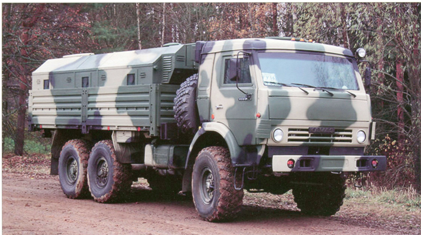
КАМАЗ-5350 с комплексом дополнительной защиты КДЗ, состоящим из бронированной кабины и защищённым многофункциональным модулем ММ-501
