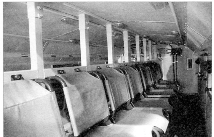
Модуль ММ-501 установлен на грузовой платформе автомобиля. В нём размещаются 14 солдат со всем личным снаряжением и оружием
