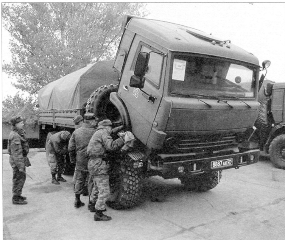
Шарнирные соединения на раме автомобиля позволяют опрокидывать кабину вперёд. Подъём её осуществляется гидроцилиндром усиленной мощности
