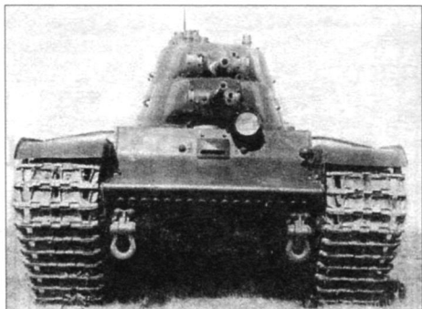
Танк Т-100. В малой передней башне установлена 45-мм пушка 20К. В задней главной башне — 76,2-мм пушка Л-10
