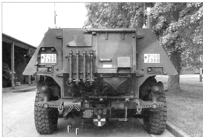
Корма TPz 1 «Фукс». В спонсорах по бортам видны два четырёхлопастных гребных винта, сообщающих машине скорость на воде до 10 км/ч. На задней стенке корпуса укреплен блок маркеров
