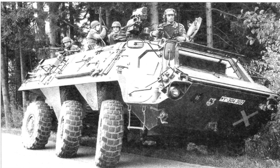
На бронетранспортёре возможна установка противотанкового ракетного комплекса «Милан». На фото: ракета находится на пусковой установке на крыше корпуса. Экипаж при этом возрос на два человека
