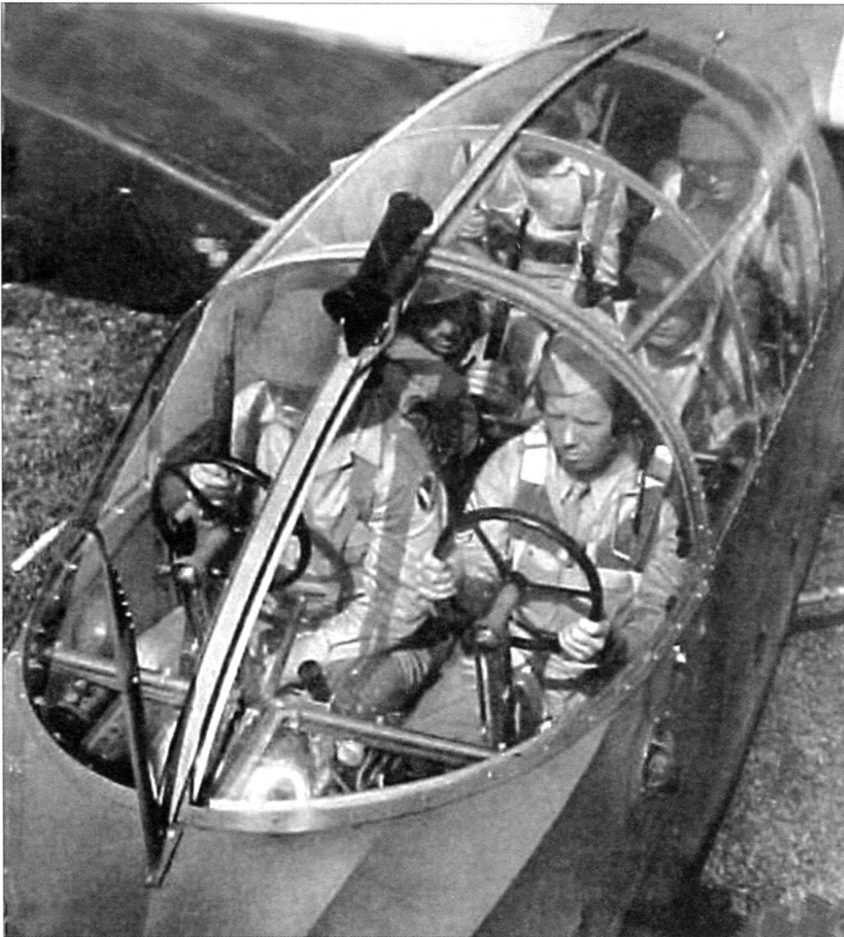
Опытный образец планёра CG-3. Под фонарём виден пилот в левом кресле и десантники. На десанниках – каски, а пилот – в пилотке. Он явно не собирается бегать по полю с винтовкой и отрабатывать приёмы наземного боя. Пилот имеет наушники, значит, на планёре установлена радиостанция. На левом борту виден воздухозаборник системы вентиляции. Перед козырьком фонаря на мачте – трубка ПВД, а на вершине козырька – трубка Вентури. Ещё одна такая же трубка установлена на правом борту
