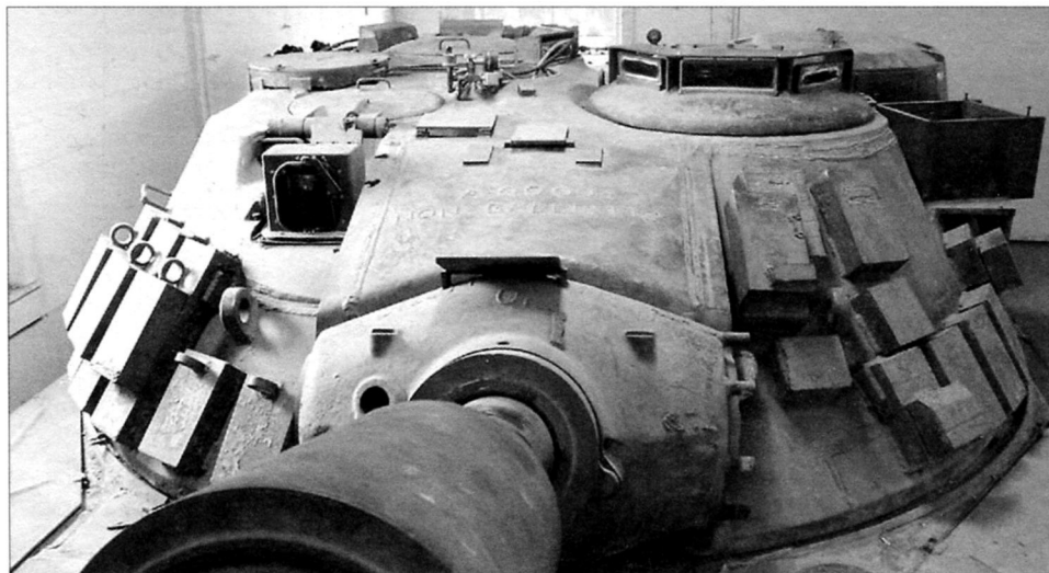
Башня танка с блоками накладной динамической защиты. Слева у маски пушки – окно прицела-дальномера наводчика, справа вверху на башне – блок призматических приборов механика-водителя
