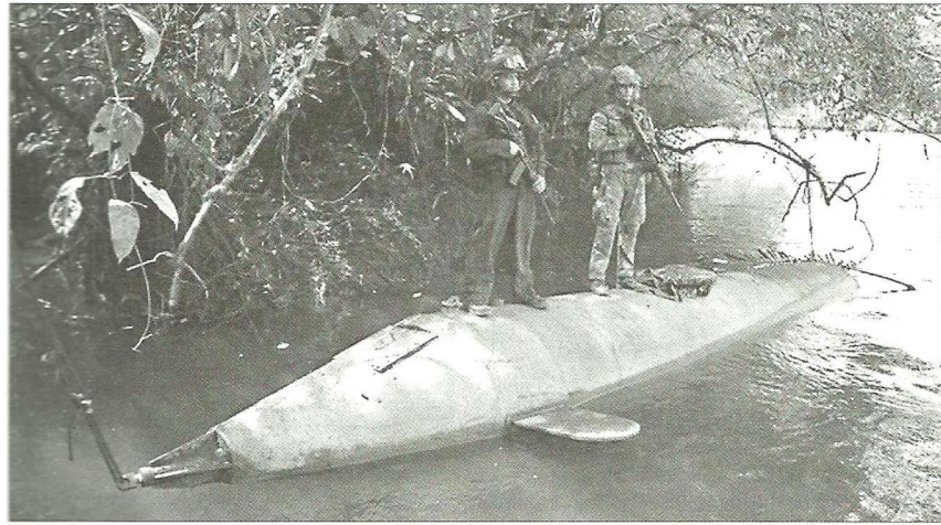
Беспилотная наркоторпеда, конфискованная полицией в районе порта Бунавентура (Колумбия) на побережье Тихого океана. Длина 7,5 м, ширина 1,5 м. Наполненную кокаином торпеду щепляли к судну. В случае опасности она погружалась под воду. Это осложняло обнаружение нелегального груза
