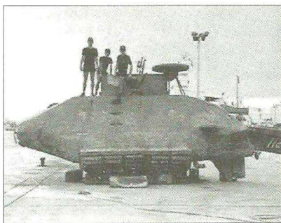
Стеклопластиковая лодка, захваченная полицией в 1994 г. на побережье национального парка Тайрона (Колумбия). Лодка не имела балластных цистерн и была построена с отрицательной плавучестью, удержание глубины и всплытие осуществлялись отдачи свинцовых грузиков, комплект которых крепился в днищевой части
