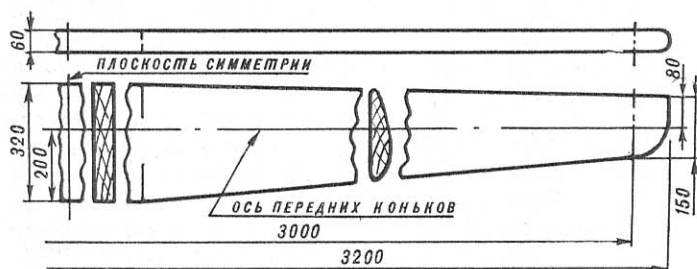
Поперечная балка буера.
