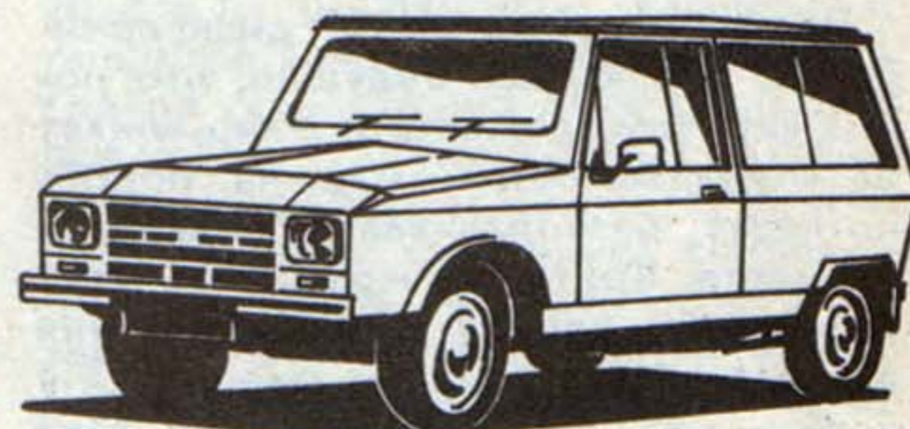
Р и с. 4. «Ситроен» FAF (1978 г., двигатель 602 см 3 , 29 л. с., 100 км/ч).
