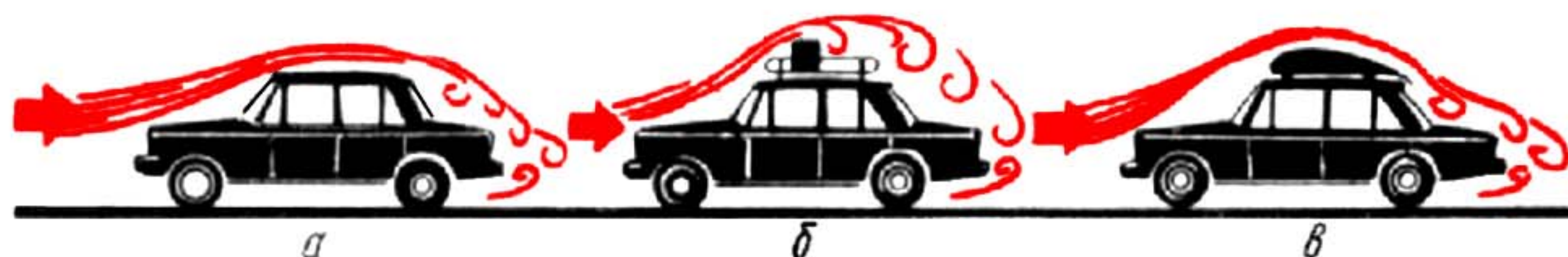
Схема обтекания автомобиля воздушным потоком: а — без груза, б — с грузом на обычном багажнике, в — с аэродинамическим багажником.
