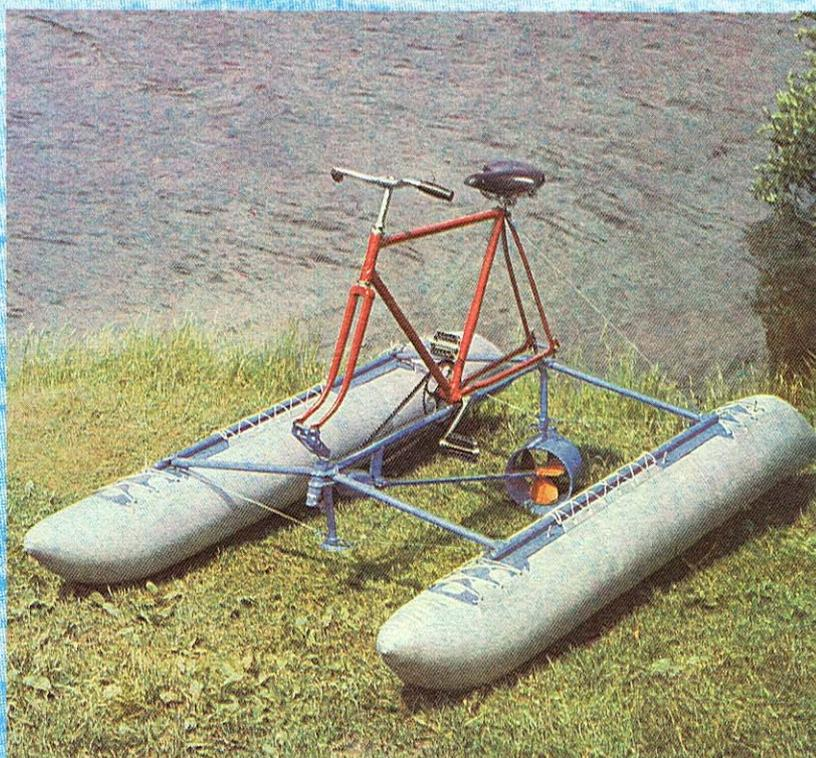
Достоинство конструкции, разработанной горьковчанином А. Сафроновым, — возможность использовать ее и в качестве сухопутного транспорта, и в качестве водного. А весь секрет в том, что к обычному велосипеду изготовлена своеобразная приставка — поплавок-катамаран. В сложенном виде он представляет собой компактный пакет и легко размещается на том же велосипеде, а на сборку амфипеда уходит всего несколько минут.
