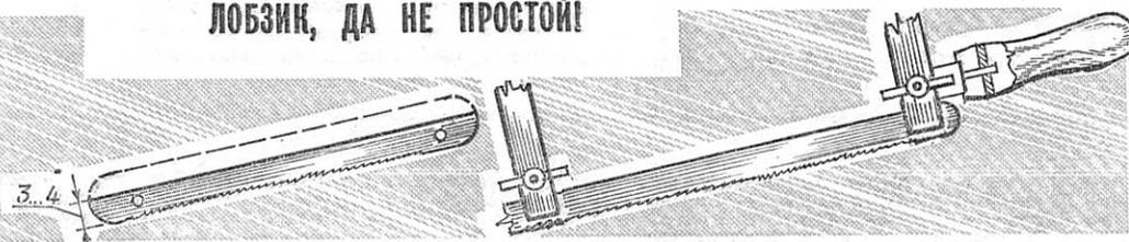
Намучившись с обычными пилами для лобзика, решил попробовать самодельный вариант — из проволоки, нанеся на ее поверхность зубильцем неглубокие риски. Такая пила и идет точно по намеченной линии, и служит долго. А если затупилась — долго ли нанести новые зазубринки. Кроме того, и работать стало удобнее: направление пропила меняется не поворотом инструмента, а изменением приложения усилия.
