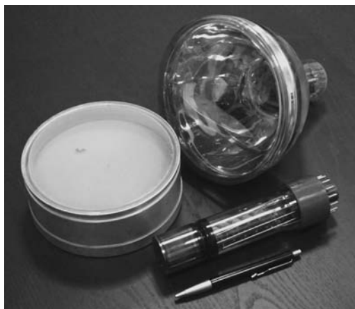
Рис. 2.13 Детали сцинтилляцион- ного детектора \gamma -излучения:
