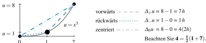
Abb. 1.1 \Delta_+/h, \Delta_-/h und \Delta_0/2h approximieren u' = 3x^2 = 3 an der Stelle x = 1 durch 7, 1, 4. Die zweite Differenz \Delta^2 u = 8 - 2(1) + 0 ist exakt gleich u'' = 6x = 6 mit der Schrittweite h = 1 .
