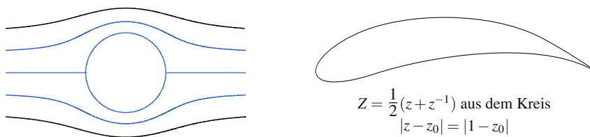
Abb. 3.18 Stromlinien Y = y - \frac{y}{x^2 + y^2} = c . Tragflächenprofil aus einem Kreis, der nicht im Ursprung liegt.
