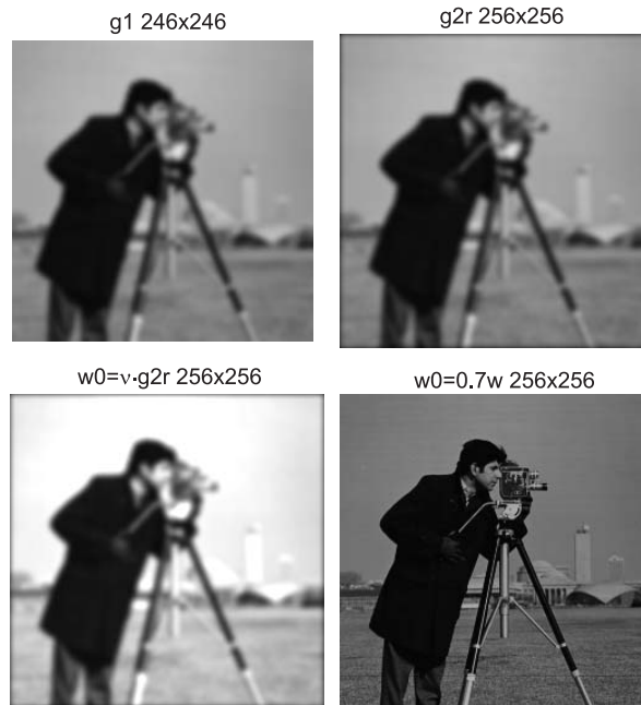
Рис. 2.69. Серое изображение cameraman.tif , g1 — дефокусированное изображение с усечением согласно (2.70), g2r — дефокусированное изображение с размытием краев согласно (2.71) и с вырезкой до размера 256 \times 256 , w0 = \nu \cdot g2r — начальное приближение w_0 = \nu \cdot g2r , w0 = 0.7w — начальное приближение w_0 = 0.7\bar{w}
