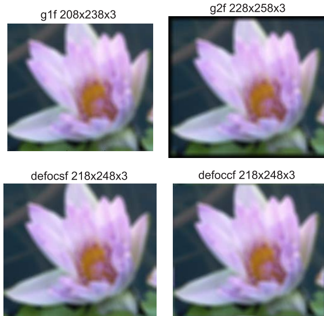
Рис. 2.65. Результат фильтрации импульсного шума на изображениях g_1 , g_2 , defocs и defoccf (см. рис. 2.60) с помощью функции medfilt2c.m
