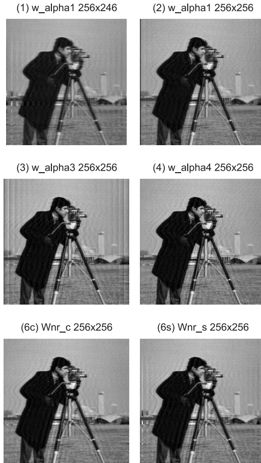
Рис. 2.33. Реконструкция смазанного и зашумленного 1%-ным гауссовым шумом изображения без использования m -функции wiener2 при \alpha = \alpha_{\text{opt}} (варианты 1–4) и K = K_{\text{opt}} (варианты 6с и 6s)
