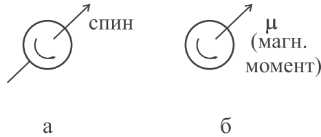
Рис. 1.19. Механический момент, или спин электрона (а) и магнитный момент электрона \mu (б)
