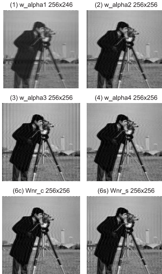
Рис. 2.38. Реконструкция смазанного и зашумленного импульсным шумом изображения с использованием m -функции medfilt2 при \alpha = \alpha_{\text{opt}} (варианты 1–4) и K = K_{\text{opt}} (варианты 6с и 6s)
