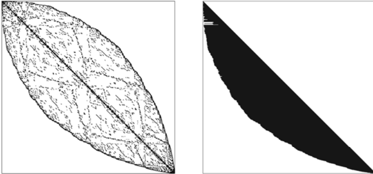
Abb. 7.3. Umgekehrte Cuthill–McKee-Ordnung: Besetzungsstruktur der umgeordneten Matrix A_{5000} (links) und ihres Cholesky-Faktors L (rechts).
