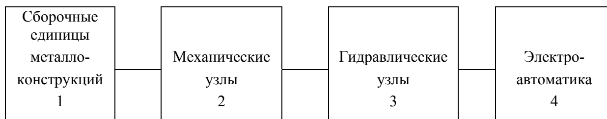
Рис. 7.7. Структурная схема надежности изделия
