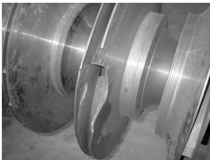
Рис. 3.3. Фото полотна диска разрушившегося после образования усталостных трещин
