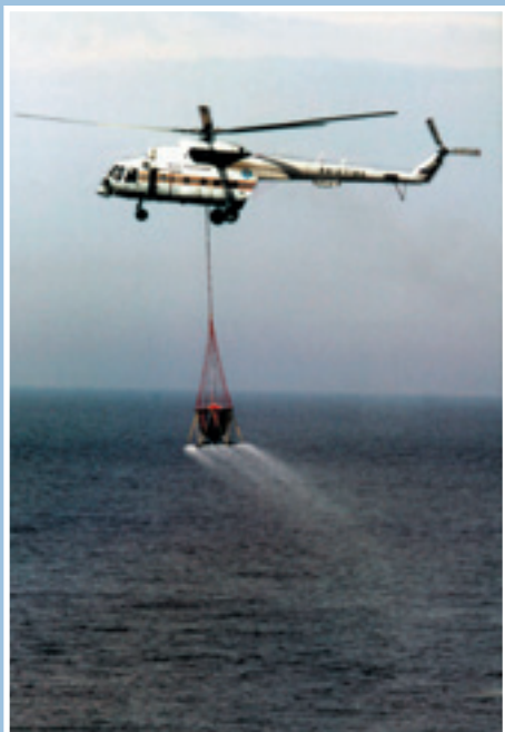
Ми-8 с ВОП-3 (распыление диспергентов при разливе нефти)
