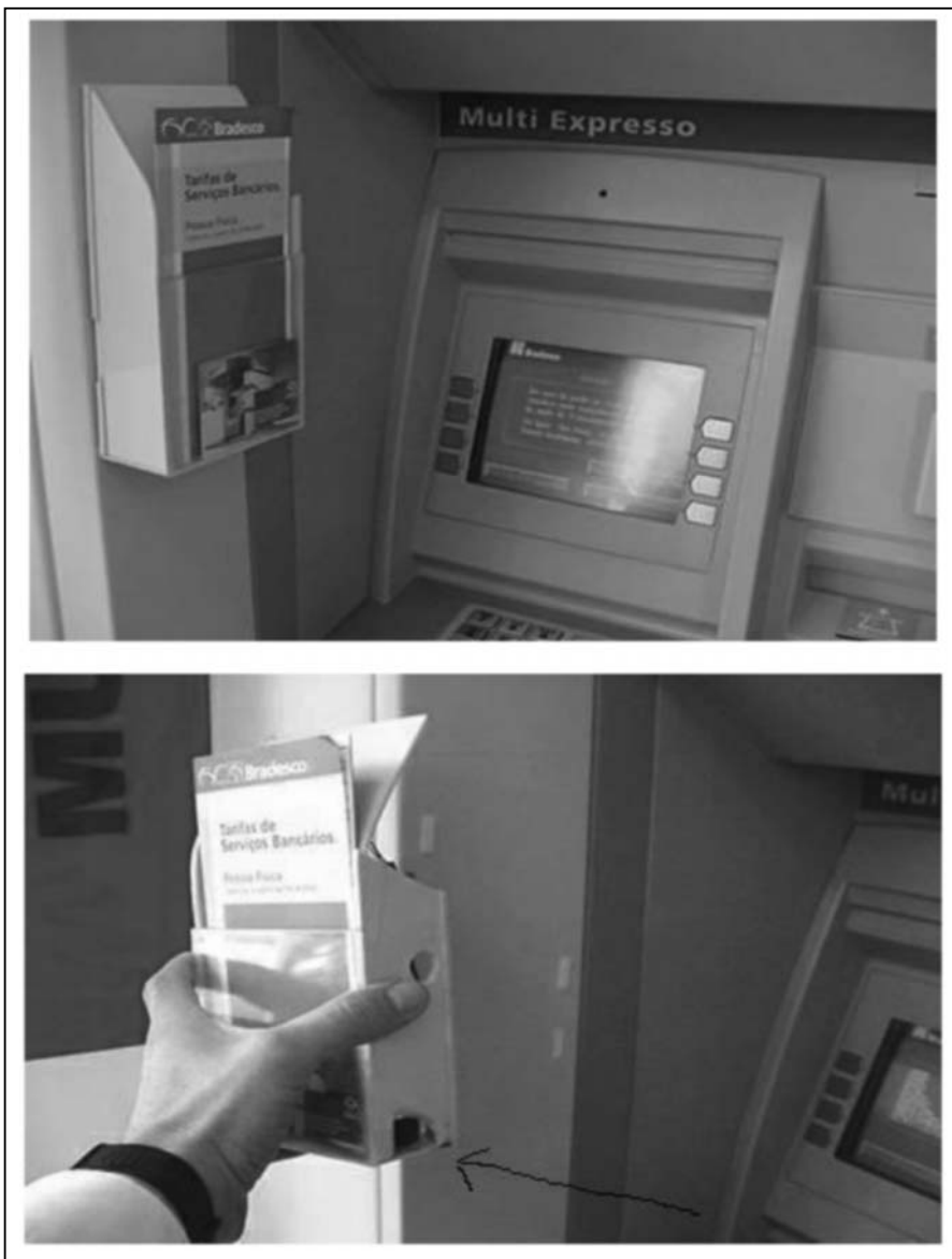
Видеокамера, осуществляющая снятие вводимого клиентами пин-кода, замаскированная под лоток с рекламой [95]
