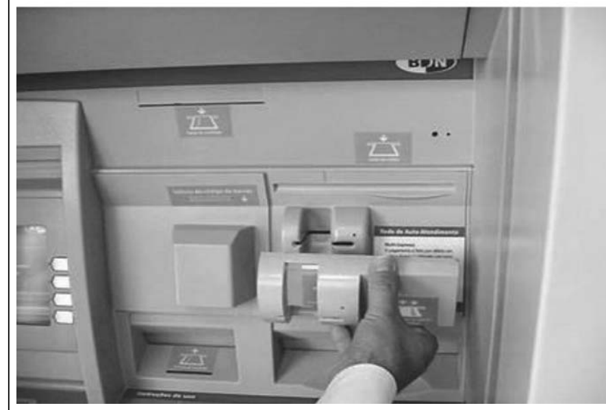
Приставка к банкомату, замаскированная под конструктивную часть и осуществляющая скрытое копирование магнитной полосы карты
