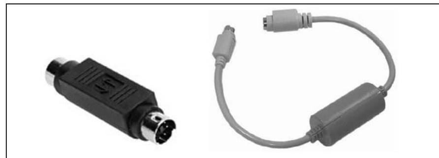
Аппаратные кейлогеры. Вставляются в разрыв между клавиатурой и системным блоком. Не могут быть детектированы программным способом, зато легко обнаруживаются визуально
