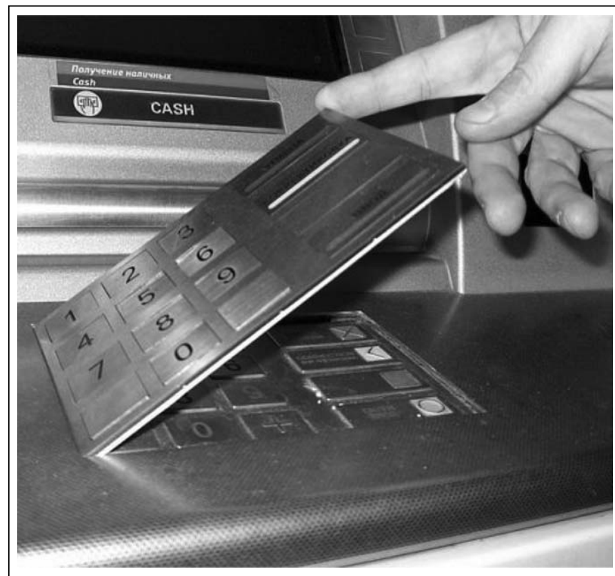
Накладка на клавиатуру банкомата, снимающая вводимый пин-код [97]
