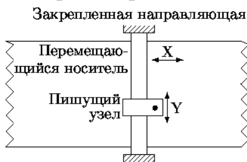
Рисунок 8.9 Устройство плоттеров с перемещающимся носителем.
