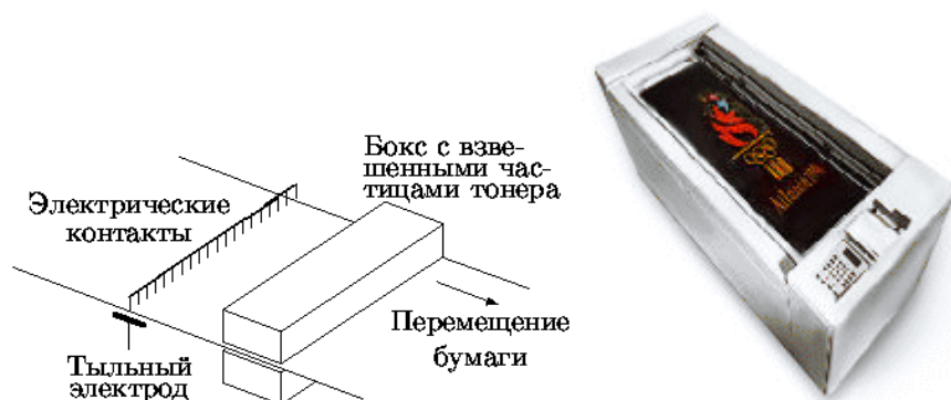
Рисунок 8.11 Электростатический плоттер, устройство и внешний вид.
