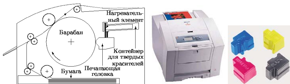
Рисунок 8.5 Твердочернильный принтер, принцип действия, внешний вид
