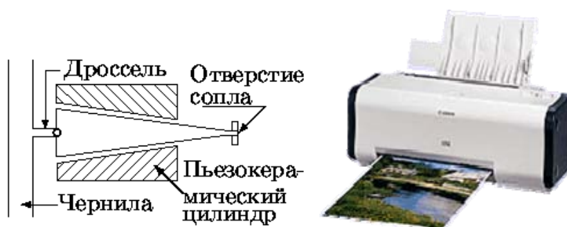
Рисунок 8.4 Струйный принтер, принцип действия и внешний вид
