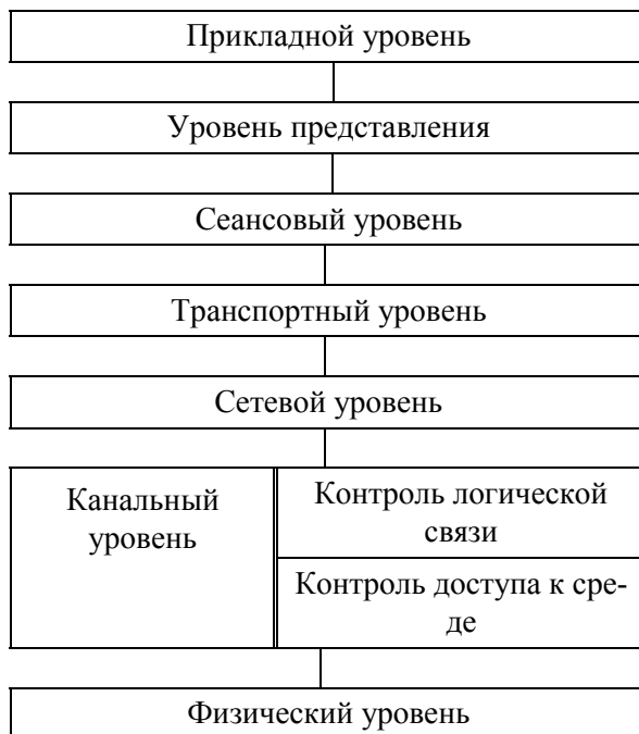
Рис. 4.6. Стек протоколов OSI
