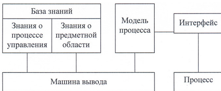
Рис. 10.6. Архитектура экспертной системы реального времени
