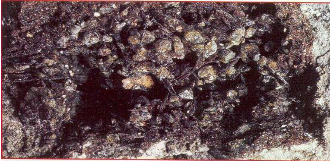
Рисунок А. 3 - Оливин (перидот). Формула: (\text{Mg}, \text{Fe})_2\text{SiO}_4 . Формы кристаллизации: неправильные призмы. Цвет: зеленый, желтый, коричневый, серый. Твердость: 6,5-7. Излом: раковистый. Блеск: стеклянный, жирный
