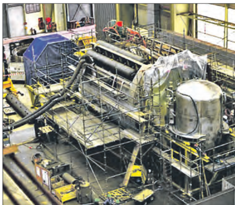
Монтаж модуля (слева) с парогазовой турбиной замкнутого цикла и блок корпуса НАПЛ проекта «Агоста»
