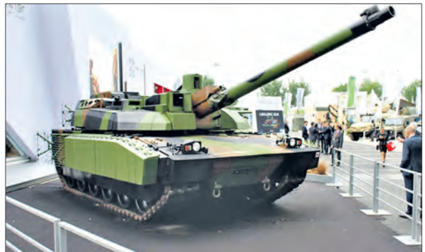
Основной боевой танк «Леклерк» СВ Франции. Вооружен 120-мм гладкоствольной пушкой (длина ствола 52 клб) с автоматом заряжания
