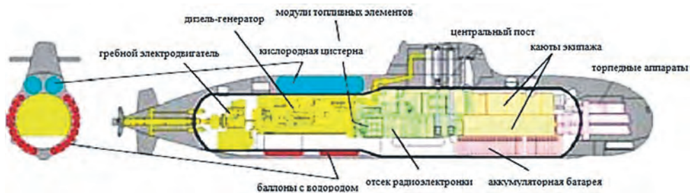
Расположение элементов ВНЭУ с ЭХГ НАПЛ проекта 212А
