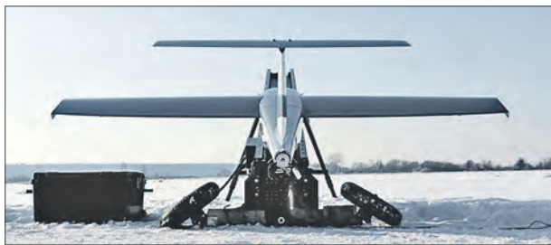
Запуск БПЛА «Гладиус» с подвижной катапульты
