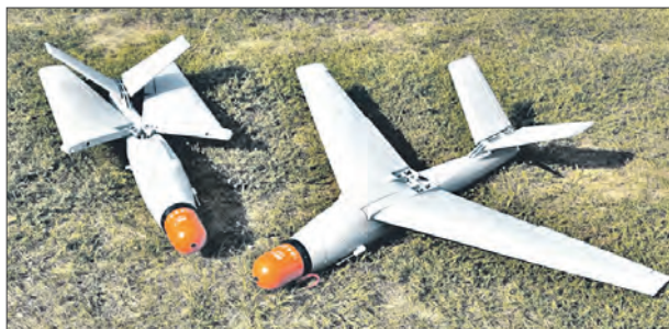
Барражирующий боеприпас на платформе БПЛА «Вармате» со сложенными и разложенными крыльями
