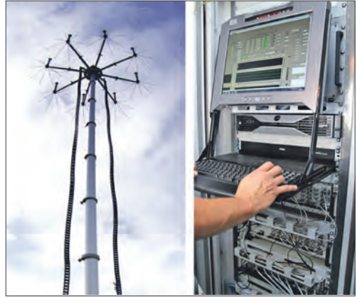
Элементы итальянской ПРЛС «Аулос»: антенна на телескопической мачте (слева) и рабочее место оператора станции (справа)
