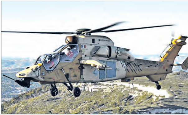
Ударный вертолет ЕС-665 «Тигр» армейской авиации с тандемным расположением экипажа. Машина создана совместным франко-германским предприятием «Еврокоптер»
