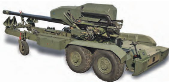
155-мм буксируемая гаубица «Бхарат-45» с длиной ствола 45 калибров
