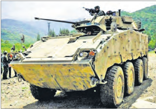
БМП CM-34, оснащенная 30-мм пушкой Mk44 «Бушмастер-2» и 7,62-мм пулеметом
