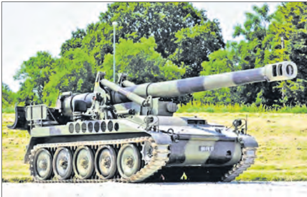
Американская 203-мм самоходная гаубица M110A2 (боевая масса 28,5 т), состоящая на вооружении артиллерийских подразделений Тайваня
