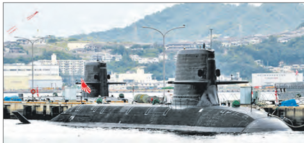
Японская подводная лодка типа «Сорю» с ВНЭУ на основе двигателя Стирлинга
