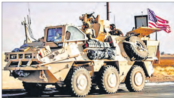
Разведывательная машина AGMS, созданная на основе ББМ «Пандур» австрийского производства. Ее первое боевое применение состоялось во время вторжения ВС США в Ирак в 2003 году
