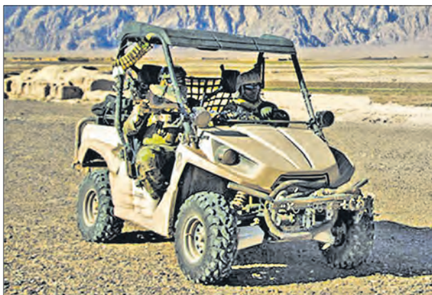
Сверхлегкое двухместное транспортное средство «Кawasaki Тирекс-750». На грузовой платформе в кормовой части можно перевозить до 230 кг имущества и оборудования
