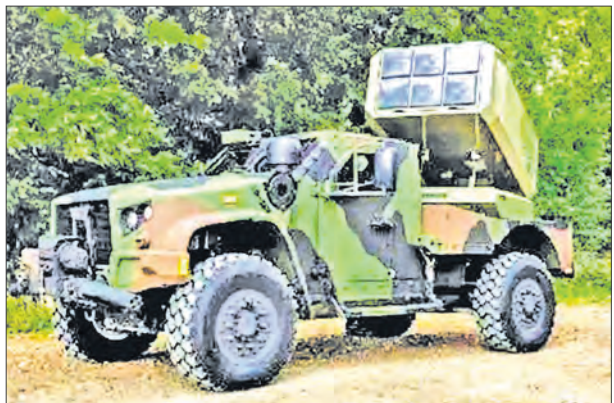
Опытная пусковая установка MCL на шасси JLTV, разрабатывается в рамках программы OPF-M
