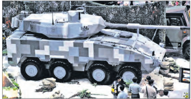
БТР СМ-32 «Юньпао»: с 40-мм автоматическим гранатометом (АГ) (вверху), модификация в комплектации БМПТ, оснащенная 105-мм пушкой (внизу)
