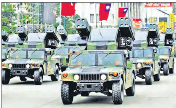
Мобильный ЗРК «Авенджер» на базе американского тактического автомобиля «Хамви»
