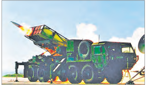
Основные типы РСЗО СВ Тайваня: «Гунфэн-6» (вверху); РСЗО «Лэйтин-2000» с заменяемыми пусковыми контейнерами (внизу)
