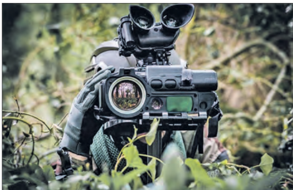
Охлаждаемый тепловизионный прибор Sophie-XF производства французской компании «Талес»
