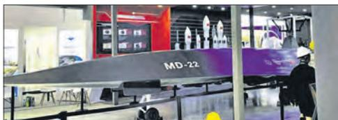
В его разработке приняли участие лаборатория высокотемпературной газодинамики Института механики и Гуандунская академия аэрокосмических исследований. Предполагается, что он сможет развивать скорость до  $M=7$  (8 575 км/ч). Длина БПЛА 10,8 м, размах крыла 4,5 м, высота (без шасси) 1,6 м, максимальная взлетная масса 4 000 кг (пустого – 1 000 кг). Заявлено, что гиперзвуковой аппарат сможет выполнять полеты на дальность до 8 тыс. км.
