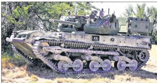
*Прототип безэкипажной БРМ RCV-M*
