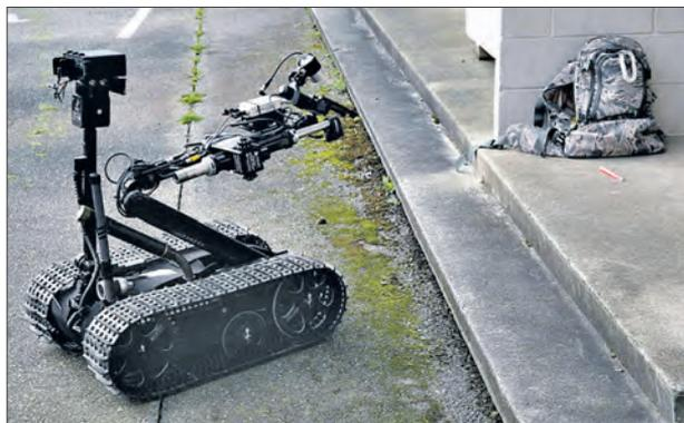
*Обследование подозрительных предметов с помощью дистанционно управляемого аппарата*
