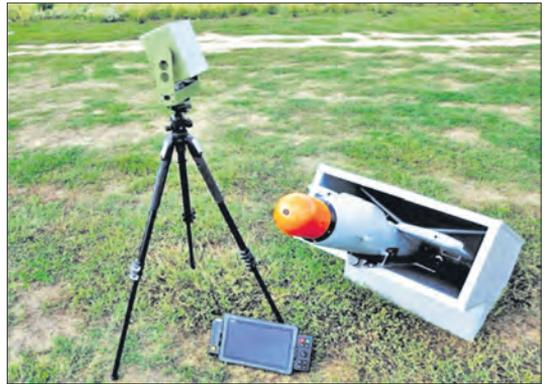
*Разведывательно-ударный беспилотный комплекс «Уормейт» (радиус действия БПЛА 10 км, продолжительность барражирования 30 мин)*
