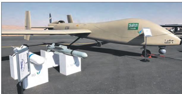
**Опытный образец разведывательного БПЛА класса MALE «Сакер-1Б»**
