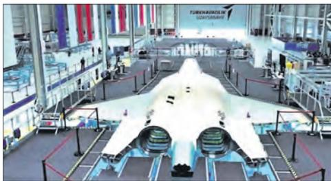
Experimental). Планируется завершить ее в марте 2023 года, отправить в первый полет в 2025-м и приступить к серийному производству в 2028-м. Сборка ведется на мощностях компании «Тёркиш азроспейс индастриз» при содействии 100 специалистов британской компании «БАэ системз».
