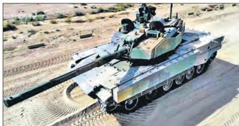
105-мм нарезной пушкой с автоматом заряжания. На нем установлены несколько систем видеонаблюдения, в том числе три камеры в передней части корпуса, одна – в задней и четыре – на башне. Максимальная дальность стрельбы VT5U 3 км.
