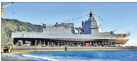
Polivalente d'Altura). Пятый корабль из семи заказанных спустили на воду в ноябре 2022 года. Полное водоизмещение нового корабля составит 6 270 т (у первых трех PPA водоизмещение не превышало 4 900 т), длина корпуса 143 м, ширина 16,5 м, скорость 31 уз, дальность плавания 5 тыс. морских миль. Экипаж 173 человека.
