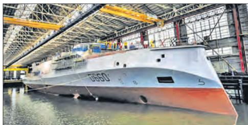
заказанных корабля планируется ввести в строй до 2030 года. Они заменят фрегаты типа «Лафайет», поступившие на вооружение в период с 1996 по 2001 год. Длина фрегата FDI 122 м, ширина 18 м, водоизмещение 4 500 т, скорость хода 27 уз, дальность плавания 5 000 миль, автономность 45 сут, экипаж 125 человек.
