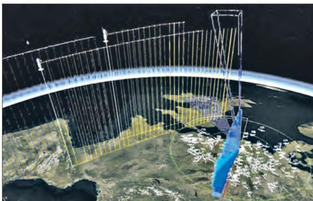
*Компьютерное изображение траекторий движения космических аппаратов системы спутниковой связи «Иридиум» и сопровождения одного из них станцией SMART-L MM/N*
