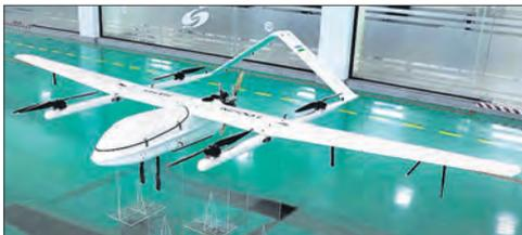
сообщили в пресс-службе Госкомитета по оборонной промышленности. Отмечается, что при комитете создан Научно-производственный центр беспилотных авиационных комплексов. БПЛА «Лочин» самолетно-вертолетного типа предназначен для ведения разведки, наблюдения и управления артиллерийским огнем.
