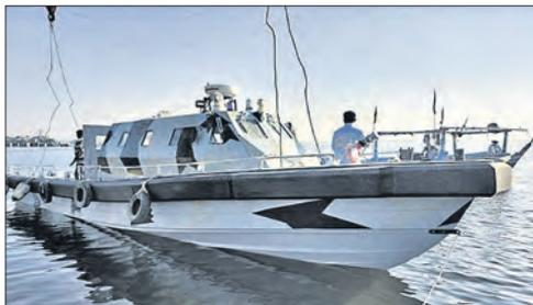
«Бахриа боут билдинг ярд» занимается выпуском катеров с водометными двигателями. Новое судно оснащено двумя внутренними водометными двигателями новозеландской компании «Гамилтон» с двигателями американской фирмы «Камминз». Оно может развивать скорость до 42 уз.
