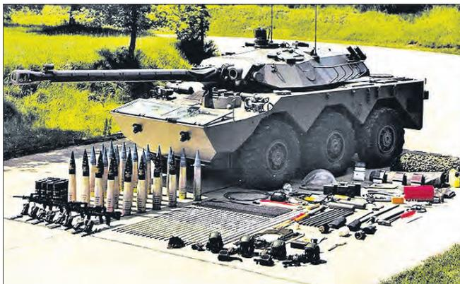
**Вооружение БМТВ AMX-10RC включает 105-мм пушку и спаренный с ней 7,62-мм пулемет**
