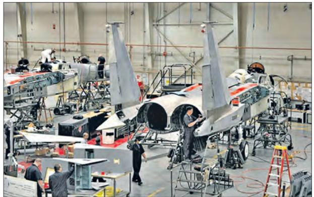
*Компания «Аль-Салим эрспейс индастриз» привлечена к модернизации истребителя F-15S до уровня F-15SA для изготовления несущих плоскостей, передней части фюзеляжа и пилонов*
