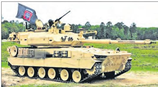
*Предсерийный образец легкого танка MPF со 105-мм пушкой XM35*
